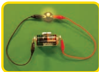
شکل ۵- مدار الکتریکی ساده
