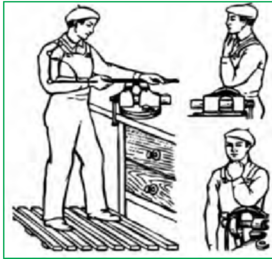
شکل ۱۶-۵. روش صحیح ایستادن و ارتفاع مناسب گیره
