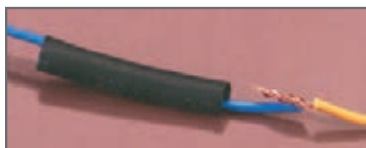
شکل ۲۲- عایق کاری اتصال
