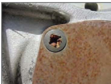
ب) استفاده ناصحیح از آچار پیچ گوشتی
