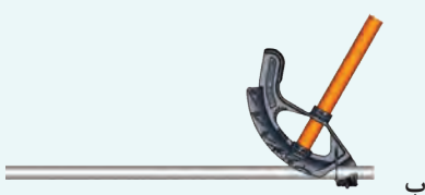
شکل ۴۰- خم انحرافی با لوله خم کن دستی
