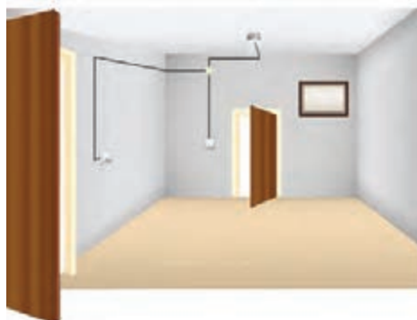
شکل ۱۹- کاربرد مدار تبدیل
