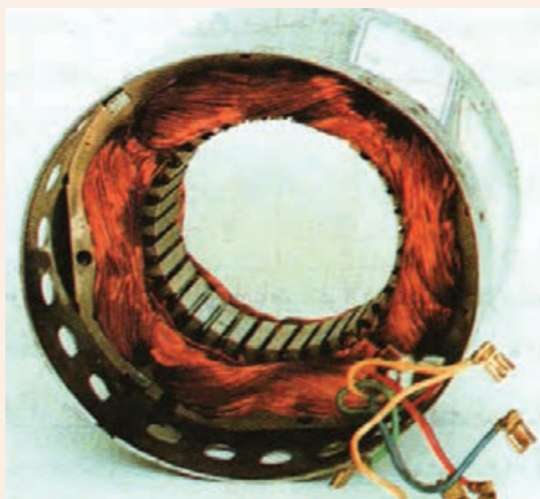
شکل ۹- سرسیم‌ها و سیم‌پیچی‌های موتور الکتریکی کولر آبی
