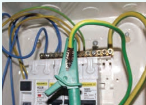
شکل ۹- اتصال فیش گیره‌دار به سر هادی اتصال زمین
