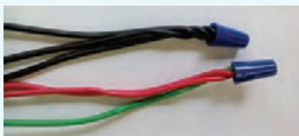
شکل ۴۲- بستن کانکتور پیچی
