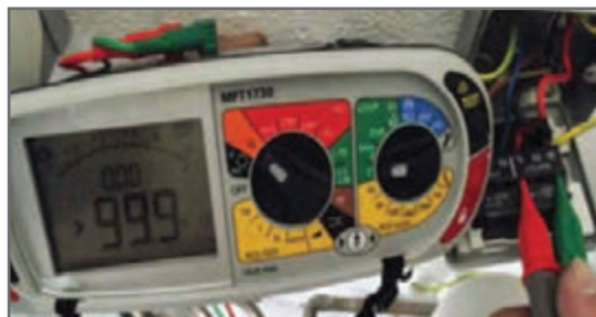
شکل ۲- مقدار R_1 + R_2
