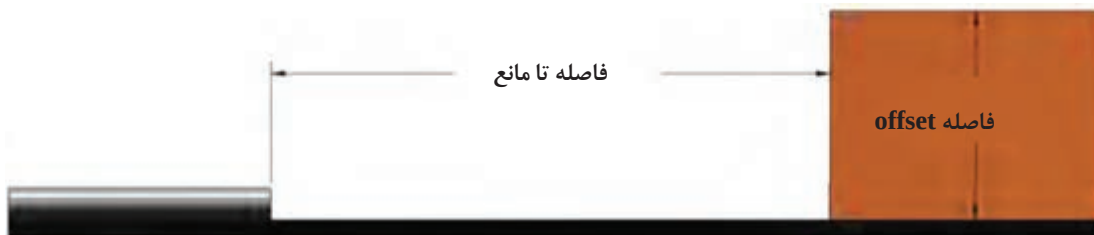
شکل ۳۷- اندازه‌گیری خم انحرافی
