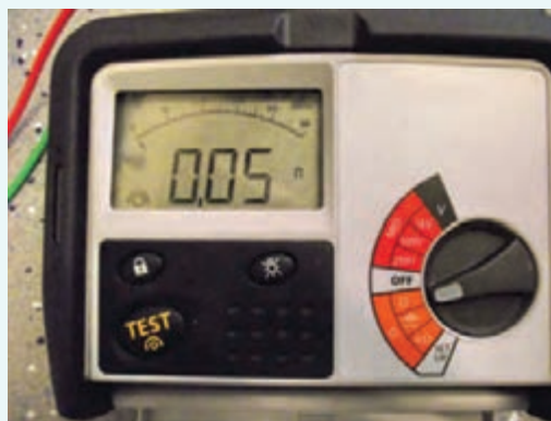
شکل ۱۱- اندازه‌گیری مقاومت هادی همبندی
