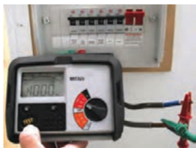
شکل ۲۱- آزمون بین دو هادی برق‌دار (فاز و نول)
