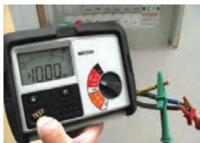
شکل ۲۲- آزمایش بین هادی برق‌دار و هادی حفاظتی
