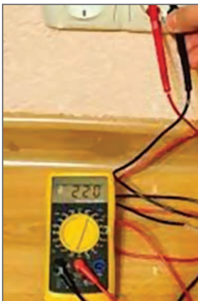
شکل ۶- اتصال مولتی‌متر به شبکه برق شهر
