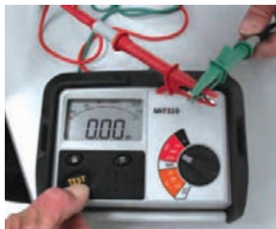
شکل ۲۰- کمترین عدد قابل اندازه‌گیری شده
