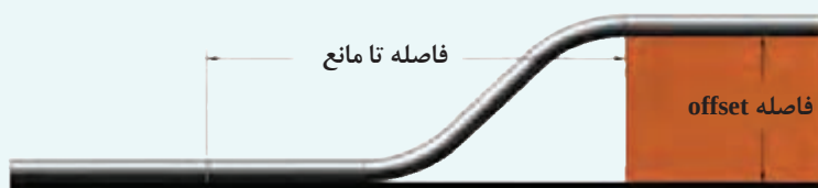
شکل ۴۲- هم راستا کردن امتداد لوله
