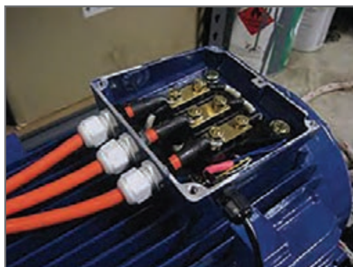
ج) گلند در اتصال به تخته کلم موتور الکتریکی
