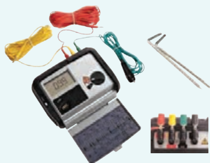
شکل ۱۵- اندازه‌گیری مقاومت زمین توسط دستگاه آزمونگر
