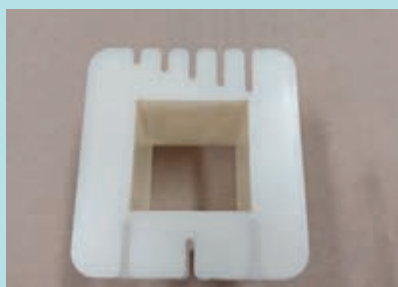
شکل ۸- عمق شیارهای جانبی، یکسان نیست
