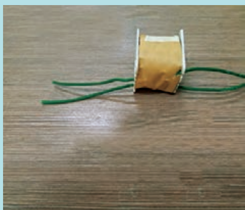
شکل ۳۹- خارج کردن دو سر سیم‌پیچ ثانویه از قرقره و عایق‌کاری نهایی
