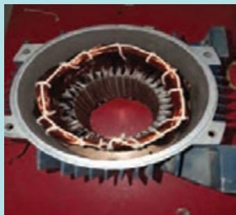
شکل ۶۱- استاتور پس از سربندی و نواربندی
