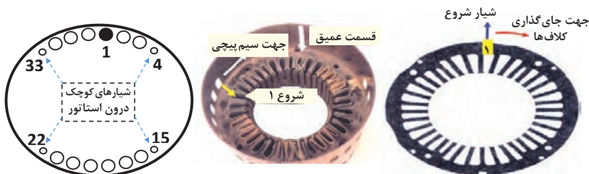
شکل ۳۸- شماره گذاری روی استاتور کولر
