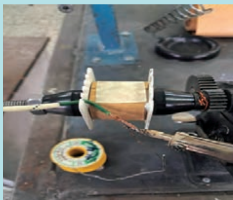
شکل ۳۳- اتصال سیم افشان به سیم لاکی
