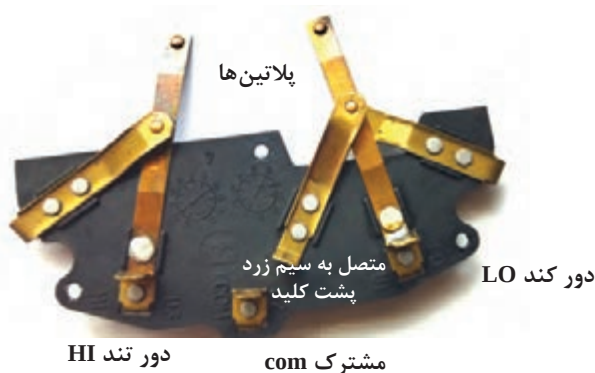
شکل ۳۶- محل اتصال سرسیم‌های کلید کولر به کلید تابع دور روی تخته کلم موتور
