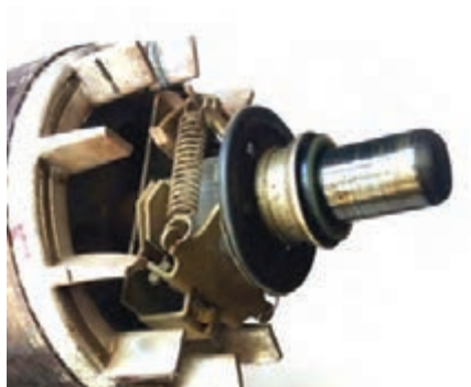
شکل ۳۴- روتور موتور تک فاز به همراه کلید تابع دور
