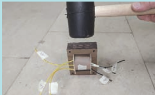
شکل ۱۳- ضربه به هسته با استفاده از چکش پلاستیکی
