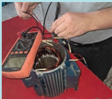
شکل ۵۹- تست بدنه و تست صحت سر و ته کلاف ها
