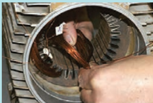
شکل ۴۸- نحوه نادرست کلاف گذاری
