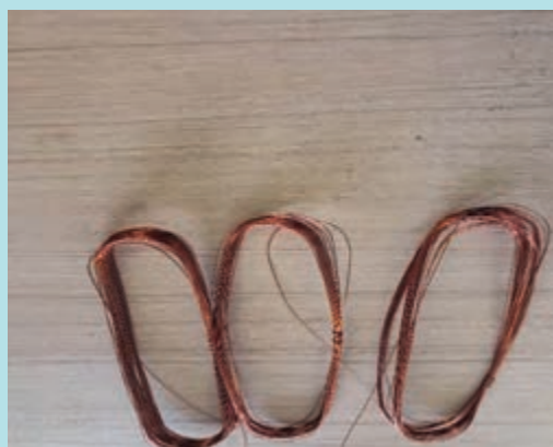
شکل ۴۹- کلاف‌های آماده و جا زده شده در شیارها
