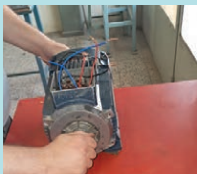
شکل ۷۰- تشخیص گیر مکانیکی با چرخاندن محور
