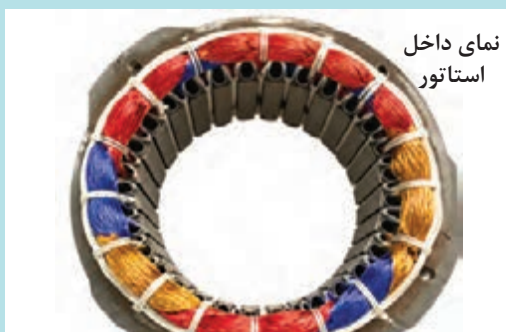
شکل ۵۳- کلاف گذاری راه انداز و تکمیل سیم پیچی
