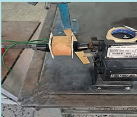
شکل ۳۷- عایق کردن بین اولیه و ثانویه
