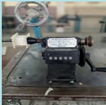
شکل ۳۲- بستن قرقره روی بوبین پیچ
