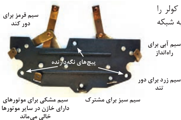
شکل ۳۵- اتصال سرسیم‌های سیم پیچ کولر به پین‌های کلید
