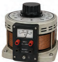
شکل ۱۶- منبع ولتاژ متغیر AC
