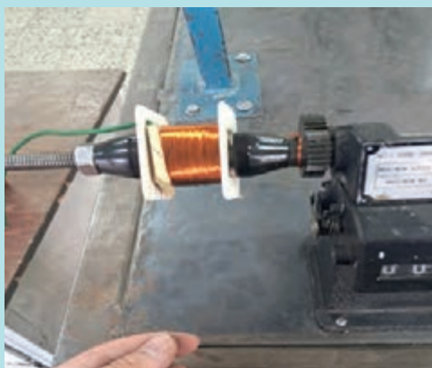
شکل ۳۵- منظم پیچیدن ترانسفورماتور
