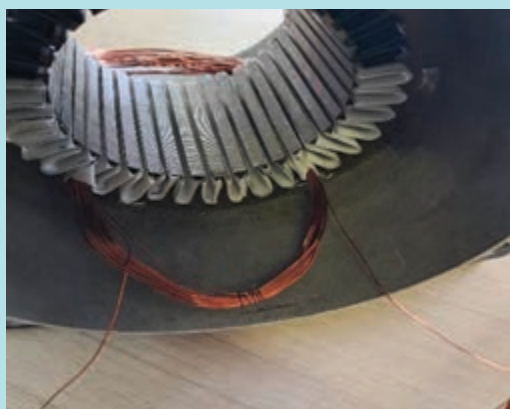
شکل ۴۹- کلاف‌های آماده و جا زده شده در شیارها
