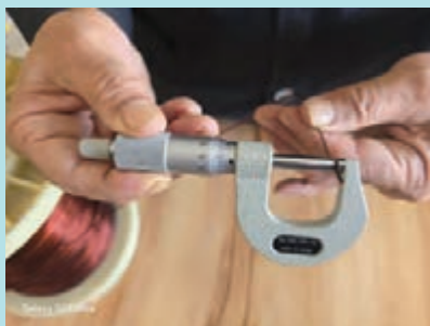
شکل ۲۰- قرقه های سیم لاکی و قرائت قطر با میکرومتر
