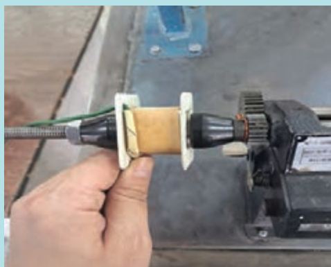
شکل ۳۴- قرار دادن وارنیش و خارج کردن سیم از قرقره
