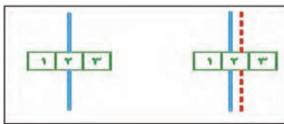
شکل ۱- وضعیت شیار در سیم پیچی یک طبقه و دو طبقه
