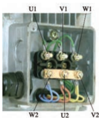
شکل ۱۰- اتصال ستاره بر روی تخته کلم
