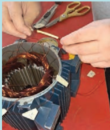
شکل ۵۵- سربندی (اتصال) کلاف‌های موتور
