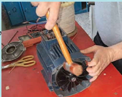
شکل ۶۹- سوار کردن روتور
