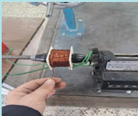
شکل ۳۸- پیچیدن سیم‌پیچ ثانویه
