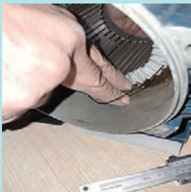
شکل ۳۰- اندازه‌گیری تجربی محیط کلاف
