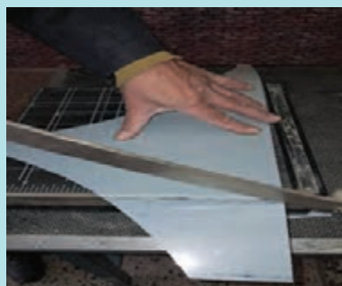
شکل ۲۶- اندازه‌گیری و برش عایق موجود در کارگاه
