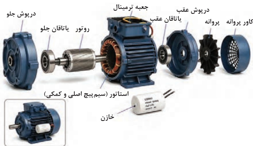
شکل ۳- تصویر انفجاری (باز شده) یک موتور الکتریکی تک‌فاز
