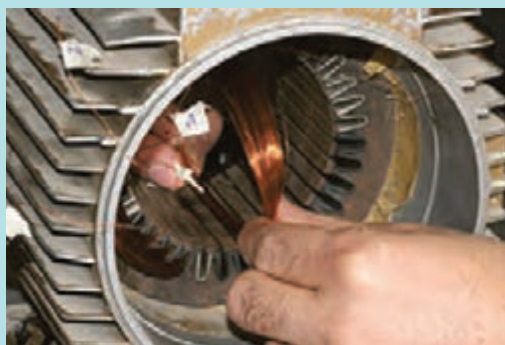
شکل ۴۷- نحوه صحیح جازدن کلاف
