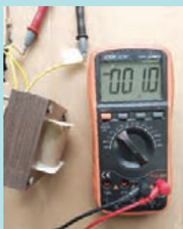
شکل ۱۵- محاسبه اتصال بدنه
