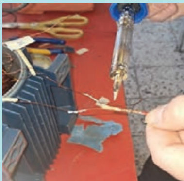
شکل ۵۴- لحیم کاری سر سیم های موتور
