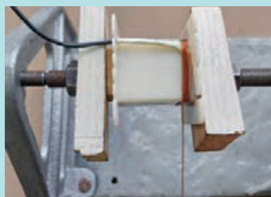
شکل ۷- قرارگیری وارنیش و سیم افشان در پایین ترین سطح سیم پیچی
