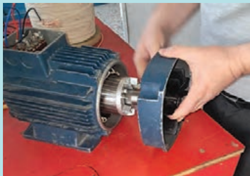
شکل ۶۸- جا زدن روتور
