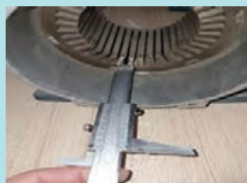
شکل ۲۵- اندازه‌گیری طول استاتور
