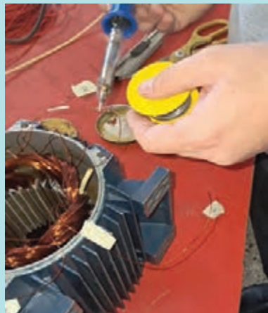
شکل ۵۶- لحیم کاری اتصالات کلاف‌های موتور
