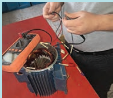
شکل ۵۹- تست بدنه و تست صحت سر و ته کلاف ها
