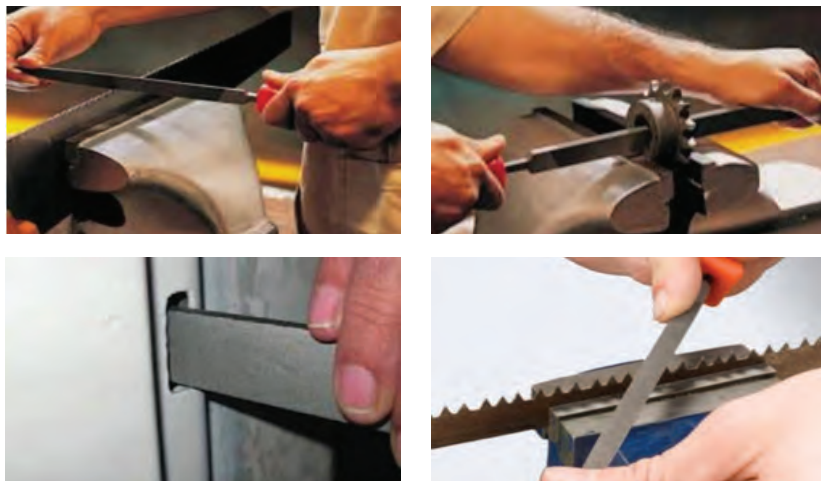
شکل ۶۴- سوهان کاری شکاف
