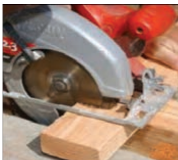
شکل ۳- برش با اره برقی
