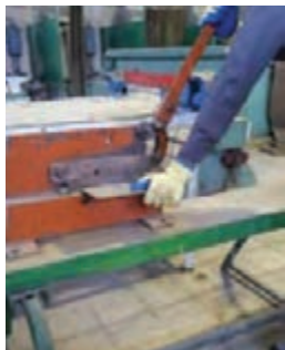
شکل ۱۷- کار با قیچی اهرمی
