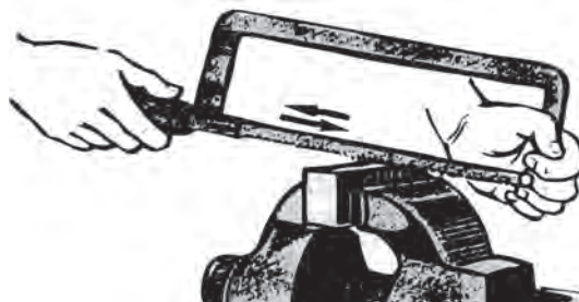
شکل ۳۲- از انحراف کمان‌اره به چپ و راست خودداری شود
