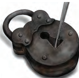
شکل ۴۲- رفع ایراد قفل با سوهان کاری
