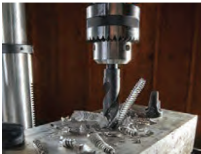
شکل ۳۱- عملیات سوراخ کاری قبل از برقکاری
