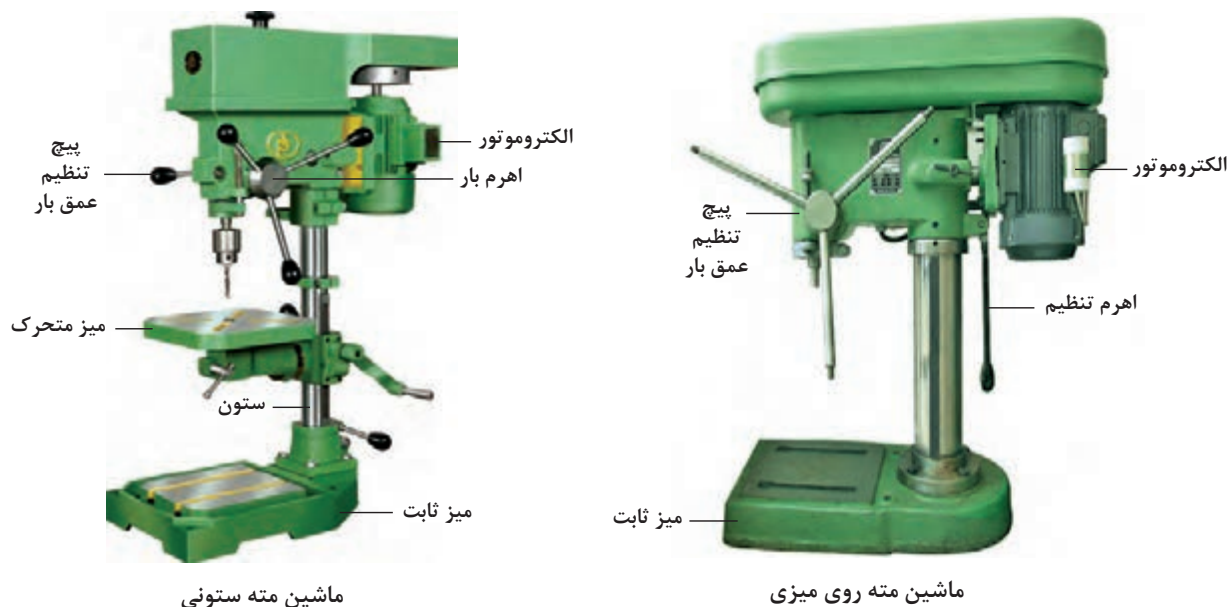
شکل ۱۱- بخش‌های اصلی ماشین مته
