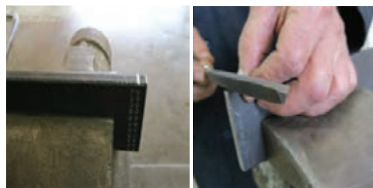
شکل ۲۹- استفاده از سوهان سه گوش
