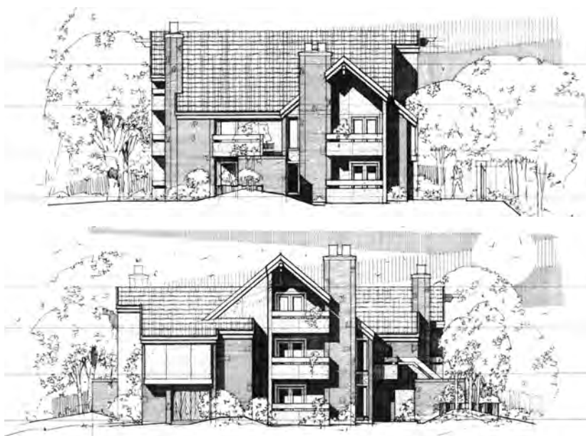
شکل ۱۱۷- ارائه نما با استفاده از سایه روشن نما و بافت مصالح
