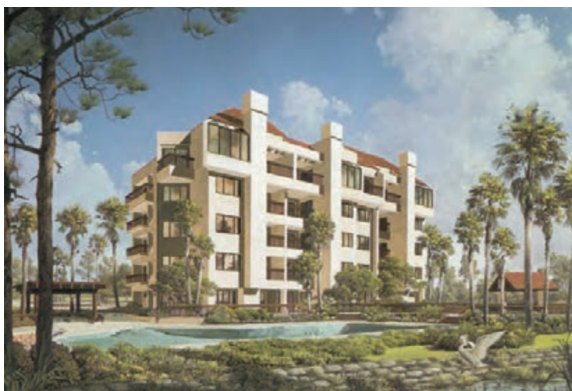
شکل ۱۱۸- نمایش ساختمان با استفاده از پرسپکتیو دو نقطه‌ای
