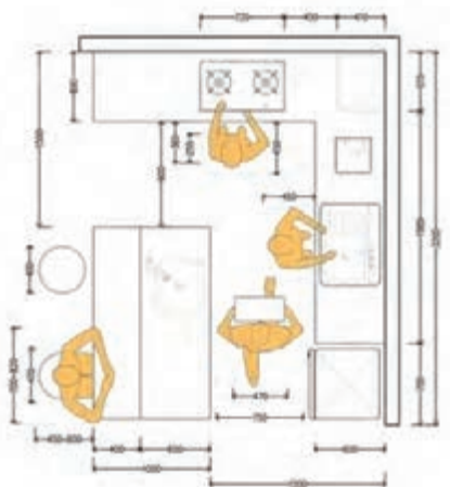
شکل ۱۰۸- استانداردهای نصب کابینت آشپزخانه و غذاخوری
