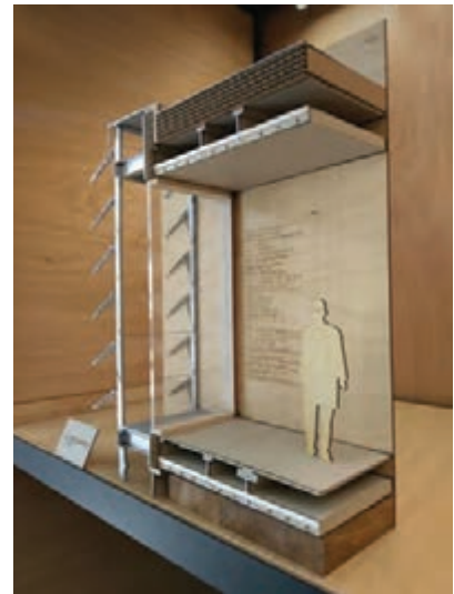
شکل ۱۴۸- مقطع اجرایی از سقف، کف و دیوار
