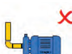
رعایت نکردن فاصله مناسب اتصالات با افت بالا در مکش
