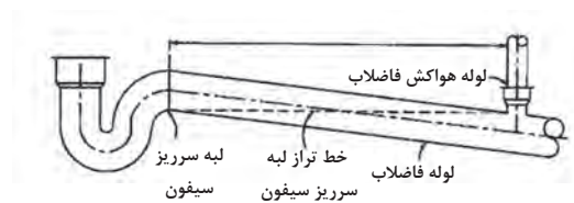
شکل ۱۶- اتصال لوله هواکش خشک لوازم بهداشتی
