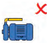
رعایت نکردن فاصله مناسب اتصالات با افت بالا در دهش
