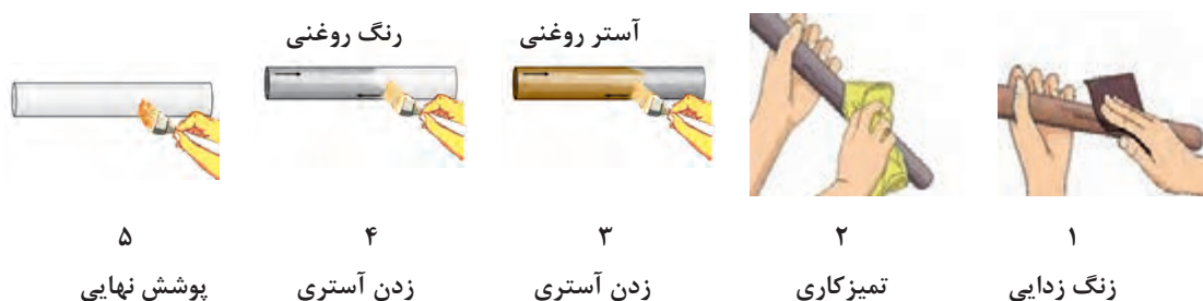
شکل ۴۰- مراحل رنگ آمیزی لوله
