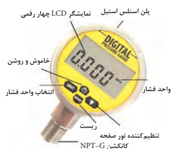
شکل ۵۶- فشارسنج تست لوله کشی گاز
