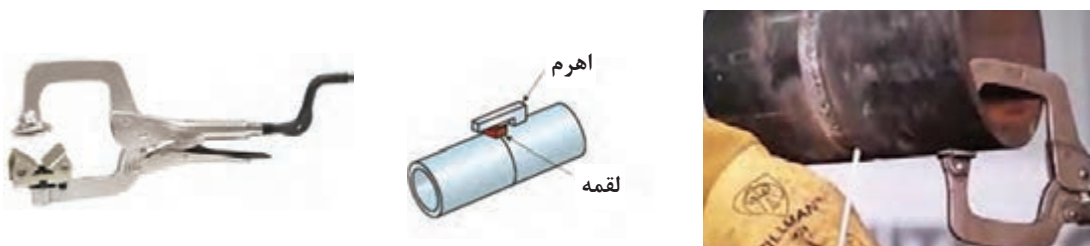
شکل ۵۰ - ابزار فیت کردن
