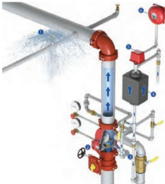
شکل ۳۱- نمونه شیر هشدار تر (Wet Alarm Valve)
