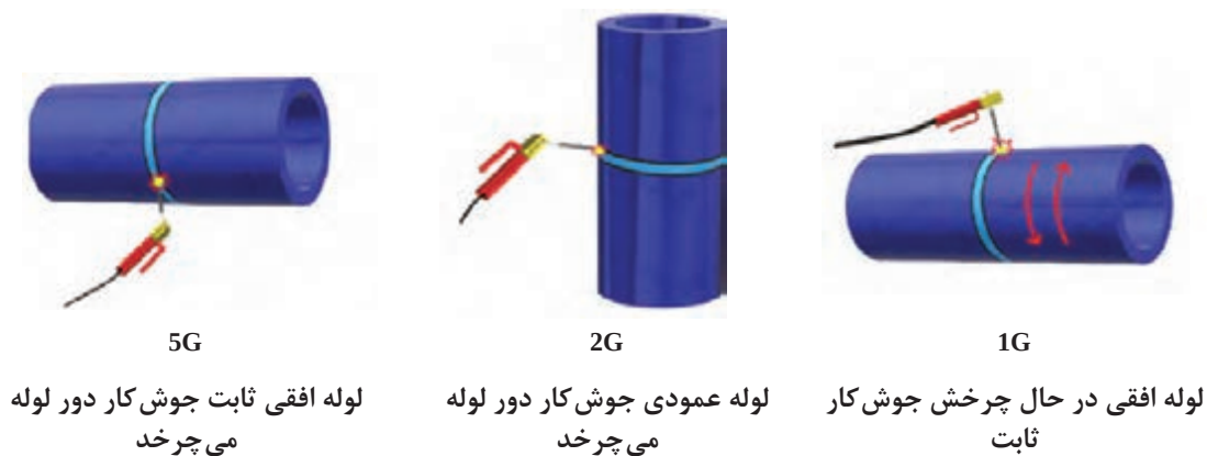
شکل ۲۱- وضعیت جوش کاری لوله
