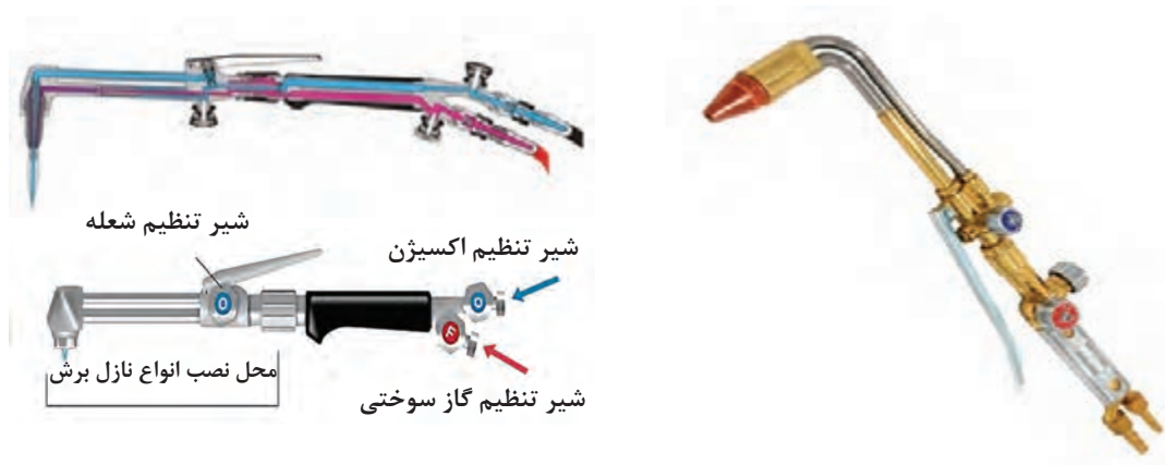
شکل ۳۵- مشعل برش کاری
