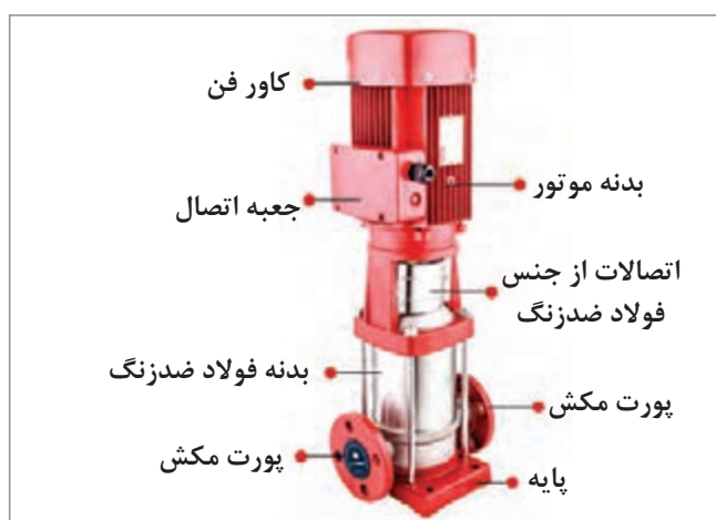
شکل ۴۸- نمونه جوکی پمپ آتش نشانی
