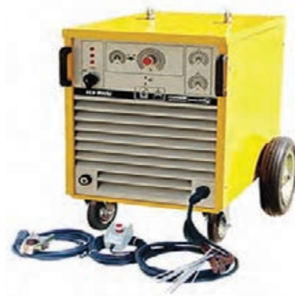
شکل ۲۳- انواع دستگاه رکتی فایر
