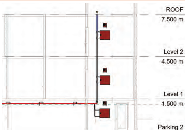
لوله کشی فایرباکس طبقات
