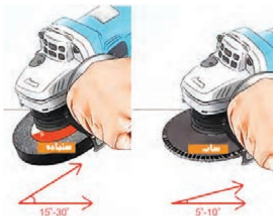
شکل ۵۷- زاویه سنگ فرز
