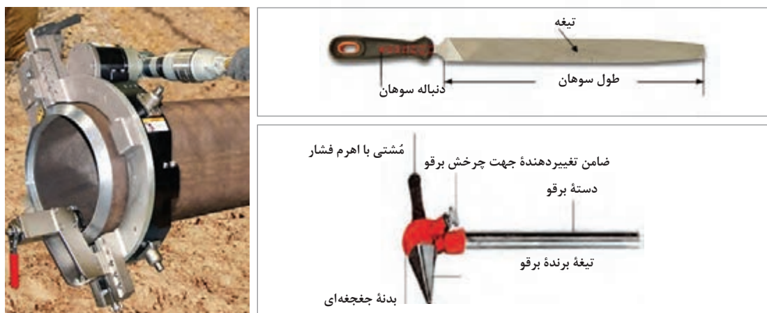
شکل ۵۸- تجهیزات پلیسه‌گیری و پخ‌زنی لوله‌ها
