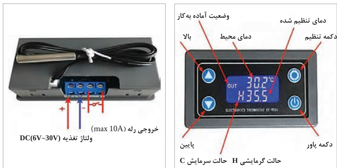
شکل ۱۳- یک نمونه ترموستات محیطی هیترهای گازی فایرتیوب
