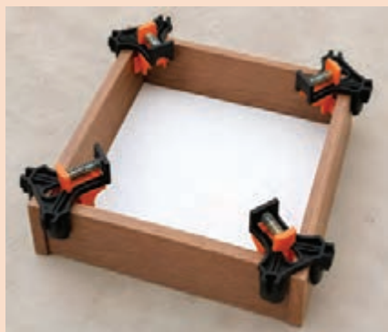
شکل ۸۰- استفاده از گیره ۹۰ درجه در مونتاژ قطعات
