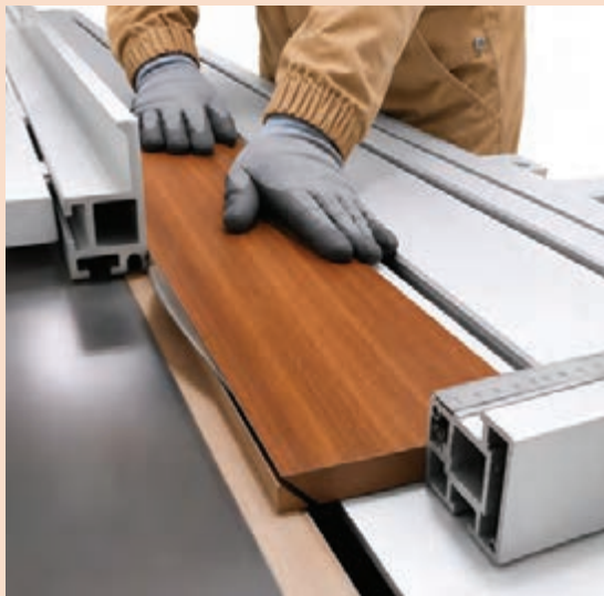
شکل ۶۶- برش فارسی با ماشین دورکن
