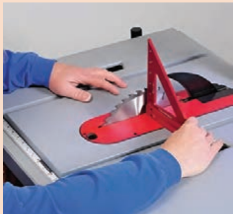
شکل ۶۳- کنترل گونیا بودن تیغه نسبت به صفحه ماشین
