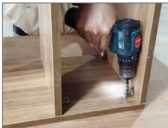
ج) متصل کردن بدنه جانبی به صفحه رویی میز عسلی با گونیای فلزی
