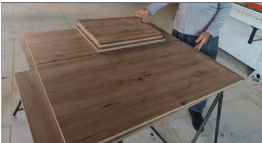
شکل ۱۰- چیدمان قطعات برای لبه چسبانی
