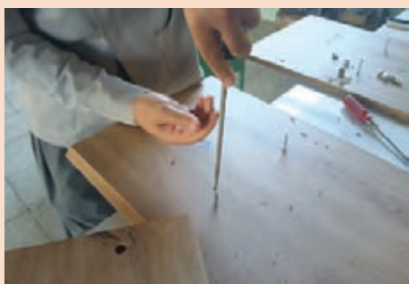
شکل ۲۰- نصب میله رابط
