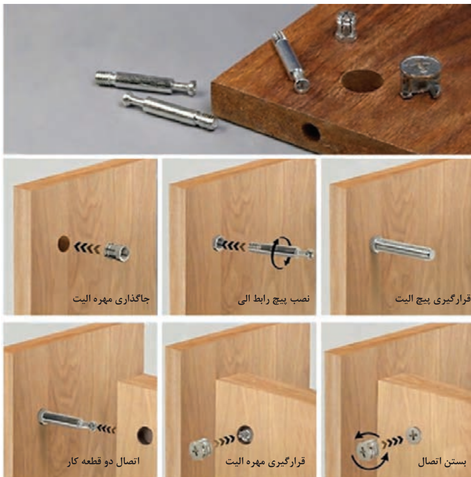
شکل ۱۰- مراحل نصب پیچ الیت
