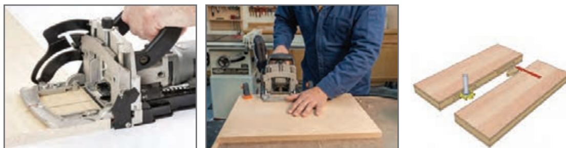
شکل ۲۲- شیارزنی با دستگاه بیسکویت زن
