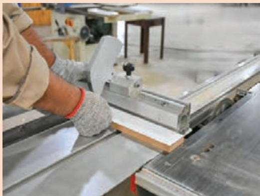
شکل ۶- برش عرضی قطعات
