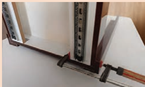
شکل ۹۴- استفاده از پیچ دستی در نصب پایه
