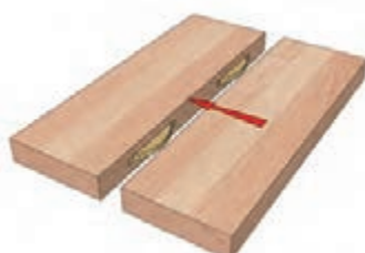
۲۴- تنظیم و بستن قطعات با گیره
