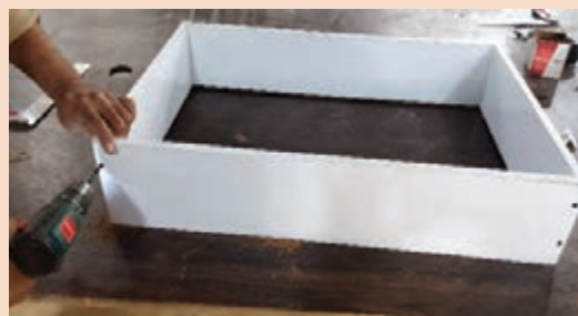
شکل ۲۰- بستن پیچ‌های گوشه آخر
