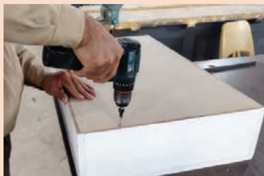
شکل ۳۶- سوراخ کردن محل پیچ
