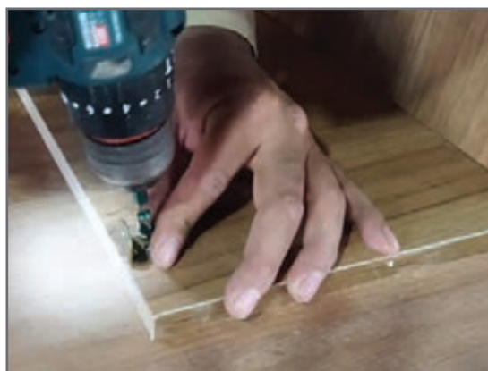
الف) نصب گونیای فلزی روی بدنه میز عسلی
