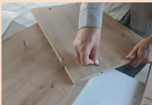
شکل ۲۱- نصب کپسول استوانه‌ای
