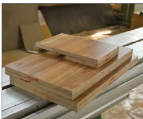
علامت نوار کاری روی تمامی قطعات برش خورده
