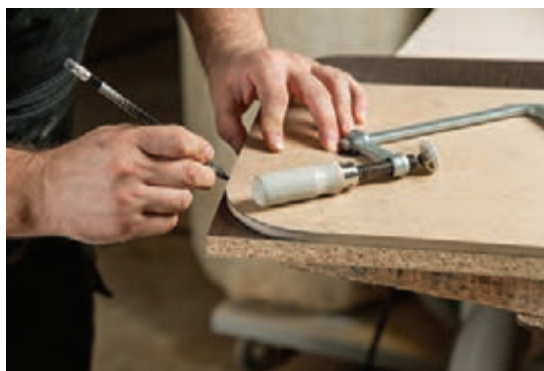
(الف) ترسیم قوس با استفاده از شابلون
