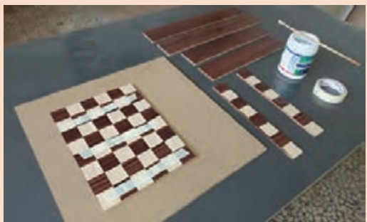
شکل ۷۰- چسباندن قطعات به یکدیگر و تشکیل صفحه شطرنج
