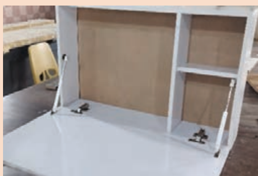
شکل ۴۲- نصب کامل هر دو جک
