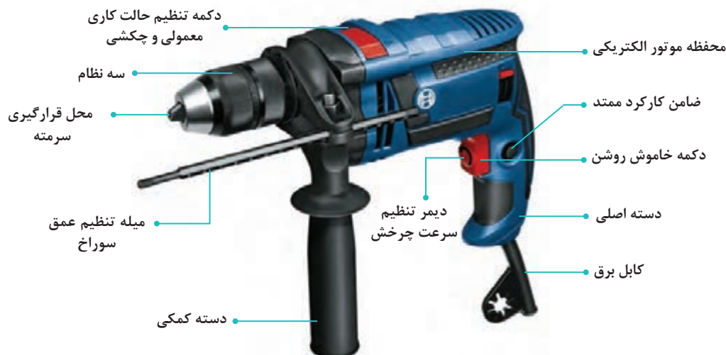
شکل ۳- دریل برقی با حالت‌های کاری معمولی و چکشی
