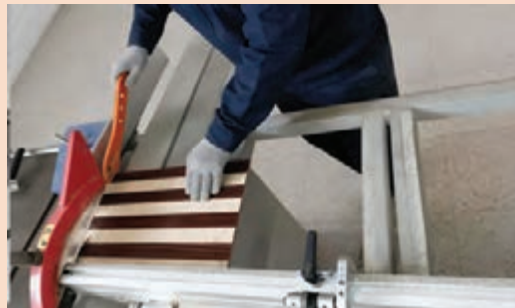
شکل ۶۹- برش قطعات چسب خورده با ماشین دورکن
