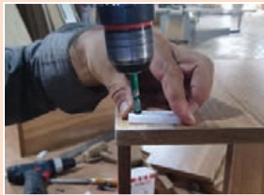
الف) پیچ کردن پایه بیسکوییتی با پیچ بند شارژی ب) پایه‌های بیسکوییتی نصب شده زیر میز زیر گلدانی شکل ۵۴- نصب پایه بیسکوییتی زیر کفی میز زیر گلدانی
