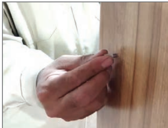
شکل ۳۳- نصب پین طبقه روی بدنه میز عسلی
