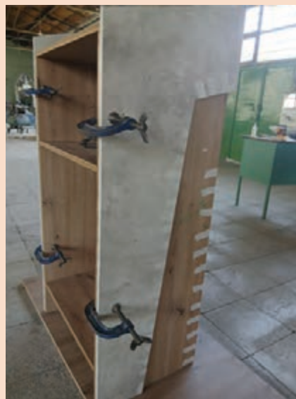
شکل ۲۶- بستن نمای طرح سنگ به بدنه با پیچ دستی
