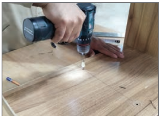
ب) سوراخ‌کاری محل علامت‌گذاری شده با مته دارای چسب راهنمای عمق
