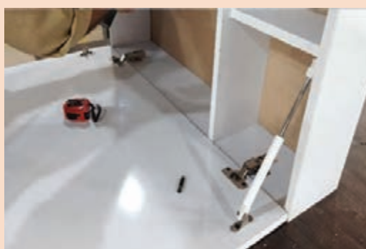
شکل ۴۱- نصب کامل یک جک
