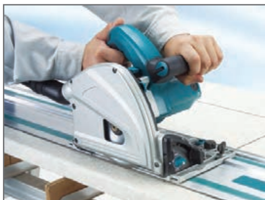
برش کاری با اره گرد نفوذی با استفاده از ریل راهنمای آن
