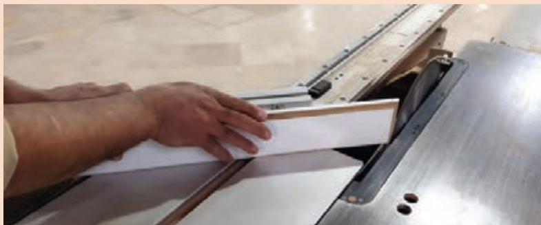
شکل ۱۱- برش فارسی با ماشین اره دورکن
