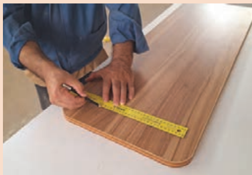
الف) خط‌کشی محل قرارگیری ریل
