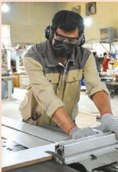
شکل ۴- برش عرضی قطعات
