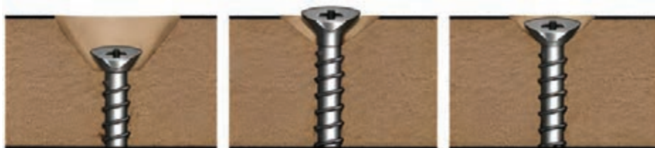
شکل ۸۳- حالت‌های درست و نادرست خزینه کاری
