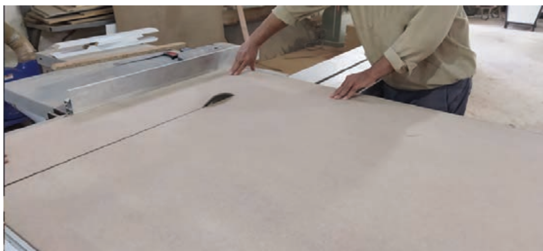
شکل ۸- برش کف جعبه از ام دی اف به ضخامت ۸ میلی‌متر
