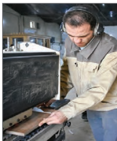
الف) هدایت قطعه درون دستگاه لبه‌چسبان برای نوارکاری قطعات
