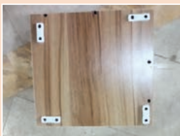
الف) پیچ کردن پایه بیسکوییتی با پیچ بند شارژی ب) پایه‌های بیسکوییتی نصب شده زیر میز زیر گلدانی شکل ۵۴- نصب پایه بیسکوییتی زیر کفی میز زیر گلدانی
