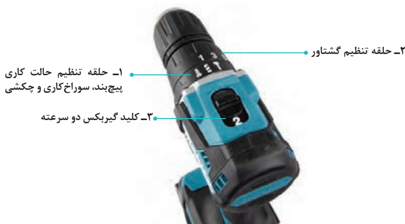
شکل ۶- سه بخش اصلی تنظیم حالت کاری، حلقه تنظیم گشتاور و کلید گیربکس دو حالت
