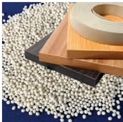
شکل ۵۶- چسب با شکل گرانول مورد استفاده در ماشین لبه چسبان
