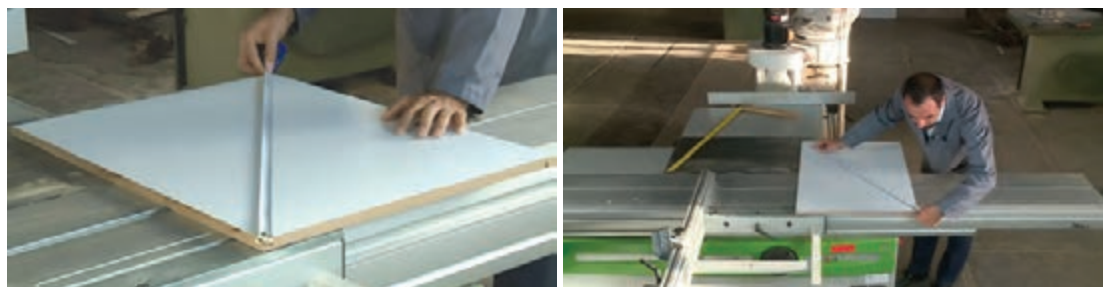
شکل ۴۹- کنترل گونیا بودن قطعه کار پس از برش کاری با ماشین دورکن
