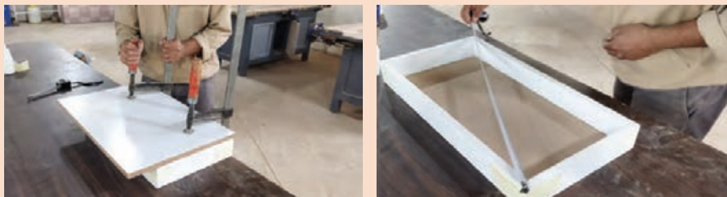
شکل ۲۳- بستن کف با پیچ دستی
