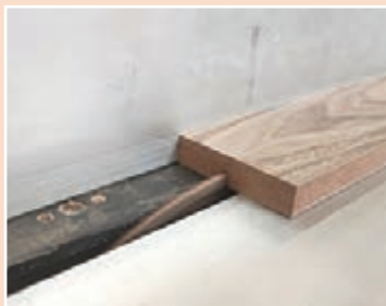
ب) شیار زنی روی قطعه پرت
