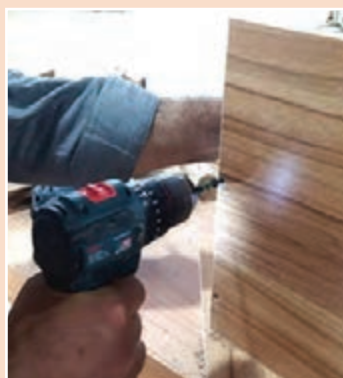
۱- پیچ کردن بدنه میز زیر گلدانی به کف ۲- بدنه‌های پیچ شده به کف میز زیر گلدانی
