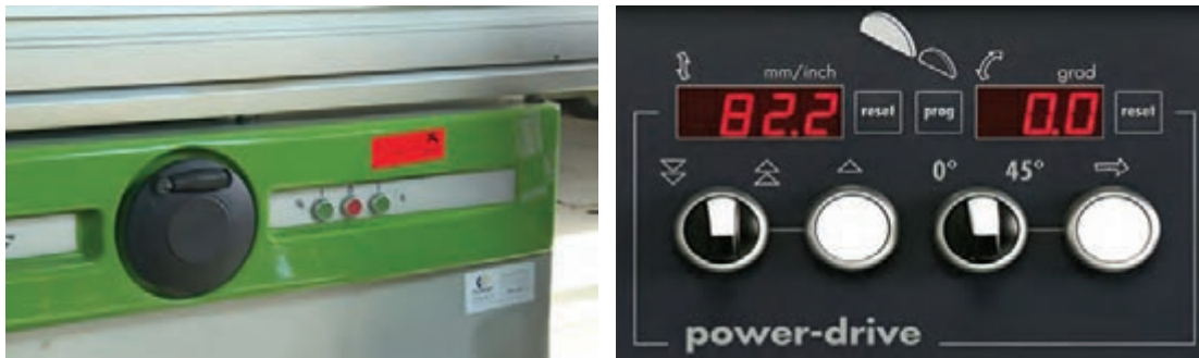
شکل ۴۳- تنظیم ارتفاع و زاویه تیغه به صورت اتوماتیک و با کمک فرمان
