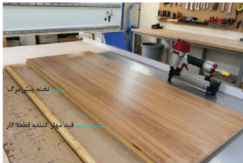
شکل ۶۷- تثبیت قطعه کار روی میز CNC توسط میخکوب
