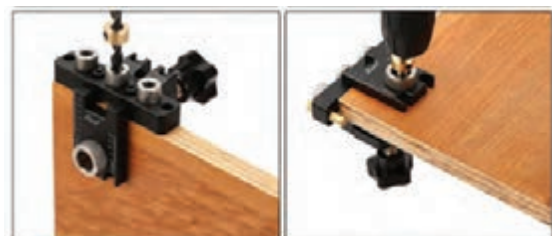
۳- از یک مته ۸ میلی‌متری برای ایجاد سوراخ به ترتیب استفاده کنید.
