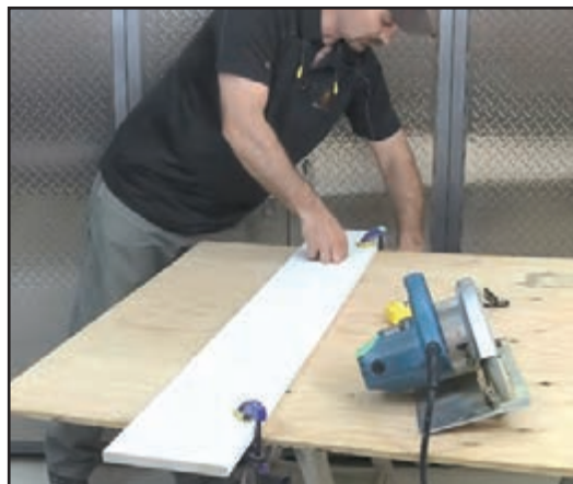
شکل ۴۲- بستن خط‌کش راهنمای برش با استفاده از پیچ دستی
