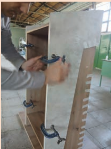
شکل ۲۶- بستن نمای طرح سنگ به بدنه با پیچ دستی
