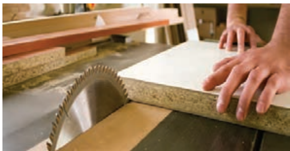
شکل ۵۰- برش کاری به صورت نا ایمن
