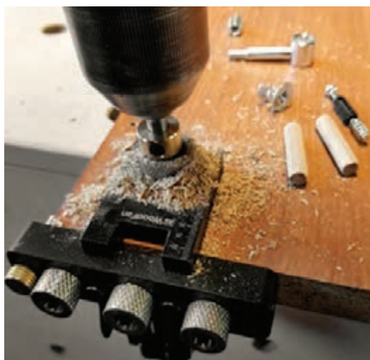
شکل ۹- مراحل سوارخ کاری برای پیچ الیت
