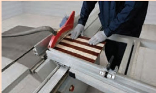
شکل ۶۹- برش قطعات چسب خورده با ماشین دورکن
