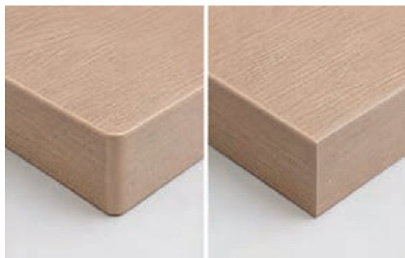
شکل ۵۸- نیم‌گرد کردن گوشه نوار در ایستگاه کرنرزن
