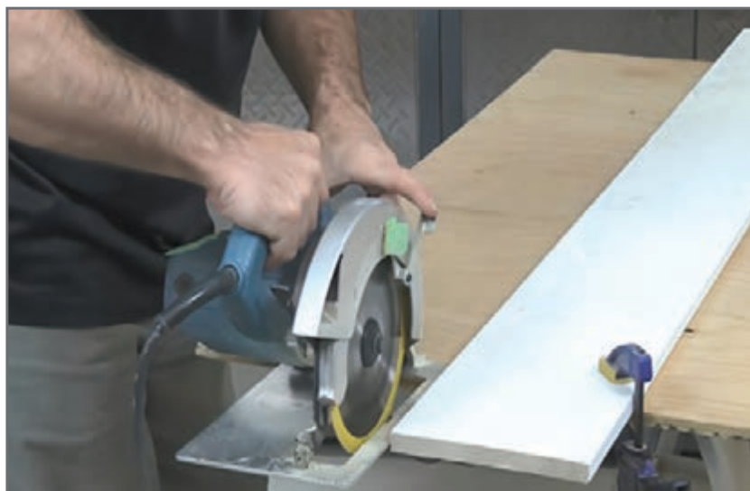
شکل ۴۳– عملیات برش با اره گرد دستی به کمک خط‌کش راهنما برای برش صاف
