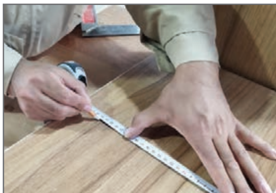
الف) اندازه‌گیری با متر و علامت زدن محل سوراخ پین طبقه با مداد
