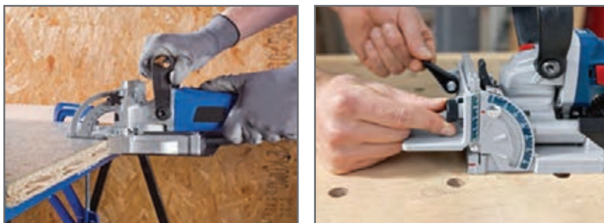
شکل ۲۰- تنظیم ارتفاع محل اتصال بیسکویت
