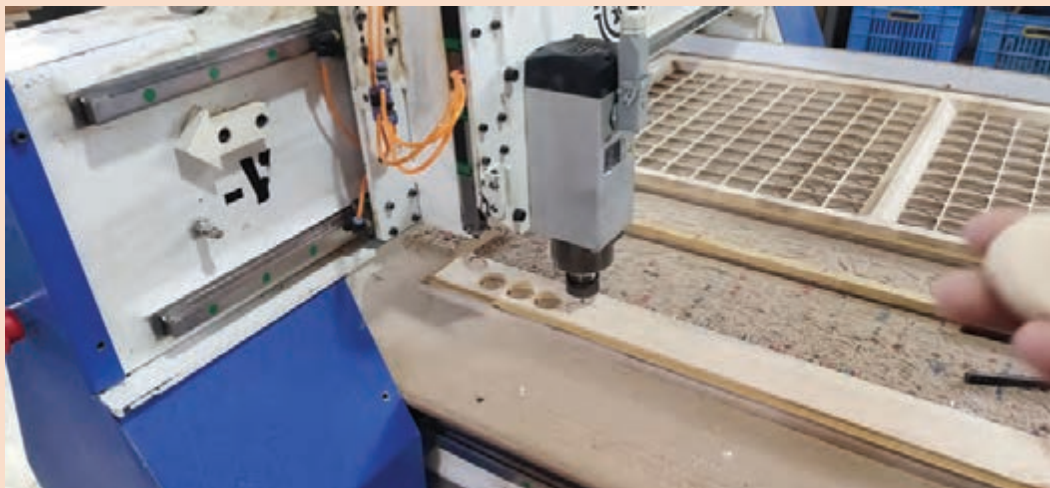
شکل ۱۵- ساخت مهره با ماشین CNC
