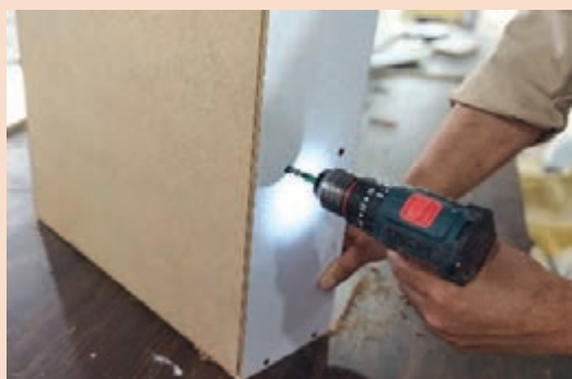
شکل ۲۴- بستن پیچ وادار در حالت افقی
