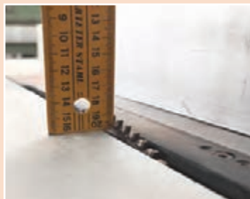
الف) تنظیم ارتفاع تیغه برای شیار زنی
