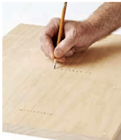
شکل ۱۸- خط‌کشی و علامت‌گذاری محل قرارگیری بیسکویت‌ها
