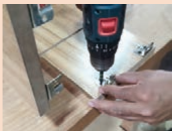
الف) پیچ کردن گونیا‌های فلزی به بدنه میز زیر گلدانی
