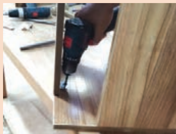
الف) پیچ کردن گونیا‌های فلزی به بدنه میز زیر گلدانی
