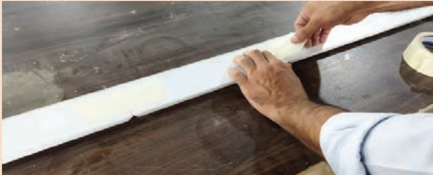
شکل ۱۶- اتصال گوشه‌ها با استفاده از چسب کاغذی
