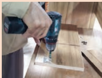
الف) پیچ کردن گونیا‌های فلزی به بدنه میز زیر گلدانی
