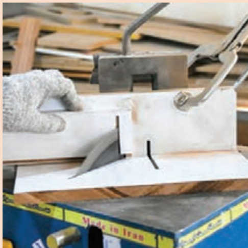
شکل ۱۰- عملیات برش فارسی با استفاده از ماشین اره فارسی بر صندوقی (قطع کن از پایین) با گونیای کمکی
