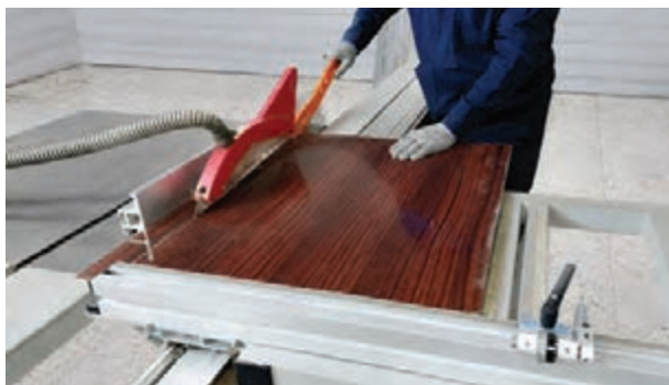
شکل ۴۷- تکیه قطعه کار به گونیا و کنترل و هدایت توسط هر دو دست
