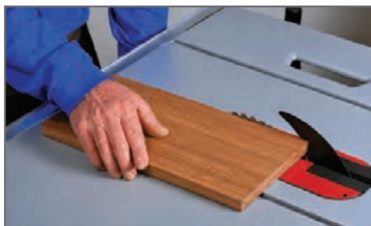
شکل ۳۶- میزان بیرون زدگی مناسب تیغه از روی قطعه کار
