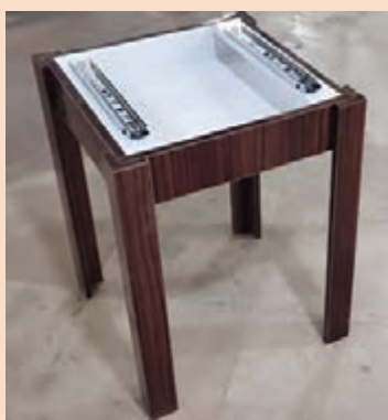
شکل ۹۲- نصب ریل روی بدنه و زیر صفحه شطرنج
