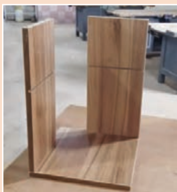
۱- پیچ کردن بدنه میز زیر گلدانی به کف ۲- بدنه‌های پیچ شده به کف میز زیر گلدانی
