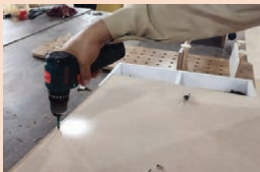
شکل ۳۷- بستن پیچ و محکم کردن پشت بند
