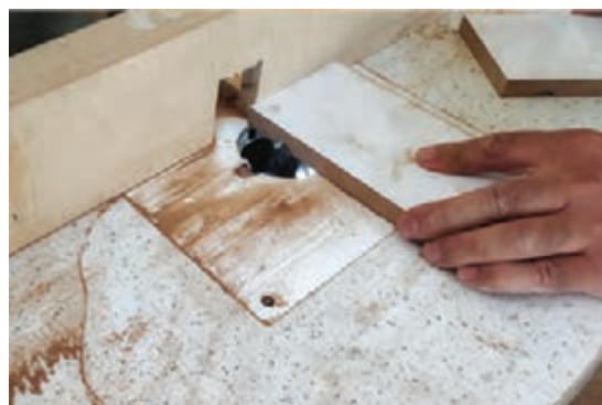
(ج) نحوه زدن شیار نیم گرد
