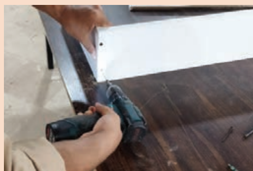
شکل ۱۷- سوراخ کاری محل پیچ دوم
