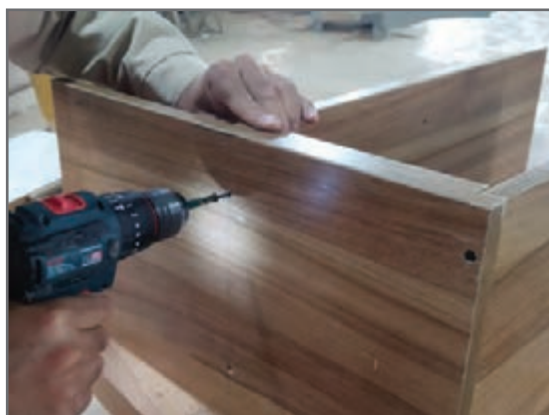
ب) پیچ کردن بدنه و وادار به کف میز عسلی
