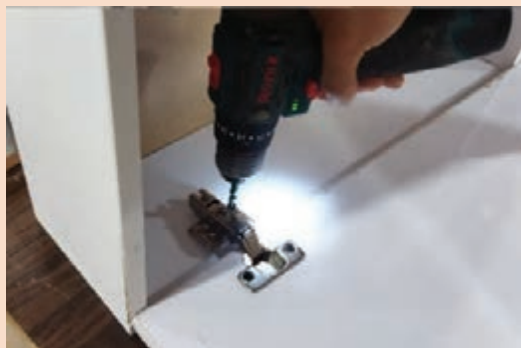
شکل ۳۸- بستن پیچ لولای اول و دوم داخل کف
