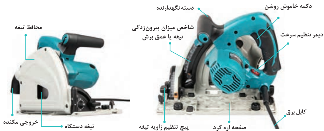
شکل ۳۷- ماشین اره گرد دستی نفوذی (ریلی) برقی
