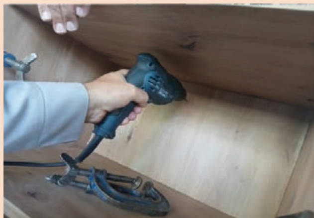
شکل ۲۷- سوراخ کاری محل پیچ
