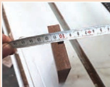
ج) کنترل دقت شیار زنی روی قطعه پرت
