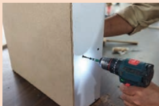
شکل ۲۴- بستن پیچ وادار در حالت افقی
