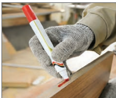
علامت زدن نر قطعه کار برای نوار کاری
