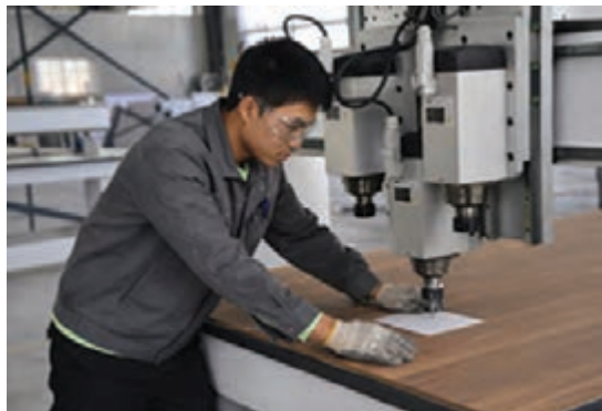
(الف) تعیین نقطه صفر کاری
