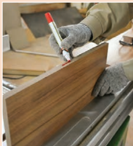
علامت زدن ضخامت قطعه برای نوار کاری
