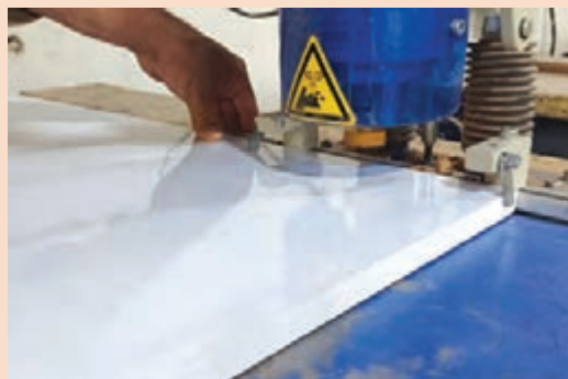
شکل ۲۶- تنظیم ماشین لولازن برای ایجاد حفره
