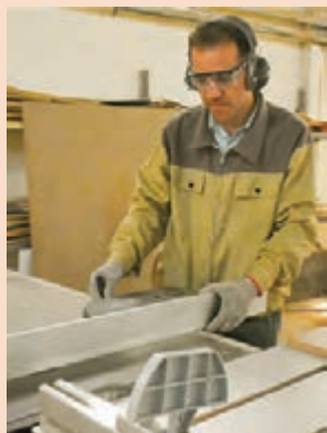
ب) تنظیم گونیا برای برش عرضی قطعات
