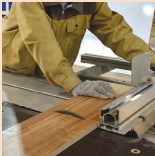
شکل ۶۴- برش طولی و عرضی قطعات
