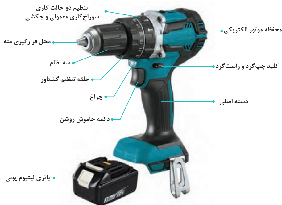
شکل ۴- اجزای مختلف دریل شارژی
