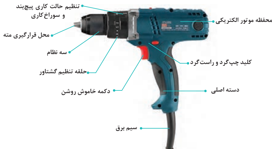
شکل ۵- دریل (پیچ‌بند) برقی و اجزای مختلف آن
