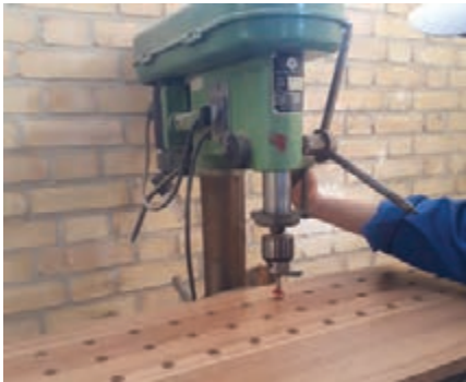
ب) سوارخ کاری با دریل ستونی
