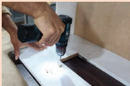
شکل ۲۱- سوراخ کاری محل پین روی وادار
