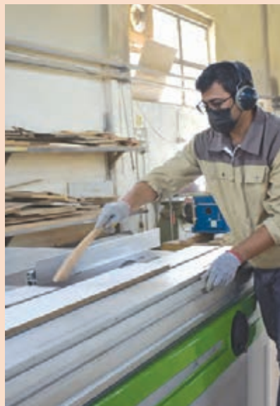
شکل ۳- برش طولی قطعات با استفاده از دستک فشار
