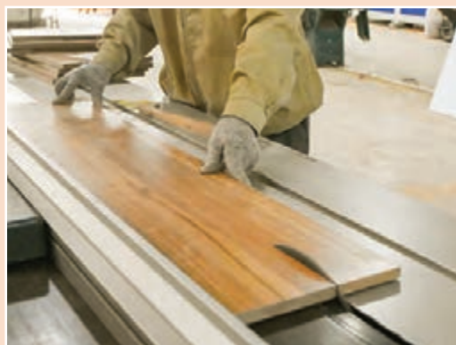
شکل ۴۷- برش طولی بدنه با کمک گونیای اصلی
