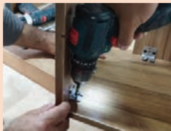
الف) پیچ کردن گونیا‌های فلزی به بدنه میز زیر گلدانی
