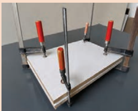
شکل ۷۳- پرس قطعات چسب کاری شده
