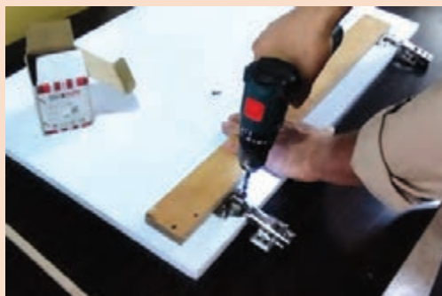
شکل ۳۰- استفاده از قطعه کمی مازاد برای هم راستا کردن لولاها شکل ۳۱- بستن پیچ لولاها با دریل پیچ گوشتی
