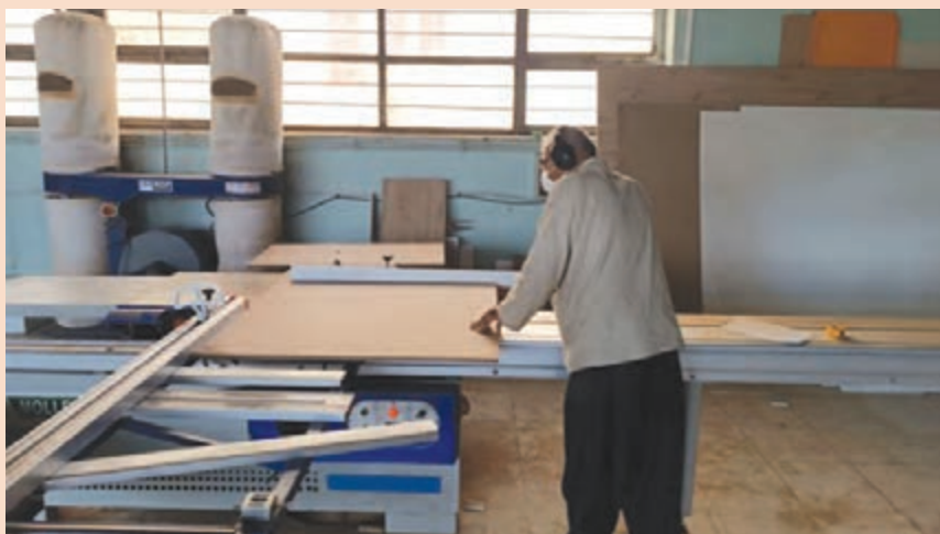
شکل ۸- برش قطعات با ماشین اره دورکن
