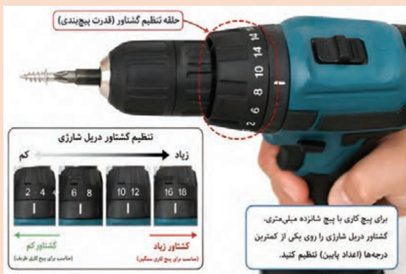
شکل ۸۹- تنظیم گشتاور دریل شارژی
