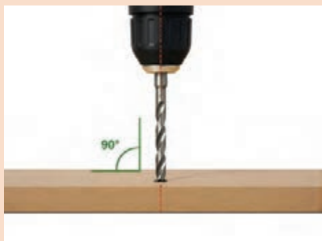
شکل ۸۱- عمود بودن مته بر سطح تخته
