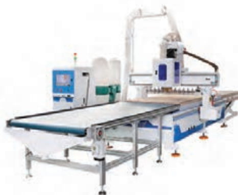
شکل ۳۱- ماشین‌های مورد استفاده برای برش چوب و صفحات فشرده چوبی
