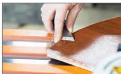
شکل ۵۷- حذف اضافه نوار به روش دستی
