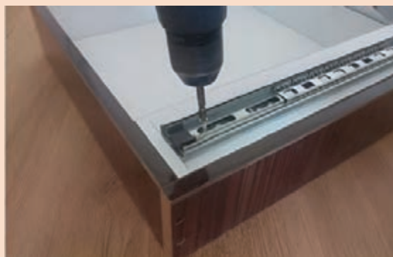
شکل ۹۲- نصب ریل روی بدنه و زیر صفحه شطرنج
