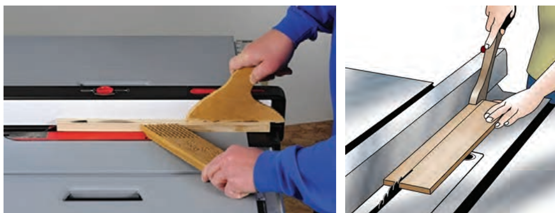
شکل ۴۶- استفاده از دستک فشار (جیگ) در برش‌کاری
