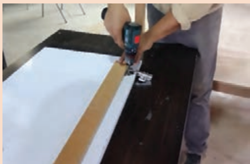
شکل ۳۰- استفاده از قطعه کمی مازاد برای هم راستا کردن لولاها شکل ۳۱- بستن پیچ لولاها با دریل پیچ گوشتی
