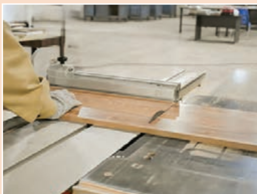
شکل ۴۸- برش عرضی بدنه با کمک گونیای متحرک
