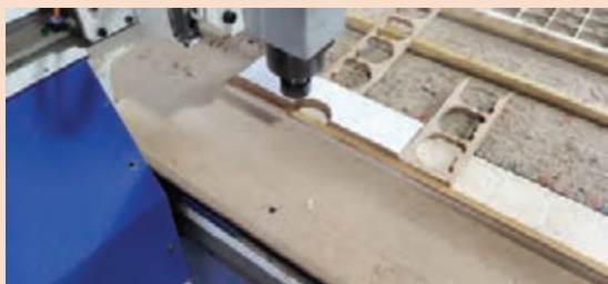
شکل ۱۴- قطعه در حال ساخت دهانه دروازه با ماشین CNC
