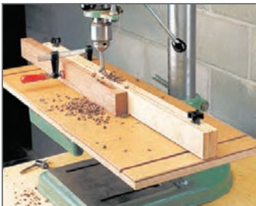
شکل ۹- صفحه کمکی نصب شده روی صفحه دریل ستونی برای راحتی عملیات سوراخ‌کاری با این دستگاه
