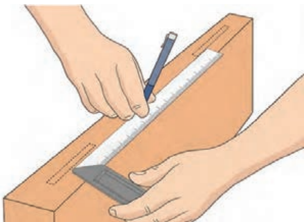
شکل ۱۸- خط‌کشی و علامت‌گذاری محل قرارگیری بیسکویت‌ها
