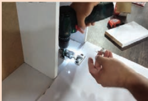
شکل ۳۸- بستن پیچ لولای اول و دوم داخل کف
