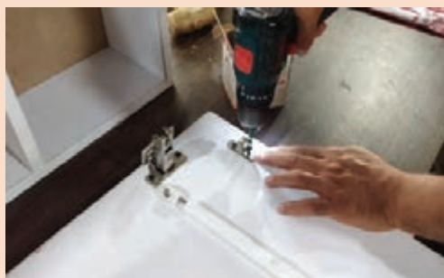
شکل ۳۳- پیچ کردن پایه جک
