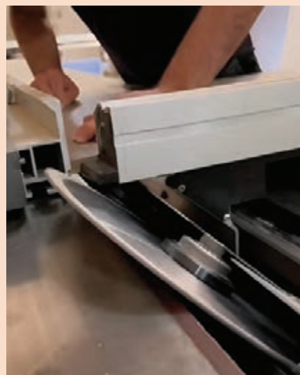
شکل ۶۶- برش فارسی با ماشین دورکن
