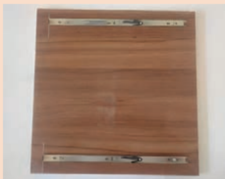
شکل ۹۲- نصب ریل روی بدنه و زیر صفحه شطرنج
