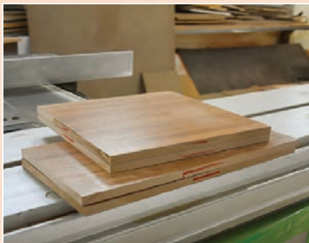
علامت برای نوار کاری روی تمامی قطعات برش خورده
