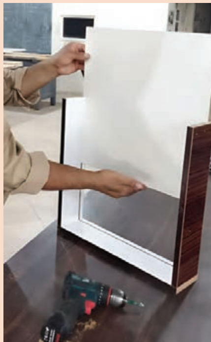
شکل ۸۴- قرار دادن کف جعبه داخل کنشکاف
