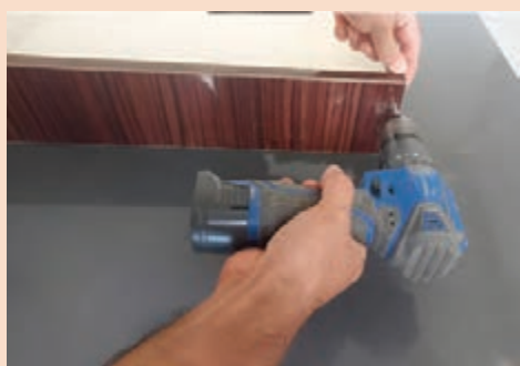
شکل ۸۲- سوراخ کاری و خزینه سطح قطعه کار
