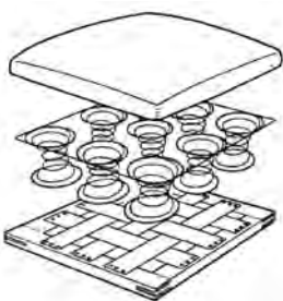
شکل ۷۷- رویه‌کوبی با فنر لول بلند
