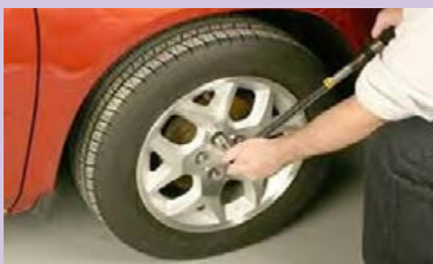
شکل ۵- گشتاور لازم برای سفت کردن چرخ
