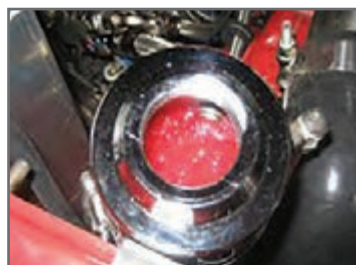
۴ هم‌زمان سطح مایع بررسی شود. تغییرات حجم، یا حباب زدن یا کف کردن نشانه تخلیه هواست. فرمان را کاملاً به سمت دیگر چرخانده و این کار حداقل ۲۰ بار تکرار شود.
