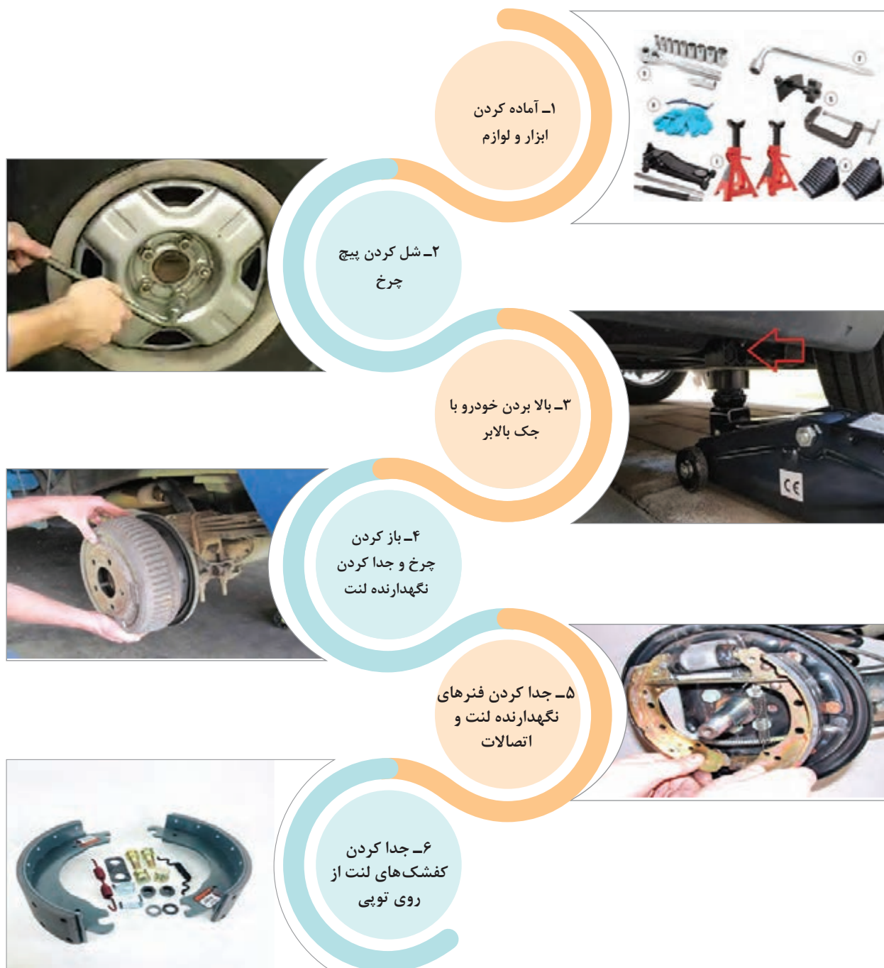
شکل ۱۱- مراحل باز کردن و تعویض لنت کفشکی
