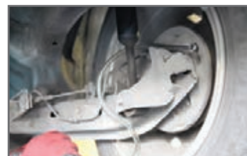
۱ لوله شفاف روی پیچ هواگیری بسته شود.
