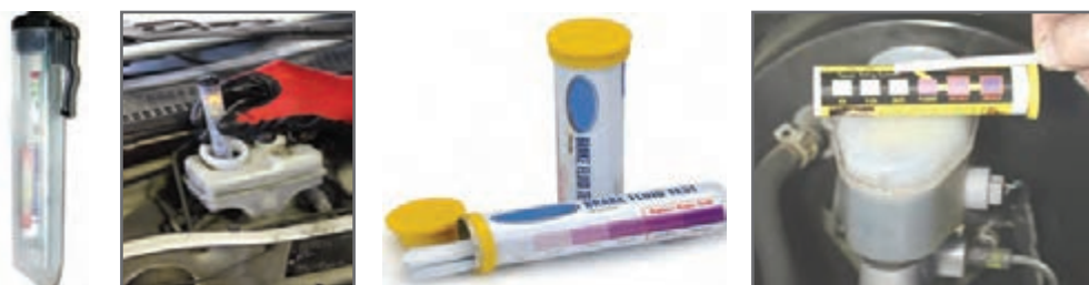
شکل ۶- آزمایش کیفیت مایع هیدرولیک ترمز
