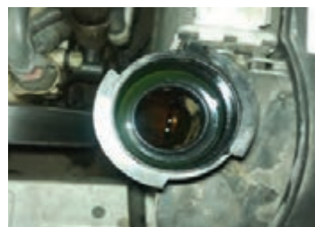
۷ در صورت چرب بودن سطح مایع، وجود زنگ زدگی روی سطح مایع یا کدر بودن آن، مایع خنک کننده باید عوض شود (پس از رفع عیب)
