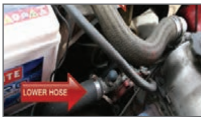
۲ لوله های (شیلنگ) رادیاتور بررسی شود.
