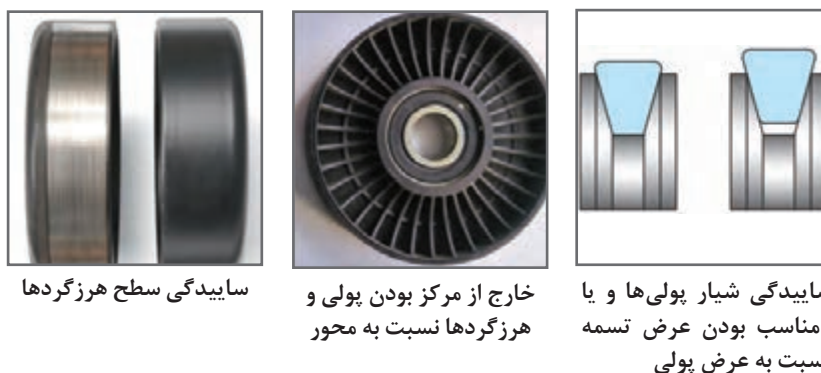
شکل ۱۳- عیوب‌های تسمه‌ها و متعلقات آنها
