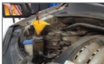
۸ مخزن تا اندازه مجاز دوباره پر شود.
