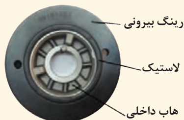
شکل ۹- پولی نوسانگیر (منجیددار)
