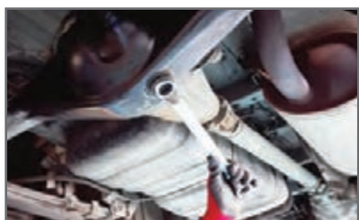
۱ پیچ تخلیه روغن دیفرانسیل باز شود.
