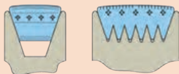
شکل ۵- تسمه دوزنقه‌ای و شیاردار
