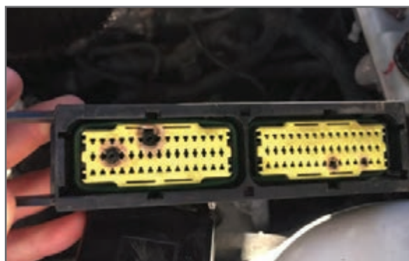
شکل ۲۷- مهم ترین خرابی های کانکتورها
