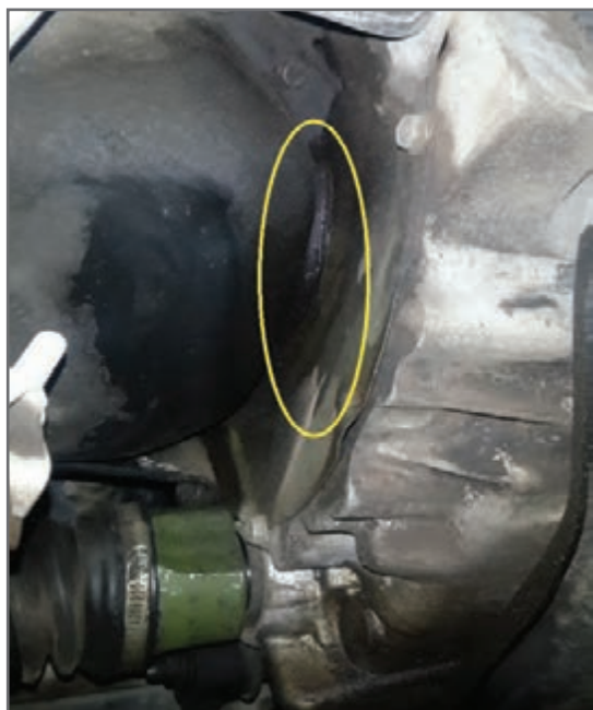
شکل ۶- قرار گرفتن خودرو روی جک بالا بر و دیدن محل های احتمالی نشستی
