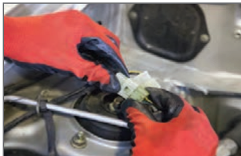
بررسی سفت بودن اتصال کانکتورها به یکدیگر
