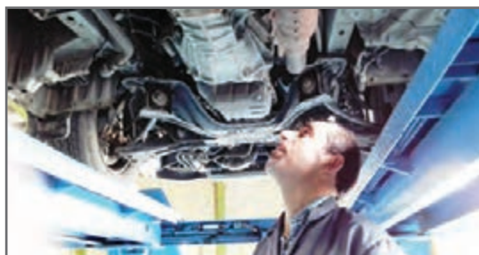
شکل ۶- قرار گرفتن خودرو روی جک بالا بر و دیدن محل های احتمالی نشستی
