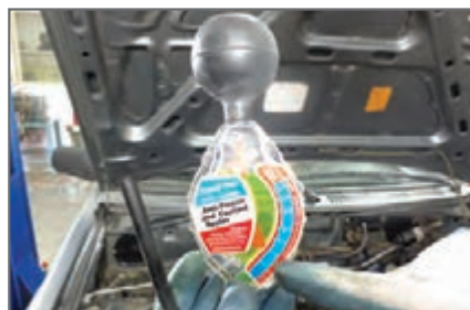
شکل ۸- روش استفاده از هیدرومتر
