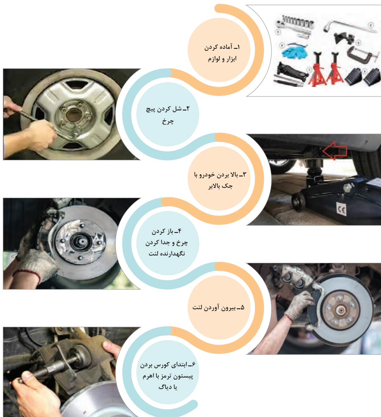
شکل ۶- مراحل باز کردن لنت دیسکی
