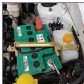
شکل ۳۲- چند نمونه از نگهدارنده‌های باتری
