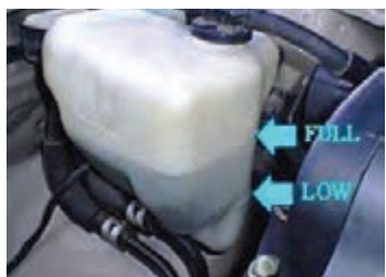
۸ کنار مخزن انبساط دو نشانه Max (full) و Min (low) وجود دارد. سطح مایع باید بین این دو خط باشد.
