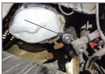
۲ پیچ بررسی سطح روغن باز شود.
