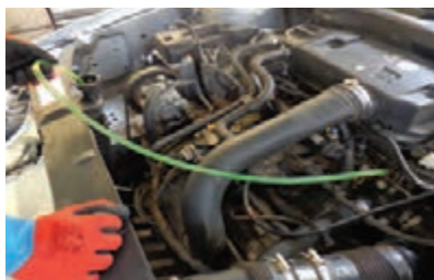
۴ به مایع خارج شده از لوله شفاف توجه شود و هنگامی که مایع بدون حباب از آن خارج شد، پیچ هواگیری سفت و نشتی مدار بررسی شود.
