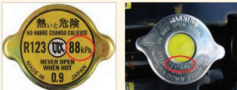
شکل ۲۲- محل نوشته شدن فشار کارکرد روی در چند رادیاتور
