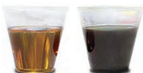
شکل ۴- تفاوت رنگ مایع هیدرولیک ترمز نو و کارکرده
