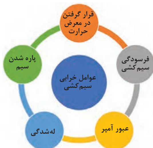
شکل ۱۱- خرابی‌های دسته سیم
