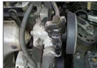
۱ نشتی مخزن مایع هیدرولیک فرمان و پمپ هیدرولیک فرمان بررسی شود.
