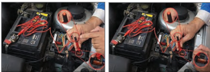
شکل ۱۷- روش بررسی فیوز با تست لامپ مثبت/منفی
