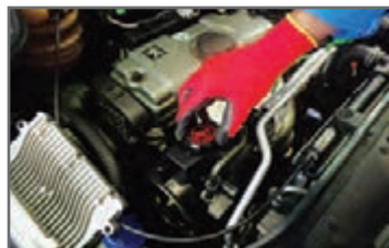
۱ در مخزن مایع هیدرولیک فرمان و شیلنگ برگشت به مخزن باز شده و به مخزن، کورکن بسته شود.
