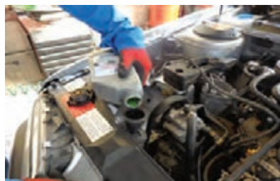
۳ مایع خنک کننده به آرامی از راه دهانه رادیاتور یا مخزن انبساط، افزوده شود.
