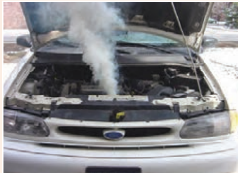
شکل ۱۴- پاشش آب رادیاتور
