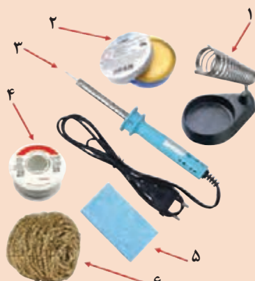
شکل ۲۴- ابزار اصلی لحیم کاری نرم
