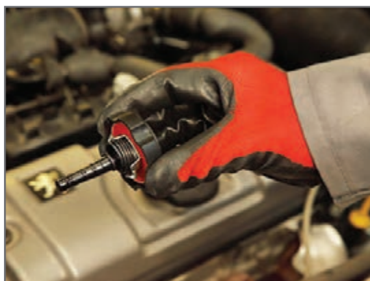
۴ از روی شاخص سطح روی بدنه یا در مخزن، سطح مایع موجود در مخزن بررسی شود. در صورت کم بودن سطح مایع به مرحله نشتی یابی رفته و پس از نشتی یابی به مرحله سرریز مراجعه شود.
