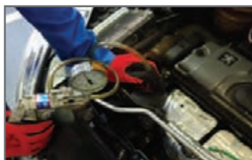
۶ پمپ دوباره روی مخزن بسته شود.
