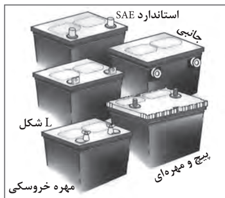
شکل ۳۱- چند نمونه بست باتری و روش اتصال آن به قطب‌ها
