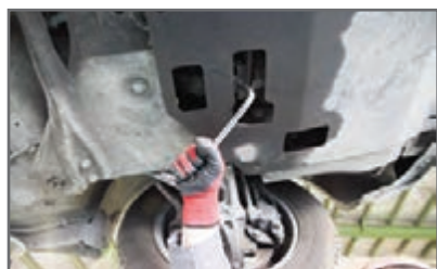
۱ پیچ تخلیه روغن جعبه‌دنده باز شود.
