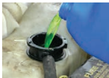
۹ اگر سطح مایع درون مخزن انبساط کمتر از Min باشد با افزودن مخلوط آب و ضدیخ به اندازه مناسب سطح مایع تنظیم شود.
