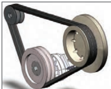
شکل ۲- انتقال توان با تسمه و پولی
