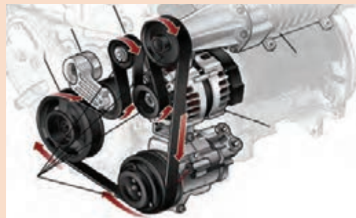
انتقال توان به تجهیزات جانبی با یک تسمه
