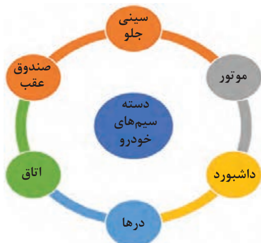
شکل ۵- برخی از دسته سیم‌های مهم در خودرو
