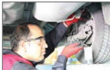
۵ پیچ هواگیری شل شود.
