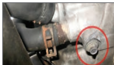
۵ اطراف شیر هواگیری روی موتور بررسی شود.
