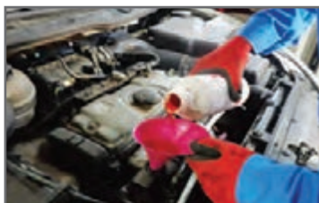
۸ پس از جداکردن پمپ، سطح مایع مخزن بررسی شده و در صورت لزوم روغن افزوده شود.
