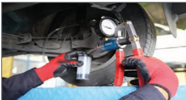
شکل ۱۲- نمونه‌ای از دستگاه خلأی هواگیری سیستم ترمز
