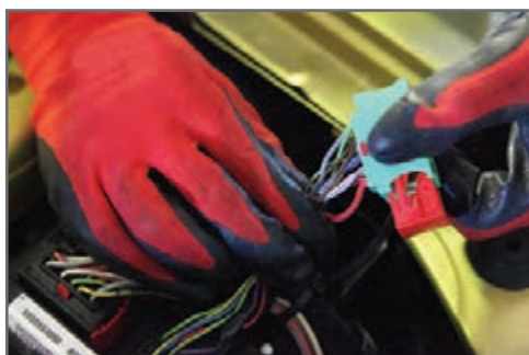
سفت بودن اتصال سیم‌ها به کانکتورها
