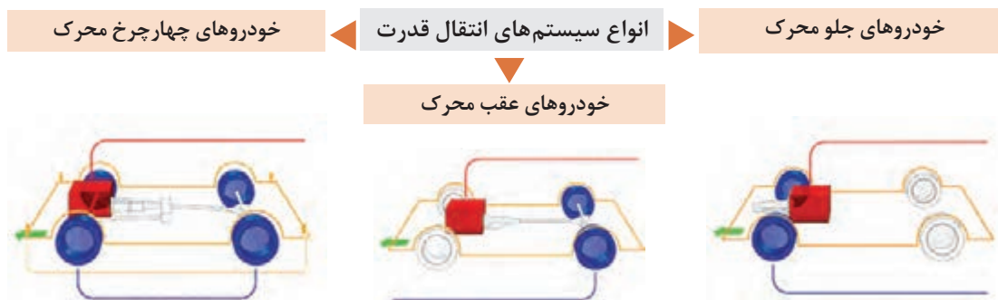
شکل ۴۷- اجزای اصلی سیستم انتقال قدرت
