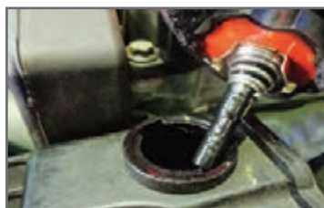
۵ پمپ از مخزن جدا شود و سطح مایع مخزن بررسی شده، در صورت لزوم روغن افزوده شود.
