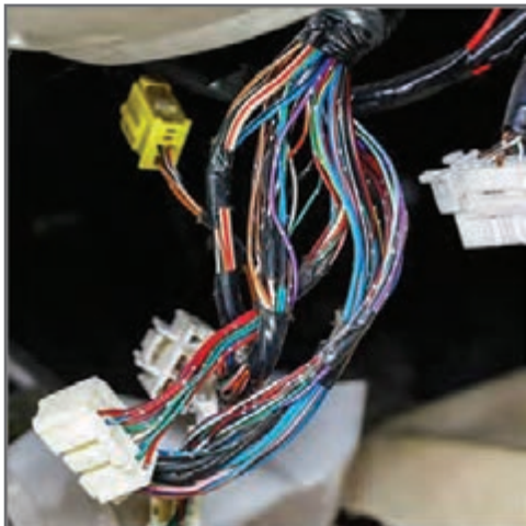
شکل ۷- کاربرد رنگ‌بندی برای شناسایی سیم
