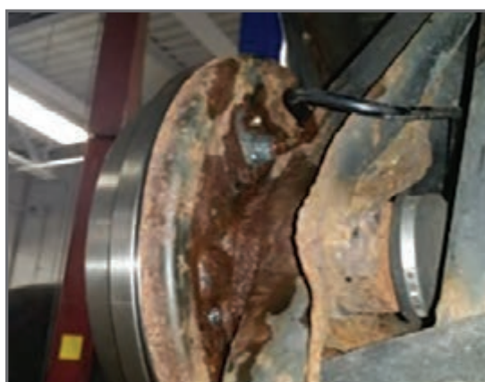
شکل ۱۱- بررسی لنت و کاسه چرخ
