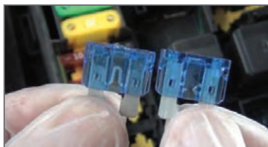
شکل ۱۶- مقایسه فیوز تیغه‌ای سالم و سوخته
