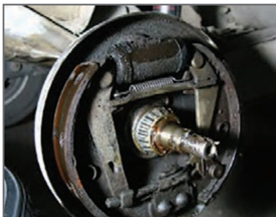
شکل ۱۱- بررسی لنت و کاسه چرخ
