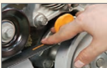
شکل ۱۴- گوشی مکانیکی (استاتسکوپ) و ابزار بررسی فاصله تسمه و شیار پولی
