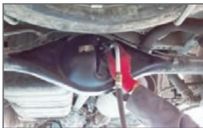
۲ روغن با پمپ دستی، برقی یا بادی پر شود و پیچ ورودی بسته شود.
