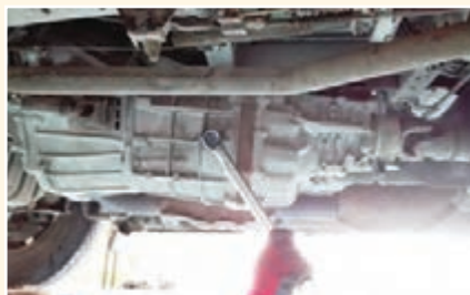
شکل ۴- روش بررسی سطح و رنگ روغن جعبه‌دنده عقب محرك
