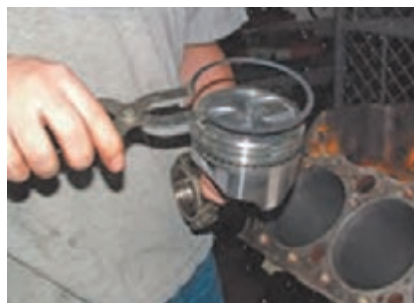
جا زدن رینگ روی پیستون با ابزار
