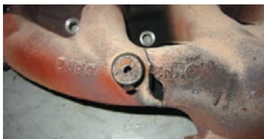
پ) شکستگی مانیفولد خروجی (چدنی)
