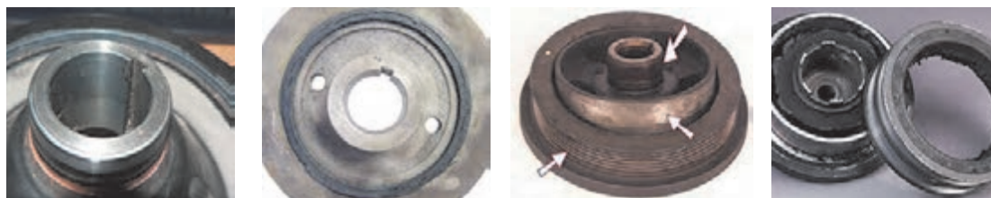
پ) ساییده شدن جای قرارگیری کاسه نمد
