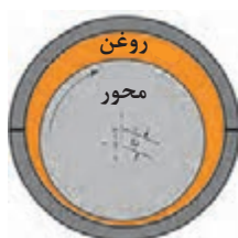
الف) لایه روغن بین یاتاقان و میل‌لنگ
