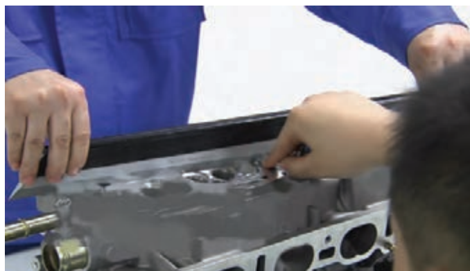
شکل ۹۱- بررسی تابیدگی سرسیلندر با فیلر خط کشی مخصوص
