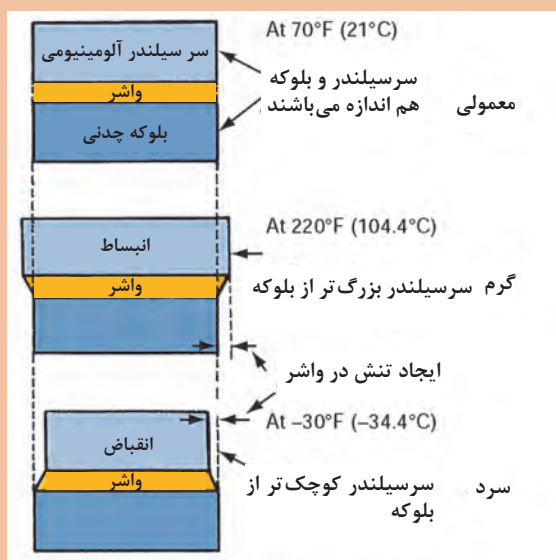
شکل ۹۹- اثر جنس واشر سرسیلندر
