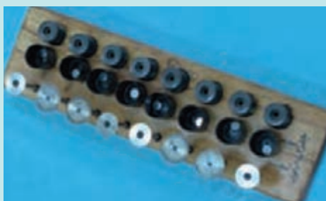
(پ) حفظ ترتیب تایپیت ها و شیم های سوپاپ شکل ۵۸- باز کردن اجزای سرسیلندر
