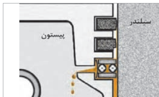
شکل ۱۶- وظایف رینگ‌های پیستون
