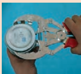
رینگ بازکن پیستون و بیرون آوردن رینگ
