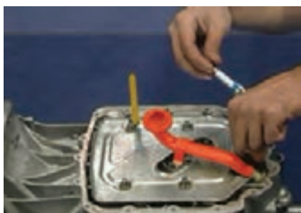
(الف) باز کردن پیچ های کارتر (ب) باز کردن صافی روغن ورودی به پمپ
