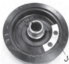
الف) بستن وزنه روی پولی برای بالانس
