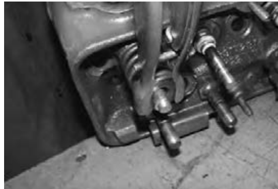
شکل ۶۰- تنظیم گیره نگهدارنده بشقابک سوپاپ در فنر سوپاپ جمع کن
