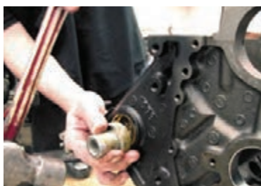
ب) ابزار مخصوص و روش جازدن پولکی
