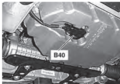
شکل ۱۰- حسگرهای سطح و دمای روغن موتور
