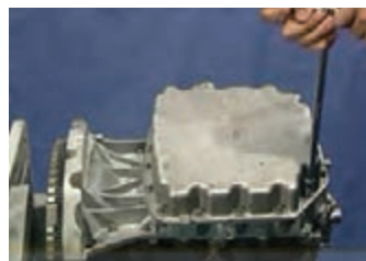
(الف) باز کردن پیچ های کارتر (ب) باز کردن صافی روغن ورودی به پمپ
