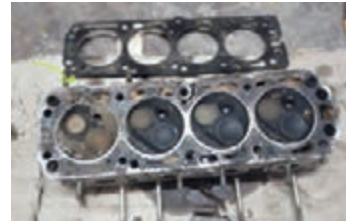
الف) سوختن واشر سرسیلندر و ورود مایع خنک کننده به سیلندر ۱
