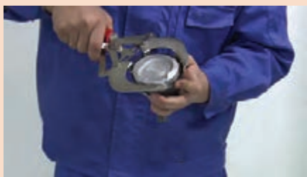
رینگ بازکن پیستون و بیرون آوردن رینگ
