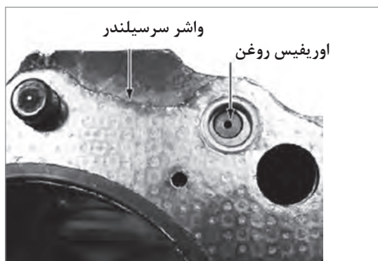
شکل ۱۲- اوریفیس مدار روغن کاری
