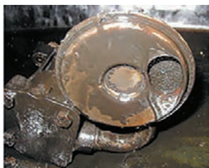
شکل ۳۶- صافی پمپ روغن جرم گرفته
