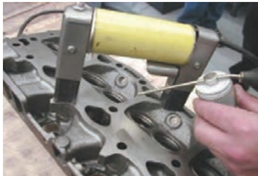
(الف) بررسی با دستگاه ترک یاب مغناطیسی
