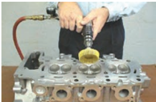
ب) کاربرد دریل پنوماتیکی با سنباده در رسوب‌زدایی اتاق احتراق و کف سرسیلندر
