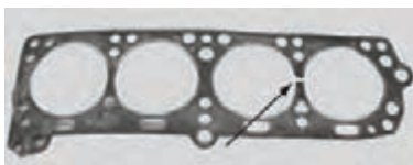
واشر سرسیلندر سوخته (معیوب)
