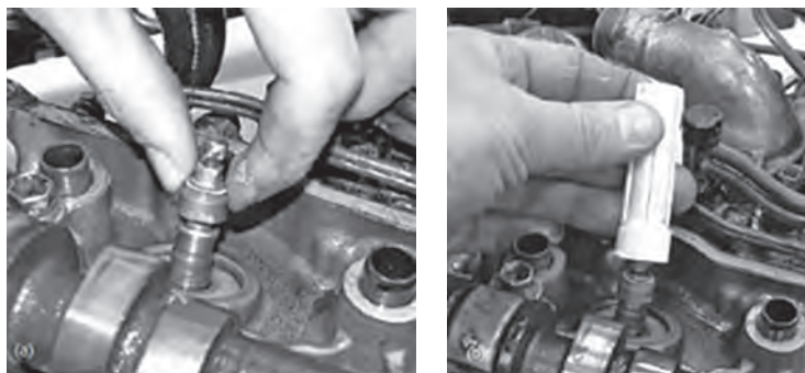
ب) روش جازدن کاسه نمد راهنمای سوپاپ
