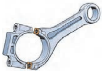
شکل ۲۴- شاتون خارج از محور
