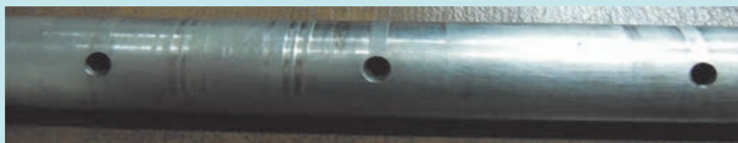
شکل ۹۲- کانال روغن در میل اسبک
