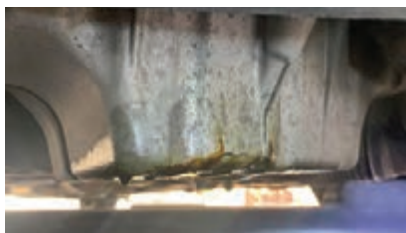
بررسی ترک و شکستگی کارتر
