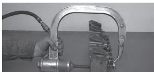
(الف) فنر سوپاپ جمع کن پنوماتیکی
