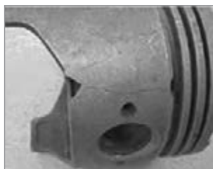
شکستگی دامنه پیستون
