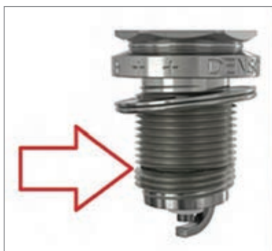
شکل ۷۲- بررسی رزوه های سرسیلندر
