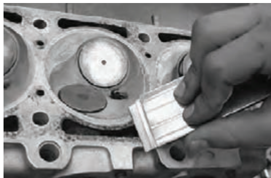
الف) رسوب‌زدایی کف سرسیلندر و اتاق احتراق
