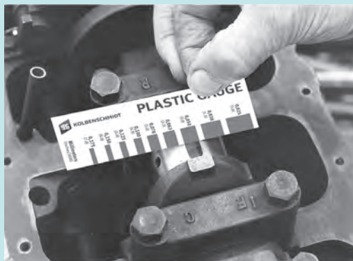
شکل ۹۸- بررسی قطر یاتاقان متحرک با پلاستی گیج
