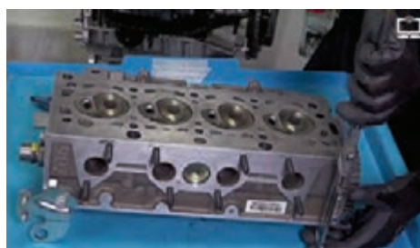
شکل ۷۰- اندازه‌گیری ارتفاع سرسیلندر با ابزار اندازه‌گیری دقیق
