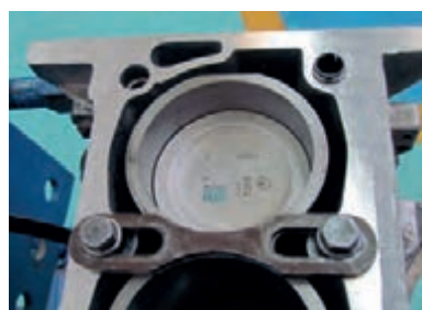
جازدن پیستون در سیلندر
