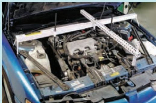
شکل ۴۹- بستن نگهدارنده موتور
