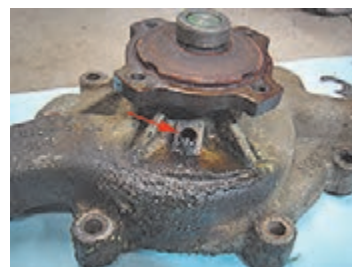
ت) شکستگی پایه‌ها
