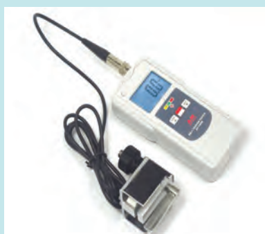
شکل ۳۱- دستگاه کشش سنج تسمه تایم
