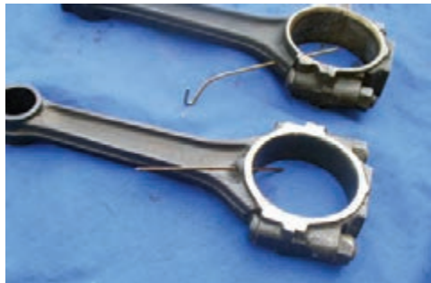
الف) سوراخ روغن پاش به کف پیستون و روغن کاری بوش گژن پین
