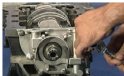
(ب) باز کردن پیچ های پمپ روغن
