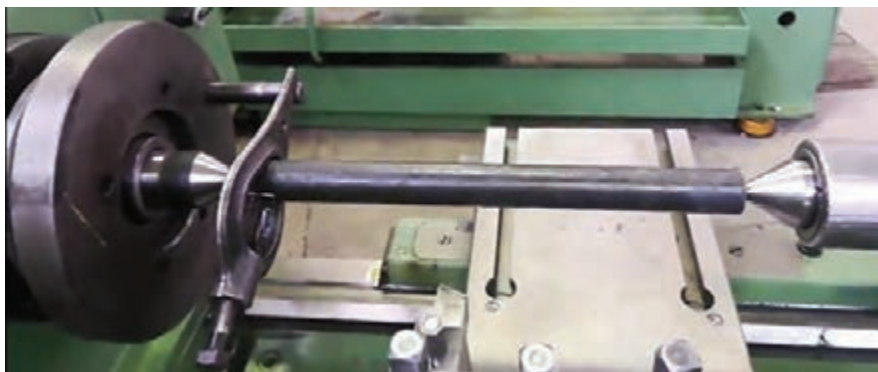
شکل ۲۸- لنگ تراشی بین دو مرغک
