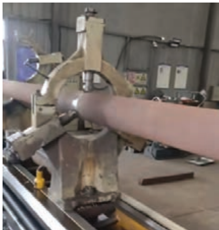
شکل ۶- استفاده از کمربند ثابت با فک‌های غلتشی
