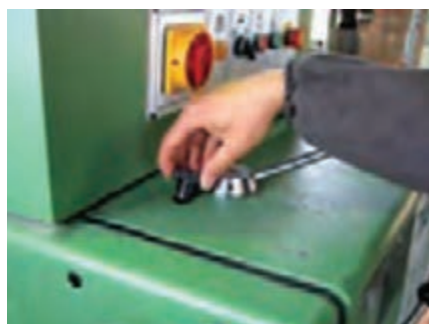
شکل ۲۶- درپوش آج دار (محل ریختن روغن سر دستگاه)
