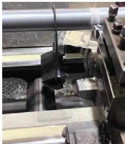
شکل ۹- الصاق وزنه به منظور جذب ارتعاش
