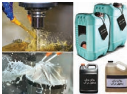
شکل ۲۵- انواع خنک‌کننده‌ها (مایعات برش و امولسیون‌ها) و الگویی برای نگهداری اصولی مواد مصرفی
