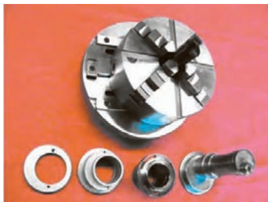
شکل ۲۴- چهار نظام قابل تنظیم و قطعات تولید شده
