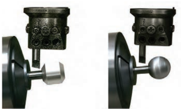
شکل ۳۳- سمت چپ ( شروع ) کره‌تراشی با مته لنگ روی دستگاه فرز - سمت راست کره تراشیده شده به وسیله مته لنگ
