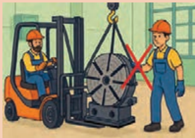
حمل میز گردان فرز با جرثقیل
