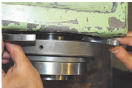
شکل ۳۷- خارج کردن نیم‌واشرها
