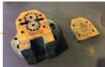
پمپ روغن (معیوب)
