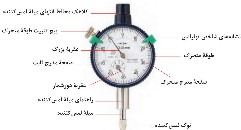
شکل ۱۶- اجزای ساعت اندازه گیری
