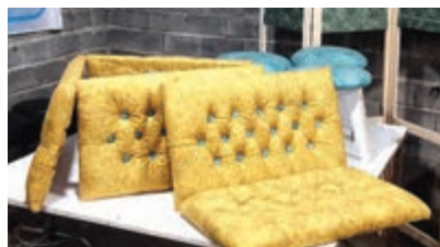
شکل ۷۹- تکمیل تعدادی از قطعات دیوارپوش برای اجرا در یک دیوار
