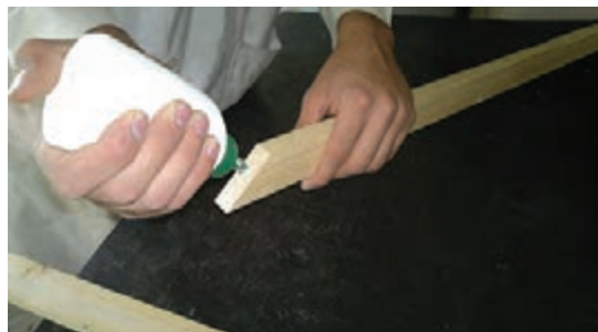
شکل ۳۴- چسب زدن سر قطعات
