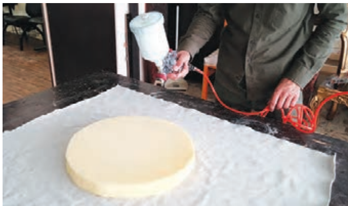
شکل ۷۳- پاشیدن چسب با پیستوله
