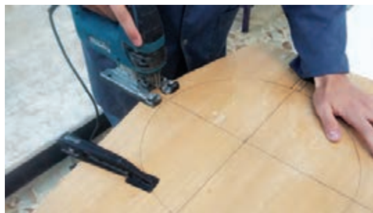
شکل ۴۳- برش کاری از محل اتصال پایه‌ها
