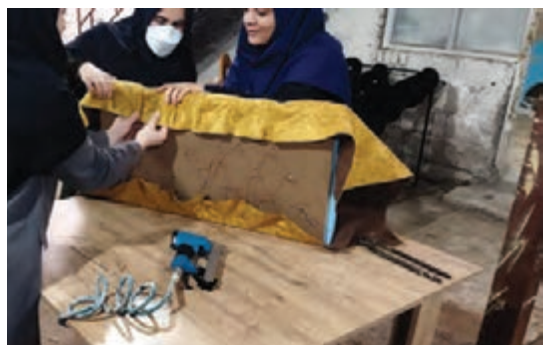
شکل ۷۳- تنظیم خطوط پارچه در پشت
