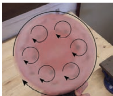
شکل ۲۱- حرکت مداری پد سنباده اوربیتال
