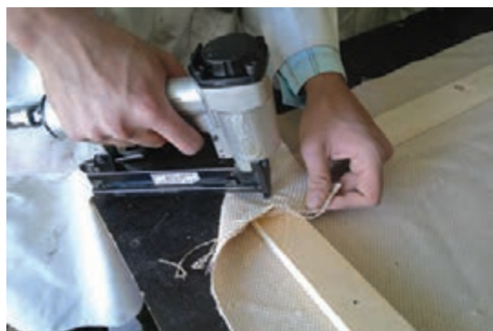
شکل ۴۲- منگنه زدن گوشه قاب
