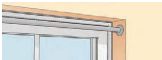
شکل ۱۰۶- نصب میله در داخل یا خارج چارچوب پنجره
