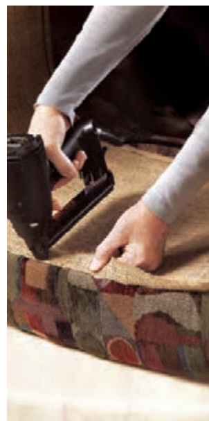
شکل ۱۴۸- نصب گونی در زیر نیمکت
