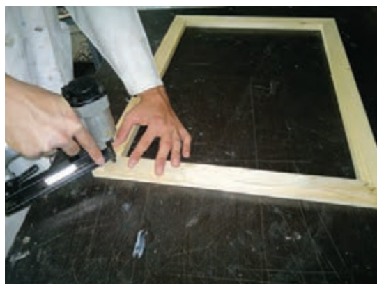
شکل ۳۸- منگنه زدن پشت قاب
