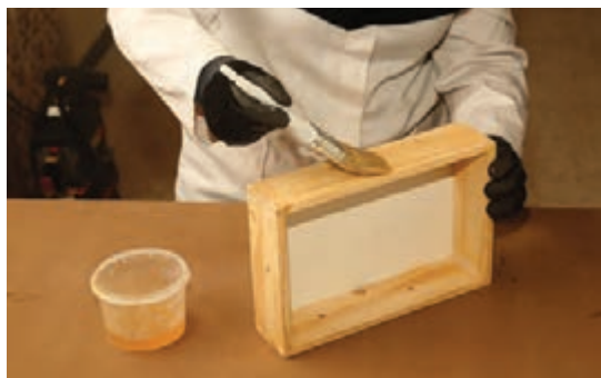
شکل ۲۳۱- زدن سیلر به سطوح جعبه با قلم مو
