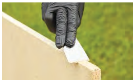
شکل ۷- بتونه کاری لبه چوب با کاردک
