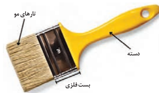
شکل ۸۰- قلم‌مو و قسمت‌های مختلف آن
