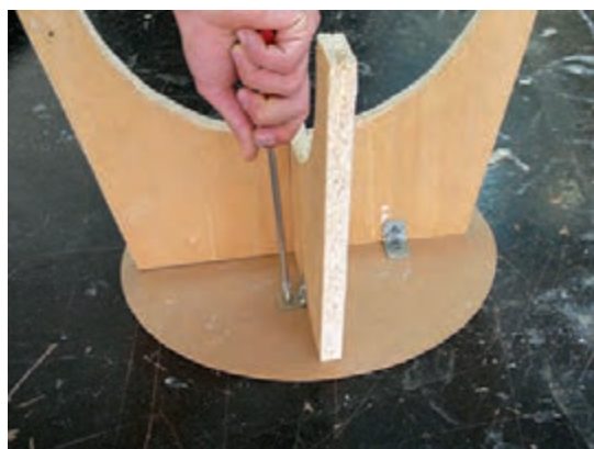
شکل ۵۴- مراحل مونتاژ چهارپایه
