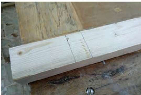
شکل ۳۴- اندازه‌گیری و خط‌کشی محل نصب قید پایین پاراوان
