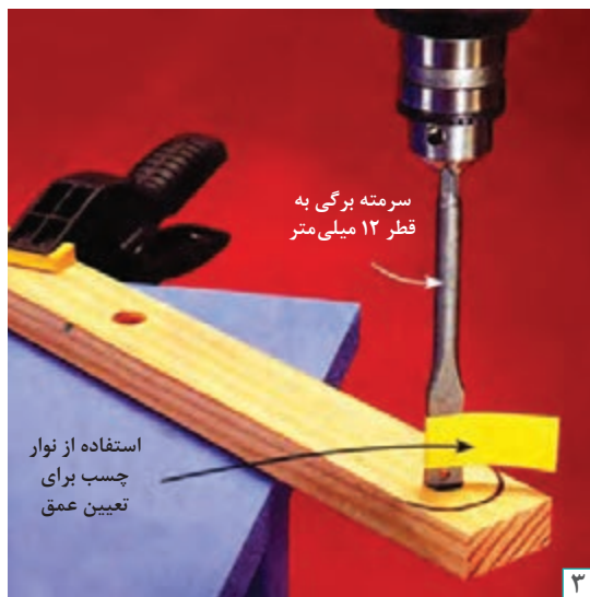
شکل ۱۱۱- سوراخ‌کاری با مته برگی
