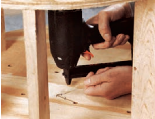
شکل ۱۱۸- ثابت کردن نخ لمسه از پشت تخته
