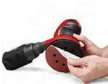
شکل ۴۱- تعویض سنباده ماشین اوریبتال
