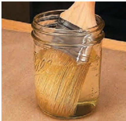
شکل ۹۰- فشردن قلم‌مو برای خروج رنگ اضافی
