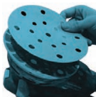
شکل ۲۷- تنظیم سوراخ های سنباده
