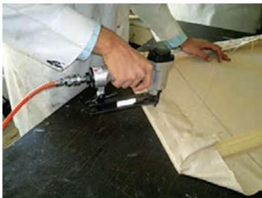
شکل ۴۶- منگنه زدن وسط قاب در ضلع دیگر
