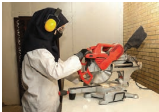
شکل ۲۰۶- اندازه‌بری با اره فارسی بر
