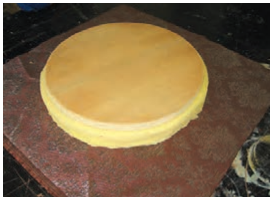
شکل ۹۹- قرار دادن تخته چسبیده به فوم در وسط پارچه
