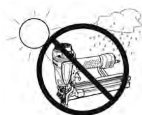
شکل ۹۱- محافظت شیلنگ هوا از بارش برف و باران و تابش خورشید
