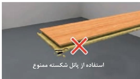
شکل ۶۶- اشتباهات رایج در اجرای کف پوش لمینت
