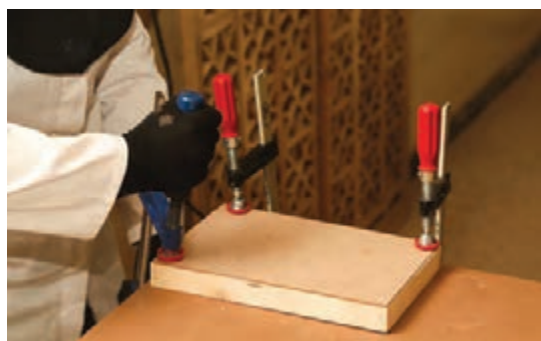
شکل ۲۱۸- در حال بستن سقف جعبه با پیچ دستی
