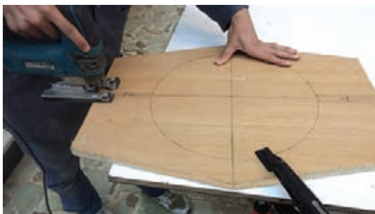
شکل ۴۴- برش شکاف وسط پایه‌ها
