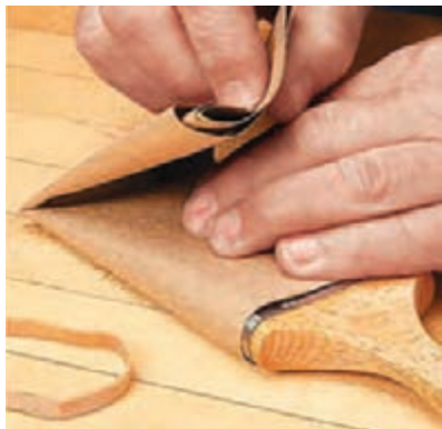
شکل ۹۳- پیچیدن قلم‌مو در کاغذ ضخیم
