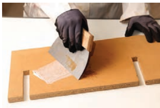
شکل ۱۸۷- بتونه کاری سطح
