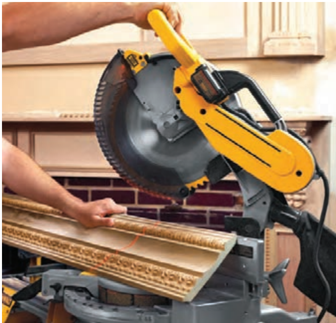
شکل ۵۱- برش عرضی یک قطعه لمینت روی خط لیزر
