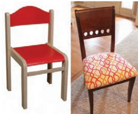
شکل ۶۹- دو نوع صندلی از نظر قرارگرفتن کف بر روی قیدها و داخل قیدها
