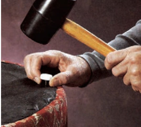
شکل ۱۲۶- نصب پایه زیر کف
