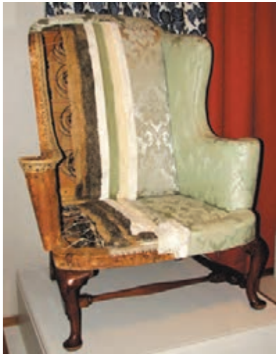
شکل ۵۶- مبل برش خورده با فنرهای کف
