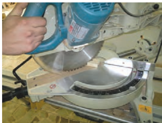
شکل ۳۰- برش فارسی یا ۴۵ درجه با اهر فارسی بر
