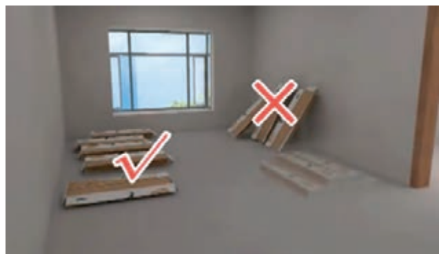
شکل ۲۷- روش درست و غلط استقرار بسته‌های لمینت
