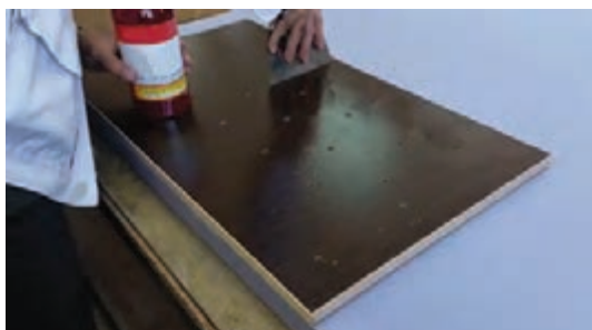
شکل ۶۲- چسب زدن روی تخته با کاردک
