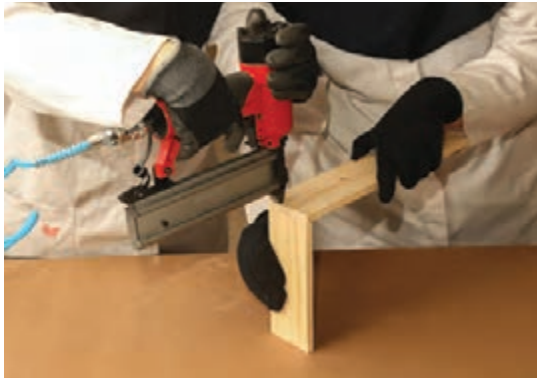
شکل ۲۱۰- میخ زدن قطعات چسب خورده
