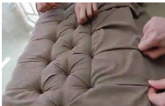
شکل ۷۲- تنظیم خطوط لمسه از رو
