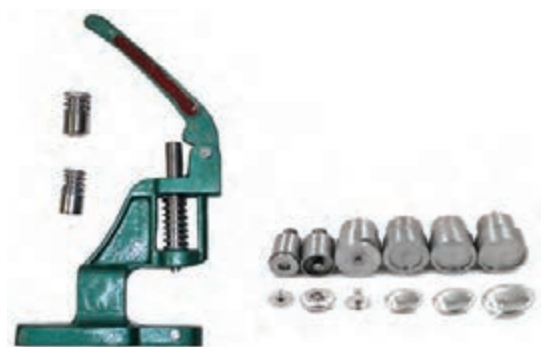
شکل ۷۵- دستگاه پرس دستی دکمه قابلمه
