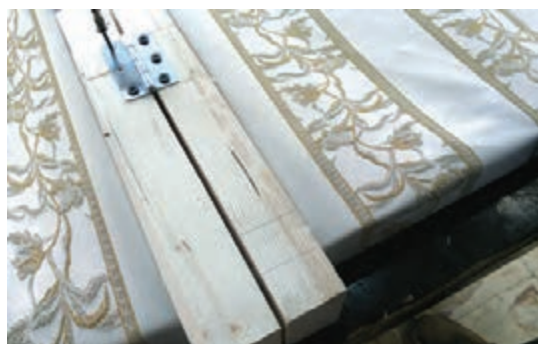
شکل ۵۶- بستن پیچ دوم برگه دوم لولا
