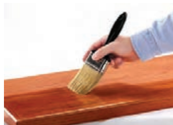
شکل ۱۰۸- زدن سیلر با قلم‌مو
