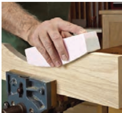
شکل ۴۵- سنباده کاری داخل قوس با بلوک
