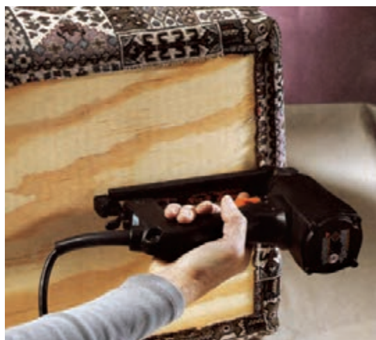
شکل ۹۳- نصب پارچه در زیر صندوقچه
