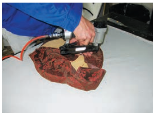
شکل ۱۰۰- منگنه زدن دو طرف پارچه در مقابل هم
