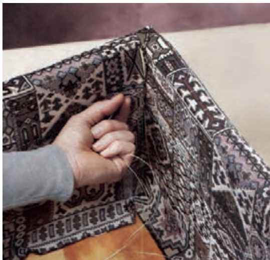
شکل ۹۵- دوختن درز گوشه با سوزن و نخ
