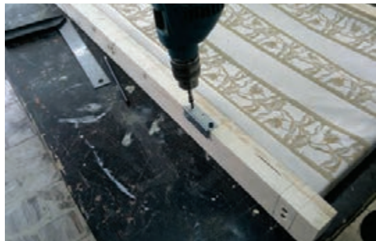
شکل ۵۳- بستن پیچ دوم
