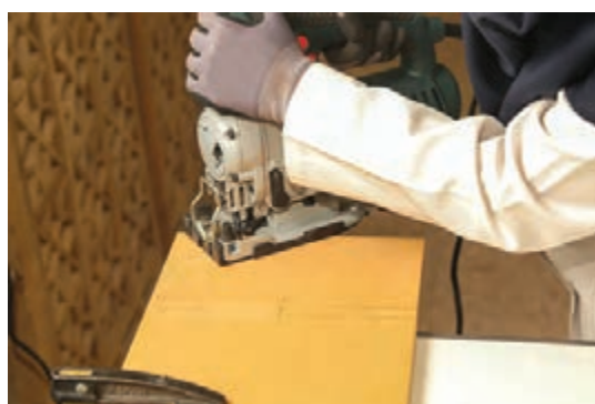
شکل ۱۷۷- قوس‌بری با اره عمودبر
