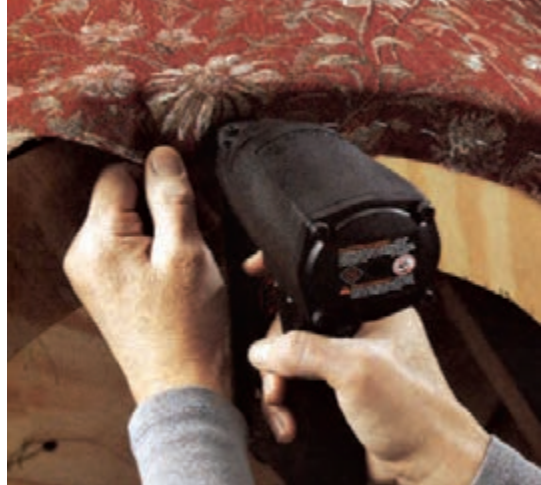
شکل ۱۲۵- کشیدن و کوبیدن پارچه زیر کف
