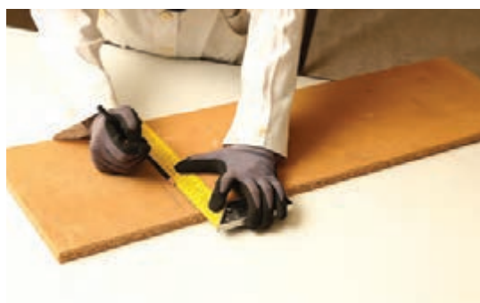
شکل ۱۷۵- به دست آوردن مرکز قوس
