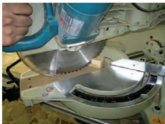
شکل ۳۲- بریدن دو قطعه با هم
