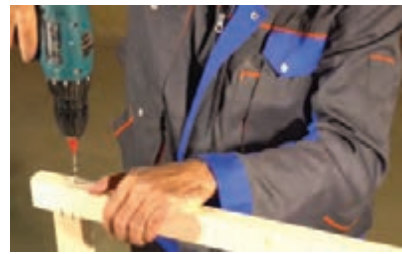
شکل ۴۵- سوراخ کاری محل پیچ اول
