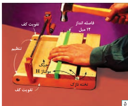
شکل ۱۱۳- سرهم کردن با جیگ مونتاز
