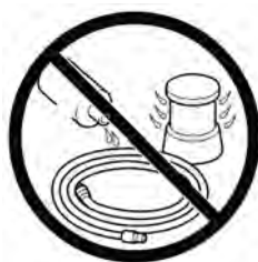
شکل ۹۳- محافظت شیلنگ هوا در مقابل شعله مستقیم و مواد شیمیایی
