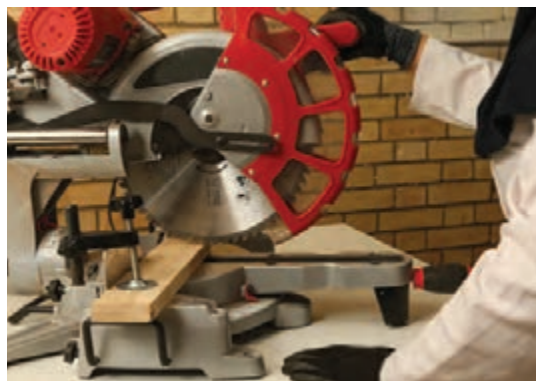
شکل ۲۰۷- برش دو قطعه روی هم
