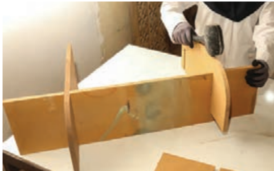
شکل ۱۸۳- مونتاژ با ضربه آرام چکش لاستیکی
