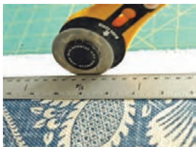
شکل ۲۰- برش پارچه با کاتر دوار
