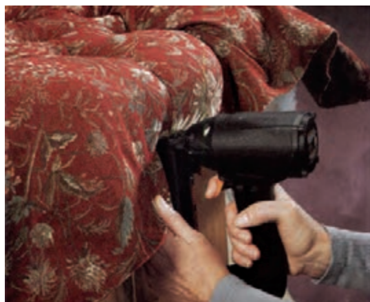
شکل ۱۲۱- منگنه زدن لبه پایین
