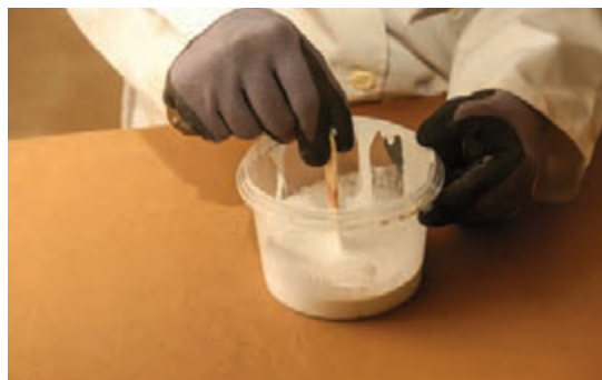
شکل ۱۹۳- به هم زدن ترکیب رنگ و تینر با چوب بستنی
