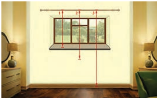
شکل ۸۷- اندازه گیری در سه موقعیت
