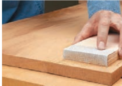
شکل ۴۹- سنباده کاری با تخته سنباده
