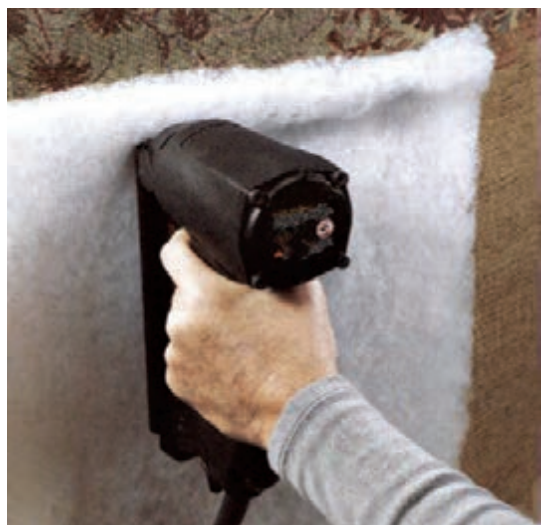
شکل ۱۲۴- نصب لایی با الیاف مصنوعی
