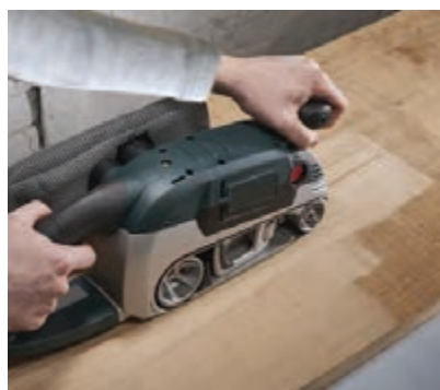
شکل ۱۹- حرکت سنباده در جهت الیاف چوب
