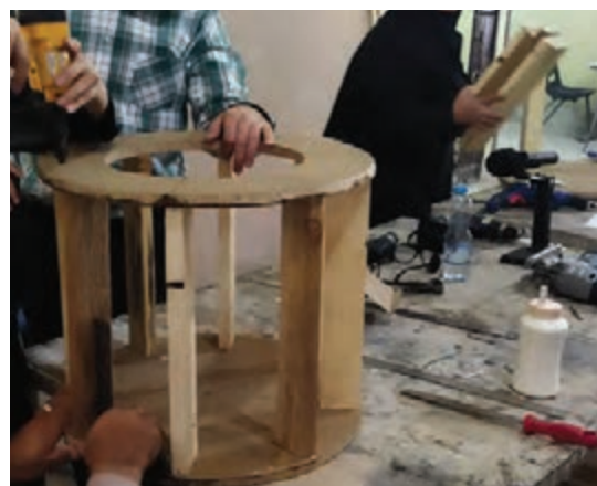
شکل ۱۰۸- مونتاژ کلاف پاف با تفنگ میخ کوب
