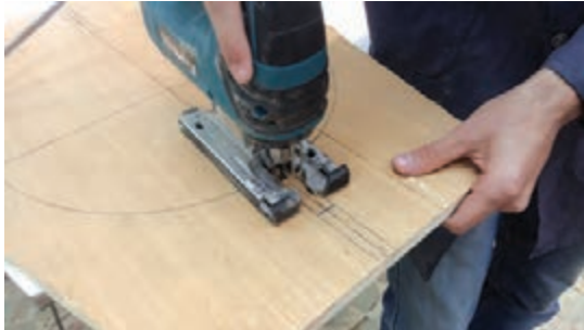
شکل ۴۶- شروع برش کفی دایره شکل از محل شکاف پایه‌ها
