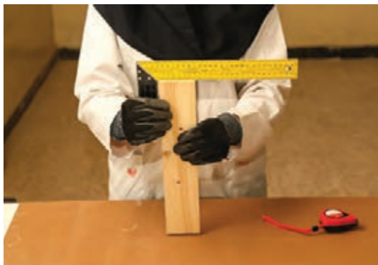
شکل ۲۰۴- بررسی گونیایی بودن قطعات
