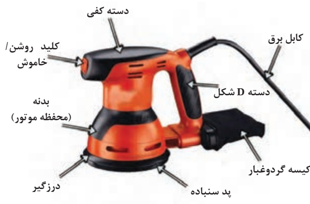
شکل ۲۲- قسمت‌های مختلف ماشین سنباده زن گرد لرزان
