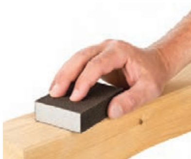
شکل ۴۳- سنباده کاری با بلوک سنباده
