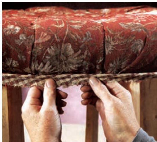
شکل ۱۲۷- اندازه‌گیری و نصب سرمه
