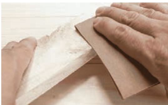
شکل ۳۴- آزمایش سنباده روی یک ناحیه کوچک
