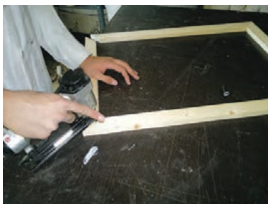
شکل ۳۷- منگنه زدن گوشه‌های دیگر قاب
