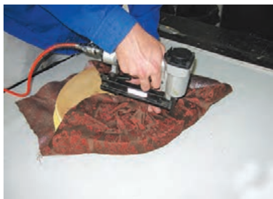
شکل ۱۰۱- منگنه زدن چهارطرف و ثابت کردن پارچه
