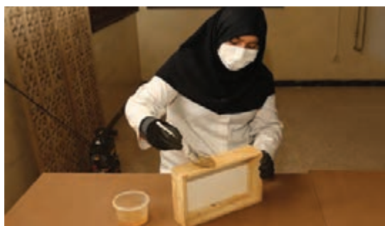
شکل ۲۳۷- زدن کیلر به سطوح
