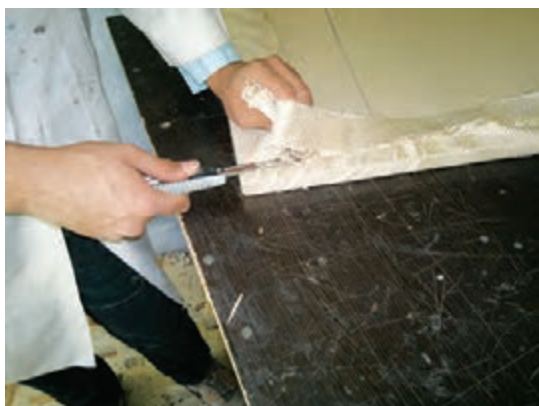
شکل ۴۸- برش پارچه اضافه با کاتر
