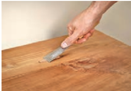
شکل ۴۷- صاف کردن سطح بتونه
