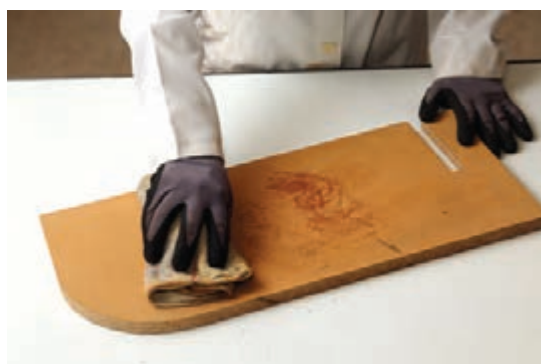
شکل ۱۸۶- پاک کردن غبار سنباده از سطوح با پارچه
