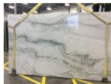
شکل ۳۰- نحوه جابه جایی سنگ اسلب
