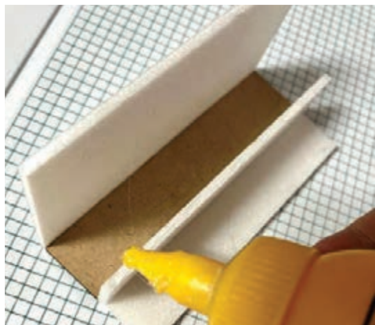
شکل ۱۳۸- چسباندن قطعات داخلی کابینت ها
