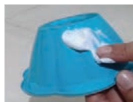
شکل ۱۱۵- آغشته کردن مدل با ماده جداکننده (مایع ظرفشویی یا وازلین)
