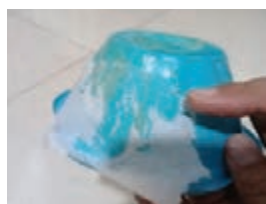
شکل ۱۱۷- گذاردن لایه‌های دستمال کاغذی آغشته به چسب سریشم روی قالب
