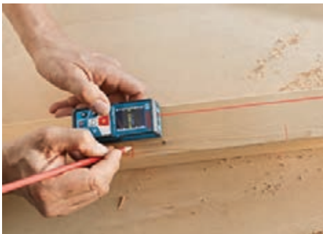
اندازه‌گیری با متر لیزری
