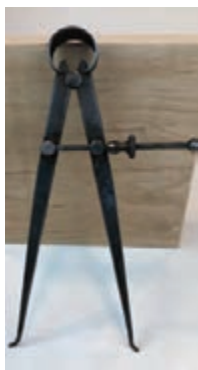
پرگار پاشنه‌ای برای اندازه برداری و اندازه گیری و انتقال اندازه‌های داخلی قطعه کار
