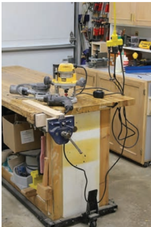
استفاده از پریز سقفی (منظم بودن سیم‌ها)
