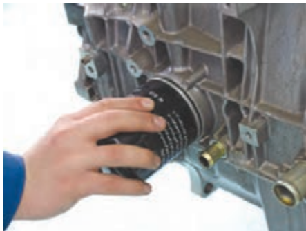
شکل (۲-۵۴) نصب و محکم کردن فیلتر
