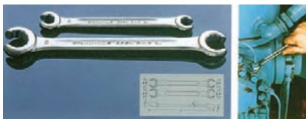
شکل (۱-۱۵) دو نوع آچار رینگی خاص
