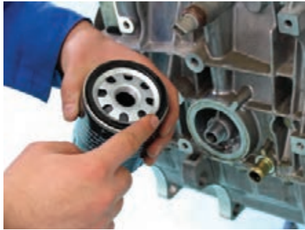
شکل (۲-۵۳) کنترل دندانه و واشر لاستیکی فیلتر
