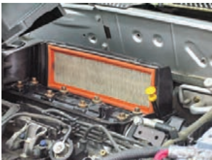
شکل (۲-۶۲) فیلتر سیستم هوارسانی
