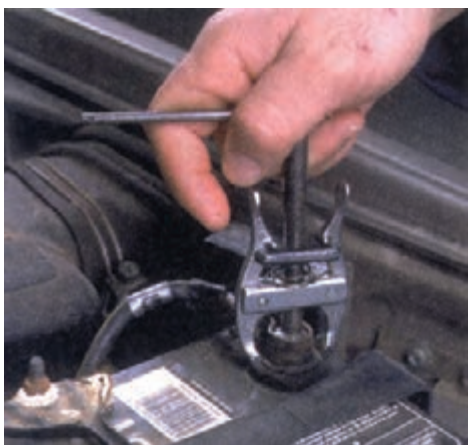
شکل (۸۲ - ۲) باز کردن بست باتری
