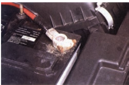
شکل (۸۱ - ۲) سولفاته شدن بست باتری
