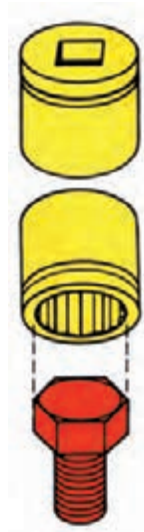
شکل (۱-۱۷) نحوه درگیری آچار بوکس
