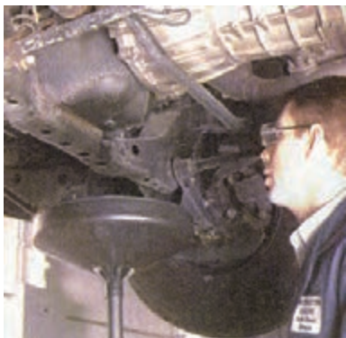
شکل (۲-۵۵) کنترل تخلیه شدن کامل روغن
