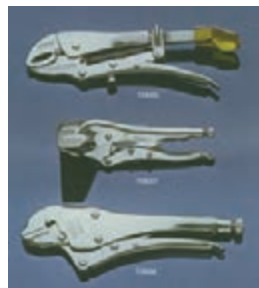
شکل (۱-۲۴) انواع انبر قفلی
