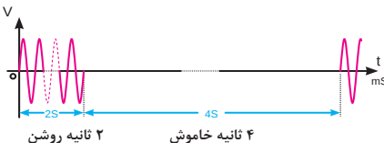
شکل ۸۴ - مشخصات سیگنال بازتاب زنگ
