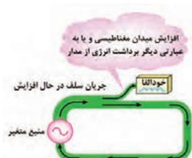
شکل ۲۶ - ذخیره انرژی در سیم پیچ
