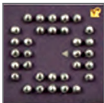
شکل ۲۱- تصویر ظاهری انواع پکیج‌های BGA
