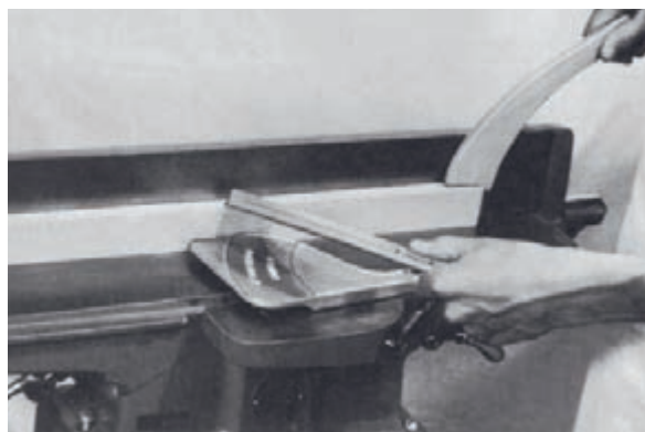
شکل ۱۷-۴ الف - رنده کردن انتهای چوب‌های باریک.
