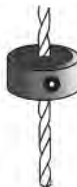
شکل ۱۹-۵۳- قطعه به‌جای میله‌ی عمق سنج.
