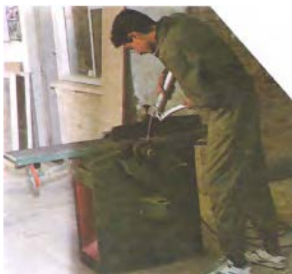
شکل ۱۴-۶- گریس‌کاری یاتاقان‌های توپی رنده.
