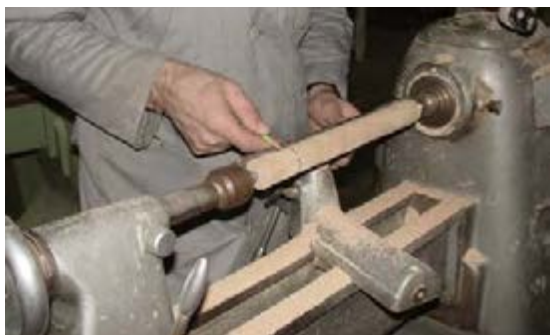
شکل ۱۱-۵۶. نمونه علامت‌گذاری و تعیین اندازه
