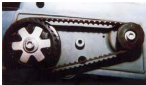
شکل ۹-۱۴- وضعیت قرار گرفتن تسمه روی پیرغ‌دنده.
