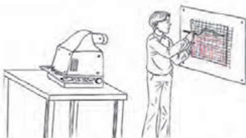
شکل ۱۶-۱۸. استفاده از پروژکتور اوپک برای بزرگنمایی.
