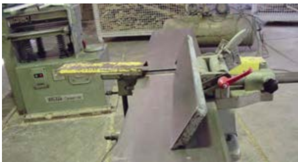
شکل ۳۴-۴- تنظیم زاویه ۴۵ درجه گونیای رنده.
