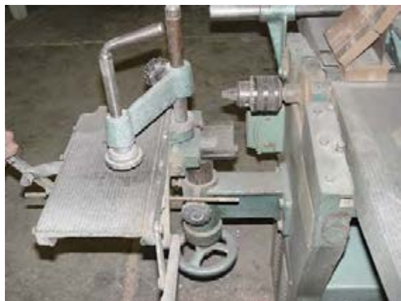
شکل ۹-۲ - ماشین سه کاره شامل: کُم کنی، رنده و
