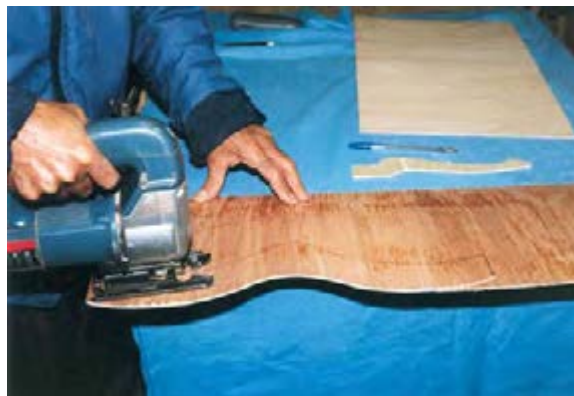
شکل ۱۸-۲۱. برش تخته سه‌لایه با توجه به طرح الگو.
