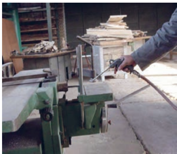
شکل ۱۰-۱۱- غبارگیری قطعات ماشین.
