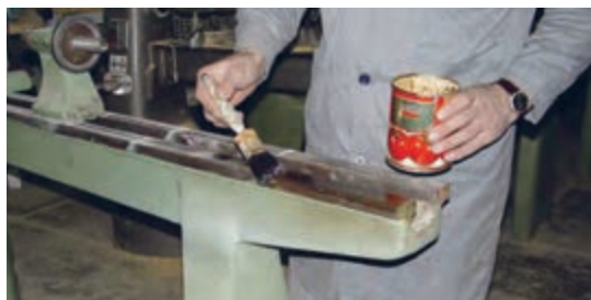
شکل ۱۱-۴۵- تمیزکاری قسمت‌های ضروری و بدون رنگ ماشین.
