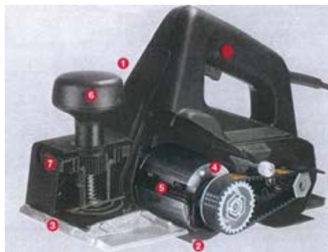
شکل ۱۰-۱۴- وضعیت تسمه و چگونگی نصب آن روی توپی. به اهرم بالای تسمه توجه کنید.
