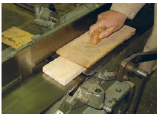
شکل ۱۷-۴ ب - رنده کردن چوب‌های کم ضخامت.
