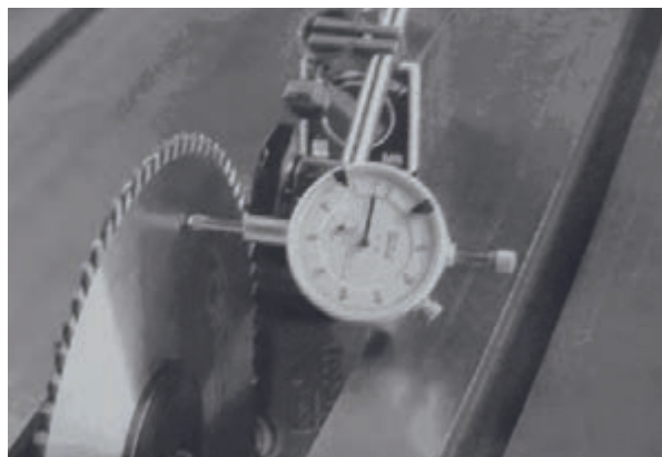
شکل ۱۲-۲۴- کنترل لنگی تیغه با دستگاه لنگی سنج.
