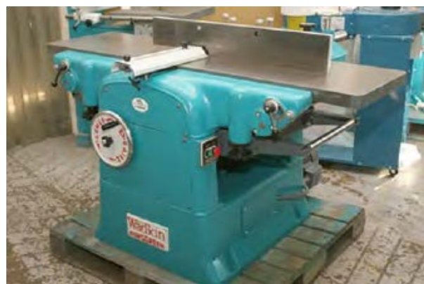
شکل ۴-۴- ماشین کفررند با بدنه چدنی.
