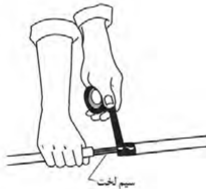
شکل ۱۹-۲۸. پوشش با چسب برق.
