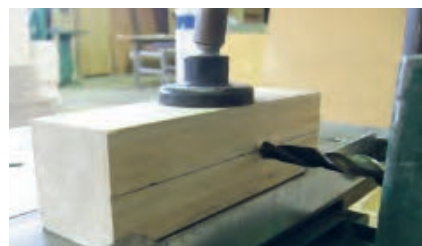
شکل ۹-۱۸- تنظیم نیش مته با فط وسط چوب.
