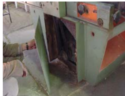
شکل ۱۴-۴- مفاظ الکتروموتور و تسمه‌ها.
