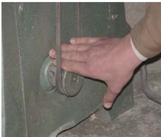
شکل ۱۰-۶- مراقبت از انگشتان به هنگام تعویض تسمه.
