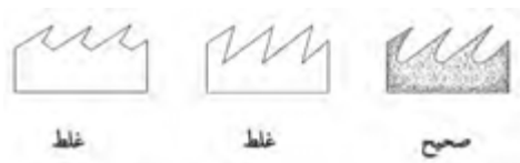
شکل ۱-۶۸-۱. فرم‌های مختلف تیز شدن ته دندان.
