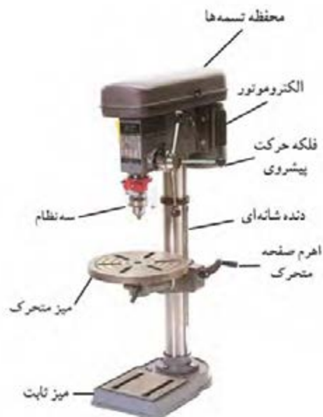
شکل ۱۹-۴- دریل ستونی پایه‌دار و قسمت‌های آن.
