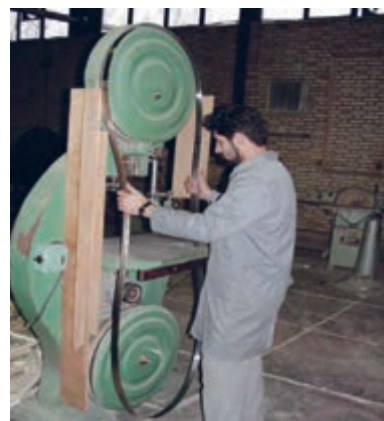
شکل ۶-۲- نمونه‌ی جا انداختن تیغه اره.
