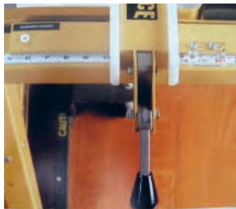
شکل ۱۲-۲۳- تنظیم اندازه ی برش.
