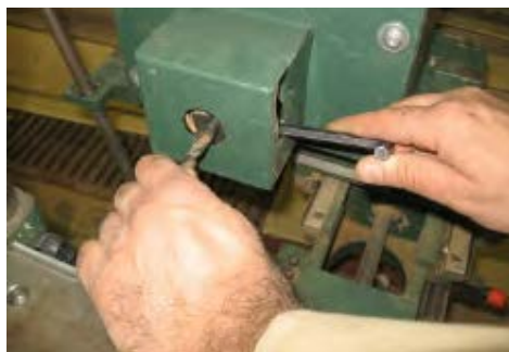
شکل ۹-۱۷- ممکن کردن مته داخل سه‌نظام.
