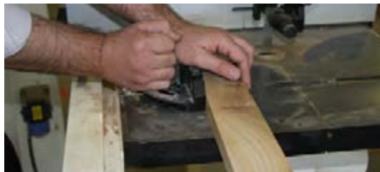
شکل ۱۳-۱- گونای متغیر و مدرج، برای برش عرضی.
