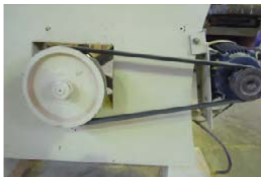
شکل ۳-۱۷. استقرار تسمه در داخل چرخ تسمه.
