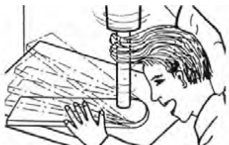
شکل ۱۹-۲۶- درگیر شدن مته با موی سر.
