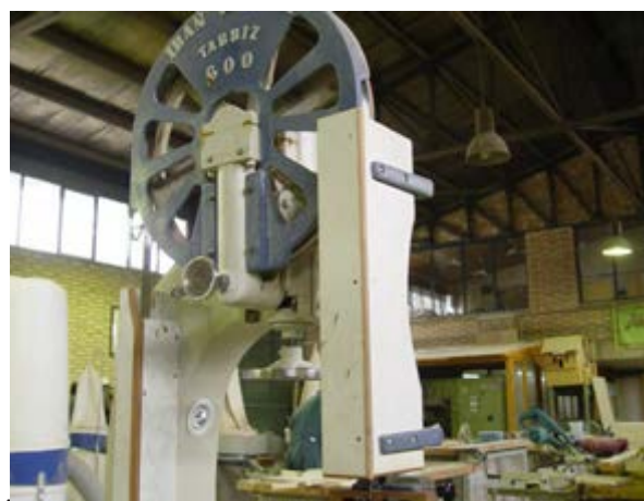
شکل ۱۰-۱ حفاظ‌های روی تیغه مد فاصل بین دو فلکه
