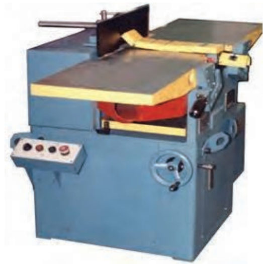
شکل ۳۳-۴- ماشین رنده با حفاظ.
