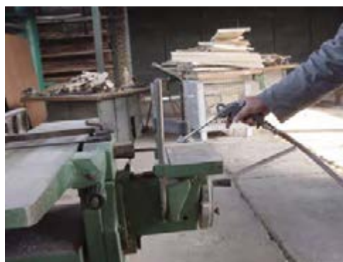
شکل ۱۹-۱۰- غبارگیری ماشین کُمن کنی.
