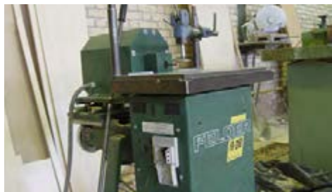
شکل ۹-۹ - گیره، برای محکم کردن چوب (روی صفحه).
