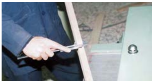
شکل ۳۸-۷- کنترل مرزله‌ای، جهت اطمینان از صحت اندازه.
