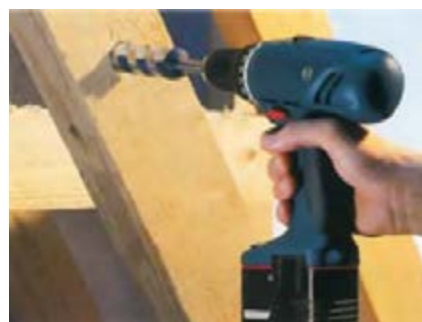
شکل ۱۹-۹- دریل شارژی برای مکان‌هایی که برق در آنجا وجود ندارد.
