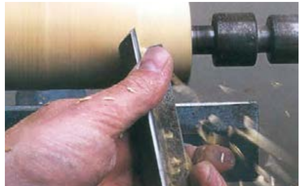
شکل ۱۱-۵۰. گرد کردن نهایی چوب با مغار گلوئی.
