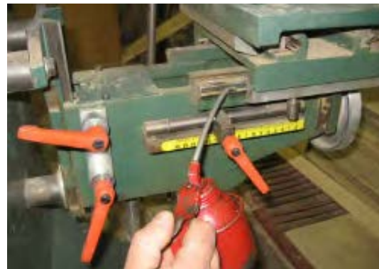
شکل ۱۰-۱- روغن‌کاری (ریل‌ها و کشوهای صفحه‌ی متمرک).
