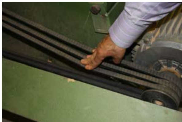
شکل ۱-۲۲-۱- تنظیم سفتی تسمه
