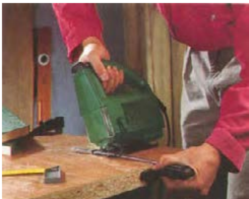
شکل ۱۵-۲۲. نمونه‌ی برش تحت زاویه به کمک گونیا‌ی اره چکشی.
