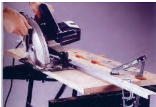
شکل ۱۴-۱۳- برش با استفاده از تکیه‌گاه.
