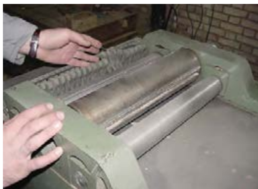
شکل ۷-۲۹- کنترل تمیزی شانه‌ها.
