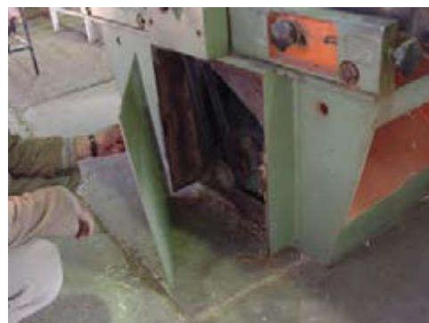
شکل ۶-۹ حفاظ تسمه در جای خود قرار گیرد.
