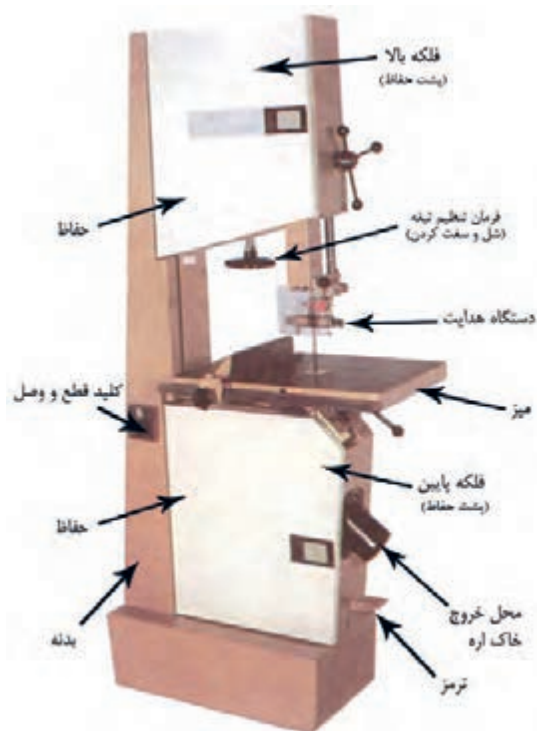
شکل ۱-۴. قسمت‌های مختلف یک ماشین اره نواری.
