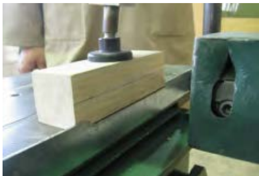
شکل ۹-۱۶- نمونه‌ی قرار دادن چوب (روی صفحه).
