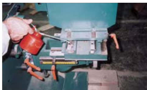
شکل ۲۰-۱۰ - (روغن کاری ریل‌ها).
