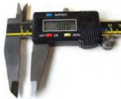
شکل ۱۱-۳۳- کولیس معمولی و دیجیتالی.
