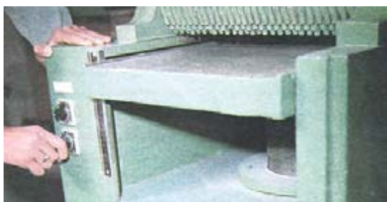
شکل ۷-۳۰- نمونه‌ی ایستادن در هنگام روشن کردن ماشین.
