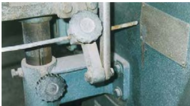
شکل ۹-۸ - سیستم تنظیم عمق کُم.
