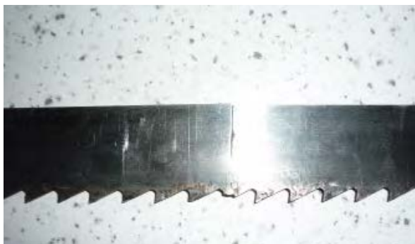
شکل ۷۰-۱- ترک تیغه اره از محل جوش.
