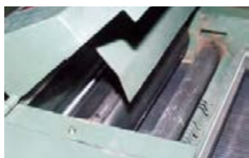
شکل ۲۲-۷. برداشتن درپوش تیغه‌ها.
