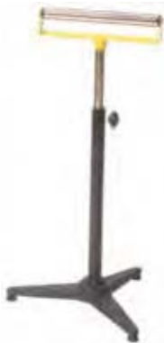
شکل ۱-۳۷- ا- سه پایه‌ای که در پشت اره‌ناری قرار می‌گیرد.
