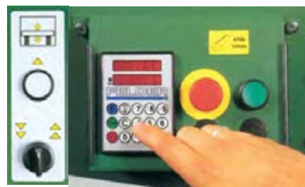
شکل ۷-۲- کلید و راهنمای بالابر اتوماتیک و تنظیم ضخامت با دقت بسیار زیاد.
