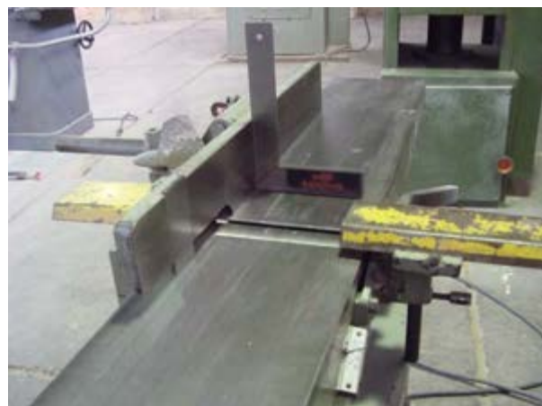
شکل ۳۰-۴- کنترل گونیای ماشین.
