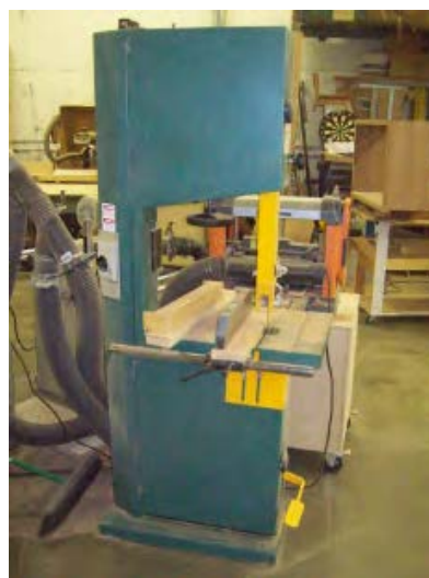
شکل ۹-۱ یک ماشین اره‌نواری، با حفاظ کامل.
