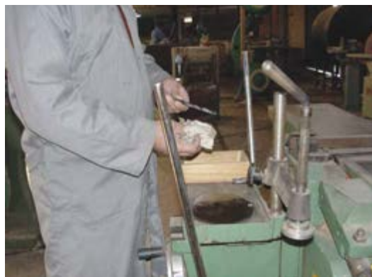
شکل ۱۰-۵- (روغن‌کاری و تمیز کردن مته‌ها).
