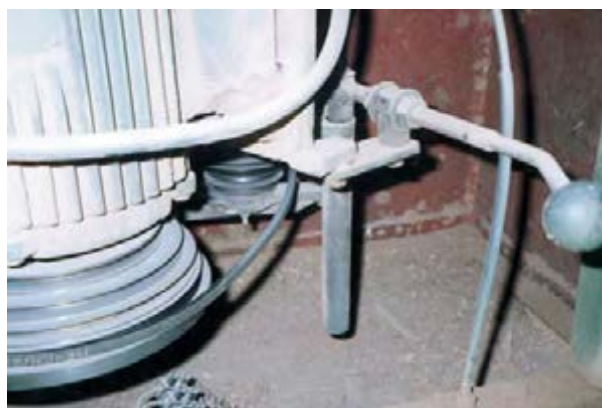
شکل ۱۱-۶- خارج کردن تسمه از پولی.
