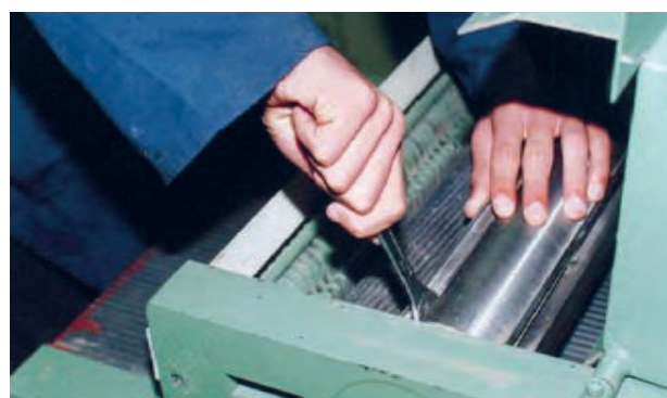
شکل ۲۴-۷. نمونه‌ی بستن تیغه‌ها به توپی.
