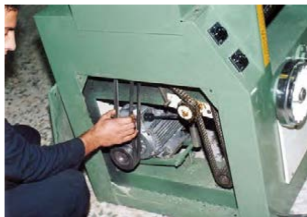
شکل ۸-۸- کنترل مقدار کشش تسمه‌ها.
