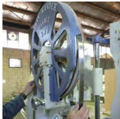
شکل ۱-۲۱-۱- استقرار صمیع تیغه (روی فلکه‌ها) و تنظیم‌های لازم.
