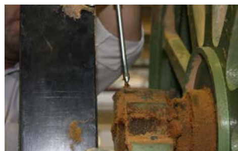
شکل ۳-۱۳. گریس کاری یاتاقان فلکه اره.
