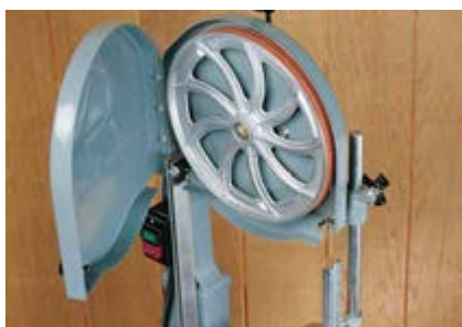
شکل ۴-۲. محافظ باز شده‌ی روی فلکه و تیغه.
