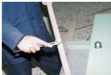
شکل ۴۸-۷- کنترل ضخامت چوب گندگی شده، با کولیس.
