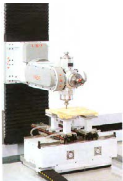
شکل ۸- دستگاه C.N.C برش بر روی چوب.
