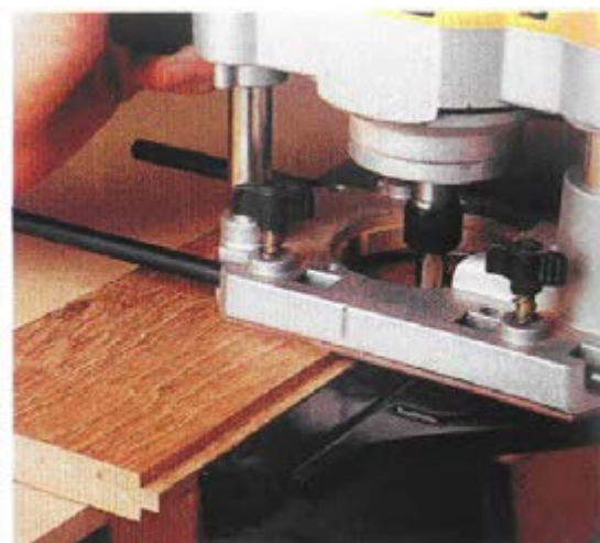
شکل ۱۶-۴. دوراهه زدن، با دستگاه اورفرز.
