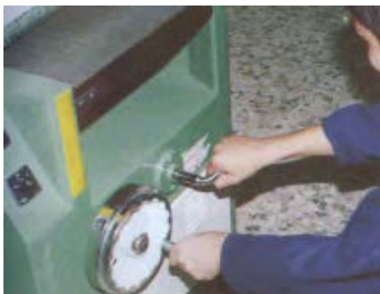
شکل ۷-۵۱- تثبیت بالابر، پس از تعیین اندازه.
