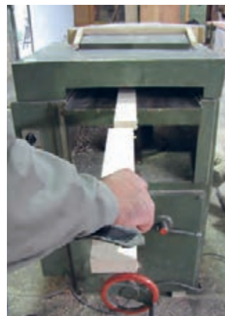
شکل ۷-۳۲- روش صحیح وارد کردن چوب.
