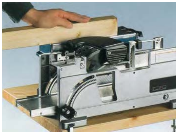
شکل ۱۴-۲۰- کاربرد میز کمکی در موقع رندیدن.
