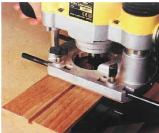
شکل ۱۶-۳. کنشکاف زدن، با دستگاه اور فرز.
