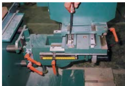
شکل ۲۱-۱۰ - سفت کردن پیچ‌های شل شده.
