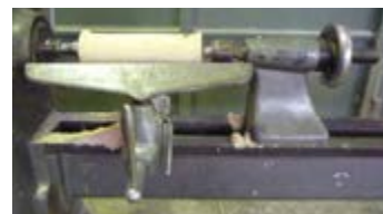
شکل ۱۱-۳۰. تبدیل چوب چهارتراش به استوانه به کمک مغار گلولی.
