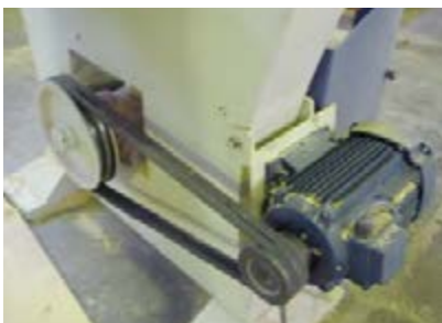
شکل ۳-۴. انتقال نیرو توسط تسمه.
