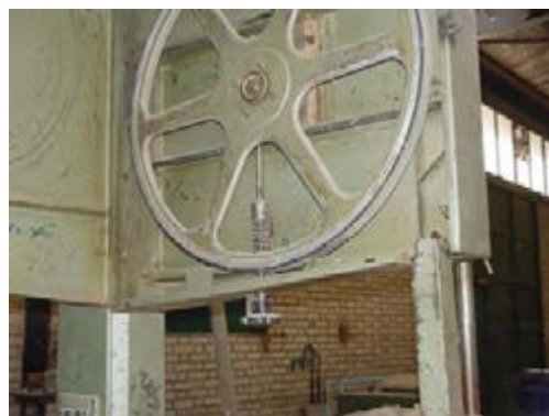
شکل ۱۹-۳. میله ی مارپیچ فلکه، همواره باید تمیز و گریس کاری
