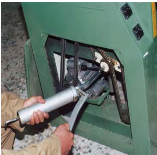
شکل ۸-۷- گریس‌کاری محورهای انتقال نیرو.
