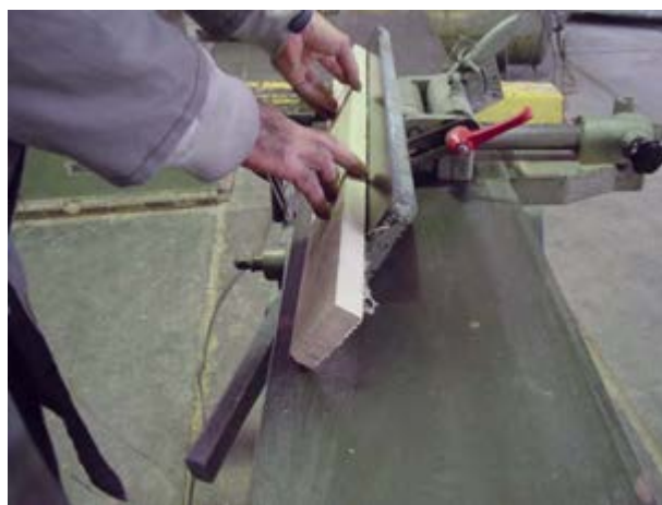
شکل ۴-۳۵. رنده کردن نر چوب با زاویه ۴۵ درجه.
