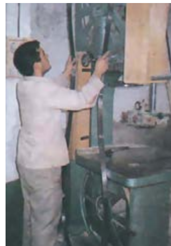
شکل ۱۰-۲. نمونه‌ی فارچ کردن تیغه اره.
