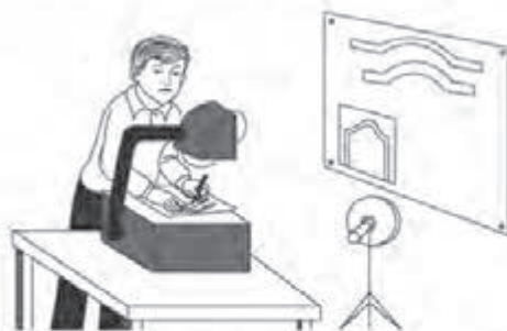
شکل ۱۷-۱۸. نمونه‌ی بزرگنمایی تصویرها با پروژکتور آورده.
