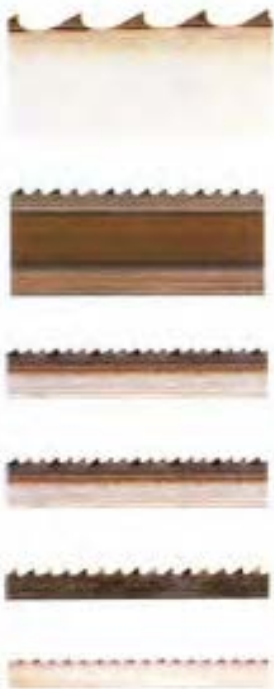
شکل ۱-۴۸-۱. فرم‌های مختلف دندانه‌ی اره‌نواری.
