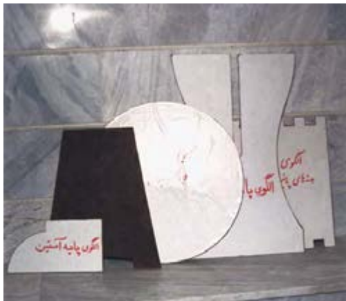
شکل ۳- ۱۸- چند نمونه الگوی آماده شده از مواد مختلف.
