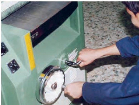
شکل ۷-۳۴- تنظیم مقدار بار گندگی.
