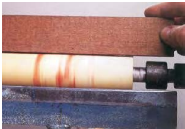
شکل ۱۱-۵۱. کنترل صافی قطعه چوب گرد شده.
