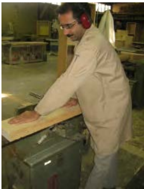
شکل ۴-۲۹- استفاده از گوشه و عینک ایمنی هنگام کار
