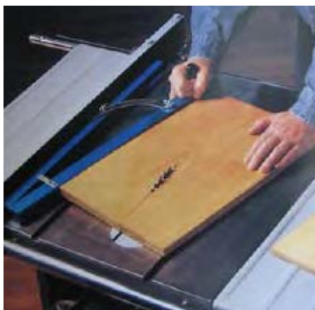
شکل ۱۲-۲۹- برش مورب با ابزار کمکی.
