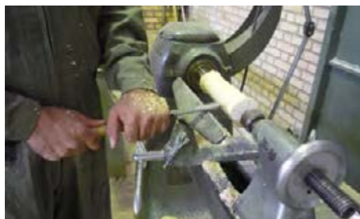
شکل ۱۱-۵۵. نمونه‌ی گرد کردن قطعه چوب پخ (مورده).
