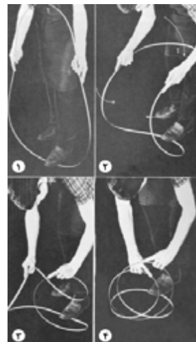
شکل ۷-۳- پی‌گونی جمع کردن تیغه‌ی اره و تبدیل آن به ۳ ملقه.
