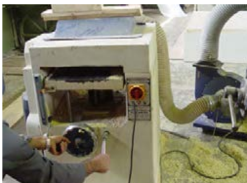
شکل ۷-۴۶- تنظیم بار تیغه به اندازه‌ی مورد نیاز.
