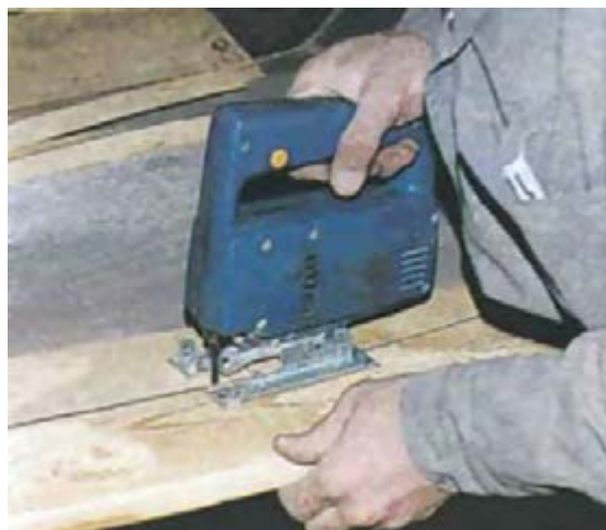
شکل ۱۵-۱۹. برش طولی چوب بدون استفاده از گونیا.
