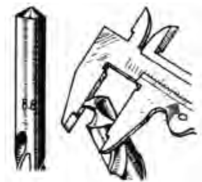
شکل ۱۹-۴۸- اندازه‌گیری قطعه به‌وسیله‌ی کولیس.
