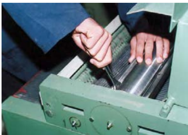
شکل ۸-۹- استفاده از آچار تفت برای باز یا بستن تیغه‌ها.
