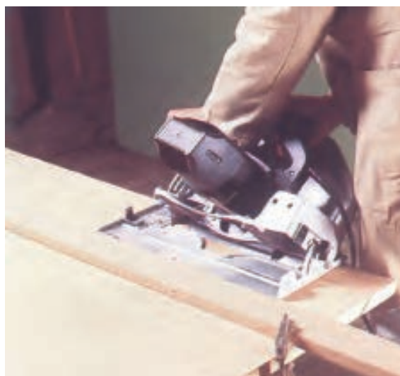
شکل ۱۲-۱۳- صفحه‌ی دستگاه تمت زاویه تنظیم شده است.
