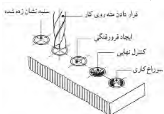
شکل ۱۹-۳۵- مراحل سوراخ کاری.
