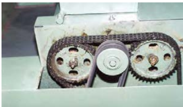
شکل ۱۸-۷. زنجیر انتقال نیرو و قدرت به غلتک‌ها.
