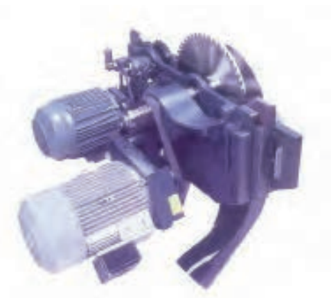
شکل ۱۲-۷- الکتروموتور و سیستم انتقال نیرو.
