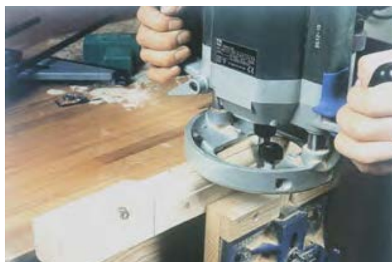
شکل ۱۶-۳۵- فرم دادن لبه‌ی قطعه کار با فرز دستی - برقی.
