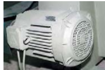
شکل ۵-۱۱- الکتروموتور سه فاز یک ماشین خراطی.
