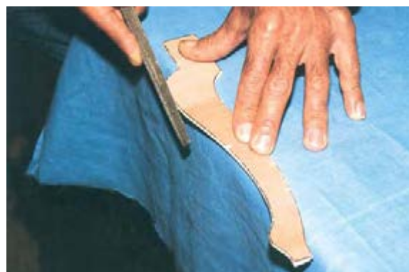
شکل ۱۸-۲۲. نمونه‌ی پرداخت کردن مسیر برش.
