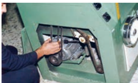
شکل ۲۶-۷. کنترل سفتی تسمه‌ی انتقال نیرو.
