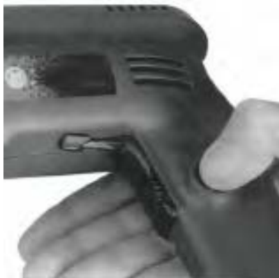
شکل ۱۹-۴۳- (رها کردن کلید و کار دائم دریل.
