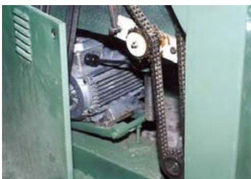
شکل ۸-۱۴- باز کردن درپوش برای روغن کاری.
