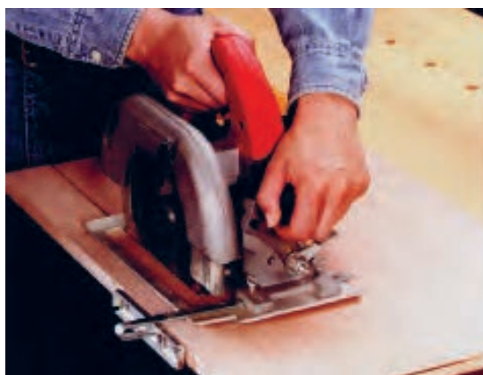
شکل ۱۳-۱۶. برش با استفاده از گونیای ماشین.
