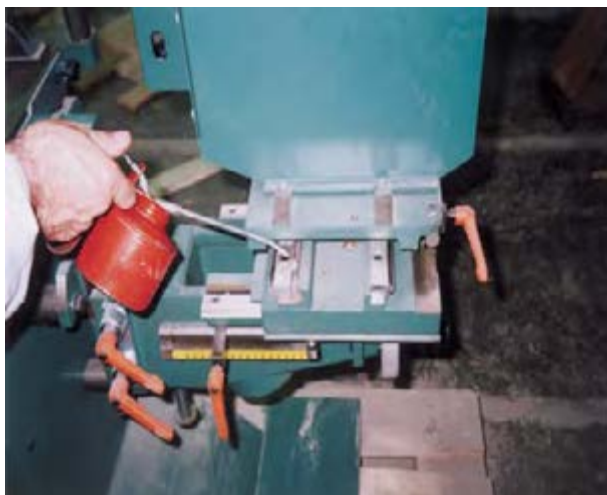
شکل ۱۰-۱۳- (روغن‌کاری) ممل (ریل‌ها).
