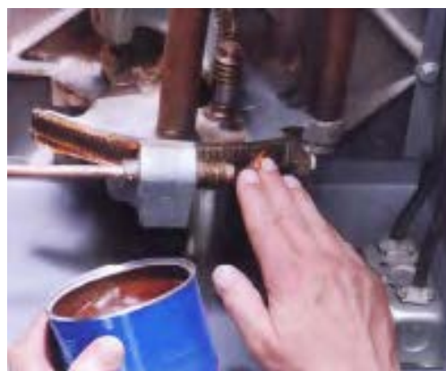
شکل ۱۲-۳۴. گریس‌کاری پیرغ دنده‌ها.
