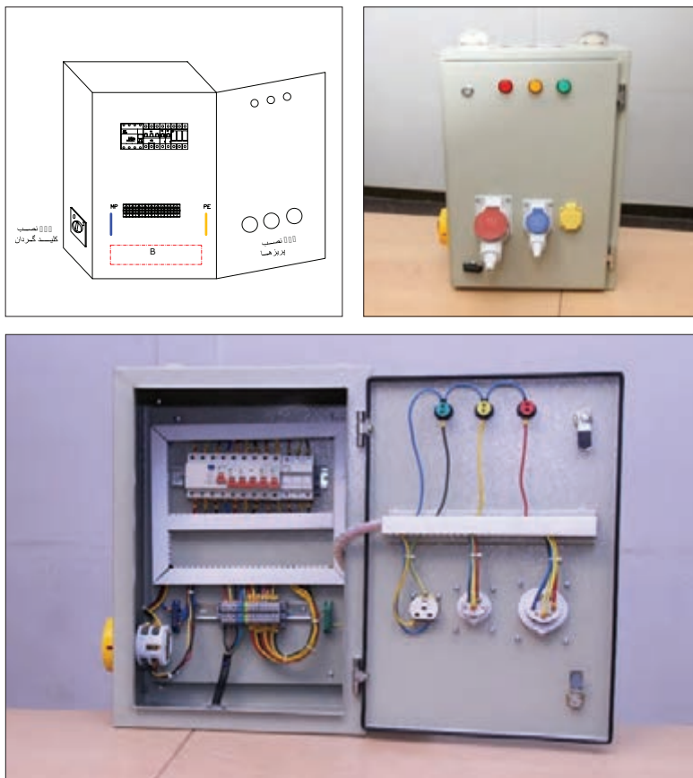
شکل ۵۸- نمای مختلف تابلو توزیع کارگاهی
