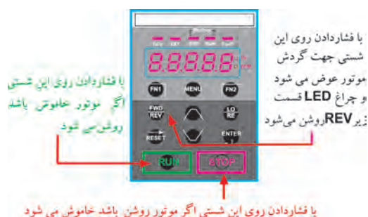
شکل ۲۱- این سه شستی روی اغلب کی پدها برای راه اندازی موتور در حالت Forward و Reverse وجود دارند.
