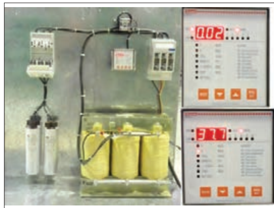
شکل ۱۶- میزان جریان و ضریب توان بار بدون خازن
