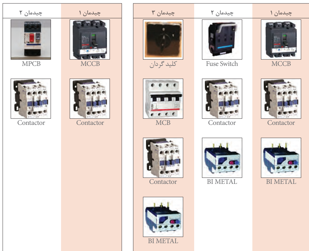
شکل ۱۳- سه مدل چیدمان قطعات در تابلوهای راه انداز (روش دوم)
