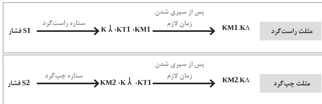
شکل ۲۶- نحوه عملکرد قطعات در مدار فرمان
