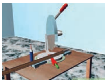
شکل ۷۳- اندازه‌گیری و برش زهوار دور میز عسلی
