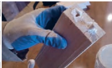
شکل ۳۵- چسب زدن اتصال دوپل
