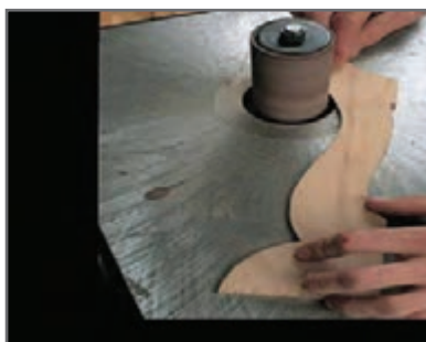
شکل ۳۵- برشکاری و پرداخت پایه جلو مبل یک نفره
