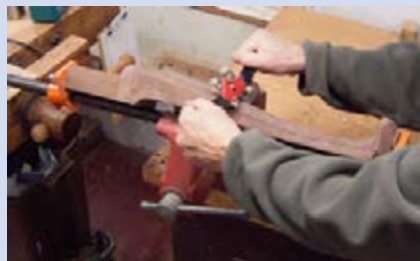
شکل ۵۰- عمل پرداخت کاری با چوب‌ساز، رنده بال کبوتری و سوهان
