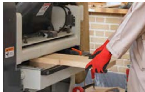
شکل ۷۲- یک ضخامت کردن چوب با دستگاه گندگی (ضخامت گیر) و تمیز کردن دستگاه به وسیله فشار باد
