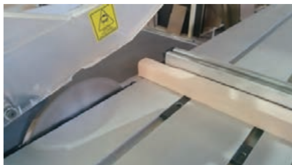
شکل ۳۶- یک اندازه کردن قیدها با دستگاه اره مجموعه‌ای
