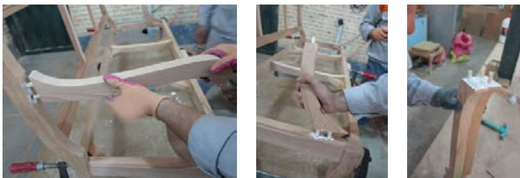
شکل ۶۰- جا زدن دسته مبل در محل اتصالات
