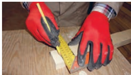
شکل ۸۷- علامت زدن قطعات مختلف برای انجام اتصال
