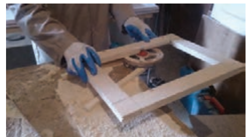
شکل ۲۶- پرداخت با تیغ نیم گرد و به کمک دستگاه اورفرز دستی
