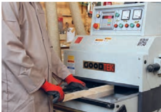
شکل ۷۸- نحوه گندگی کردن چوب‌های کم عرض
