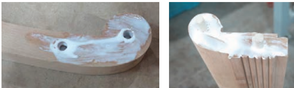
شکل ۴۶- روش چسب زدن اتصال دوبل پایه‌های عقب
