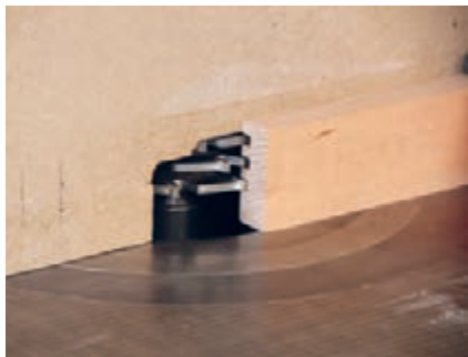
شکل ۶۱- تیغ فرز مخصوص زهوار صفحه
