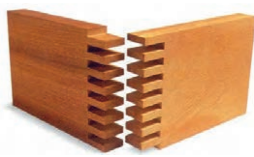
شکل ۱۱- اتصال انگشتی با تعداد زبانه زوج
