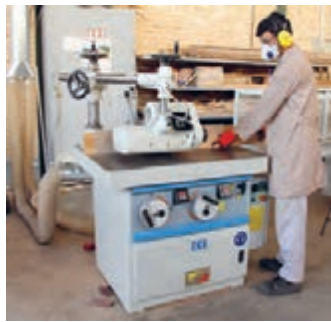
شکل ۶۰- ایجاد اتصال انگشتی با دستگاه فرز میزی و استفاده از دستگاه هدایت
