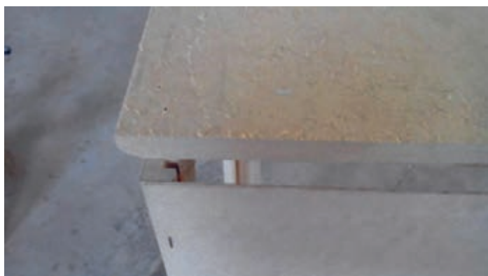
شکل ۷۸- کنترل دوئیدگی ویتترین قبل از پشت کوبی (شیار آینه قابل مشاهده است)
