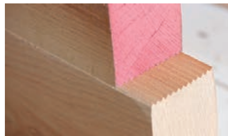
شکل ۱۳- اتصال انگشتی ساخته شده با دستگاه فرز
