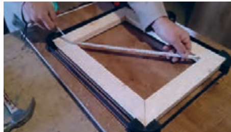
شکل ۲۵- کنترل دوئیدگی و صحیح بودن قاب
