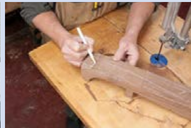
شکل ۴۷- خط‌کشی دوباره روی چوب
