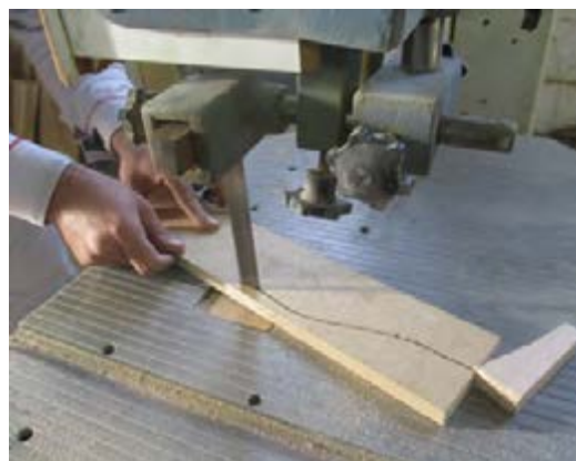
شکل ۶۲- عملیات قوس‌بری با دستگاه اره نواری
