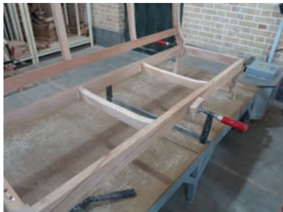
شکل ۵۶- جا زدن اتصالات با گیره دستی
