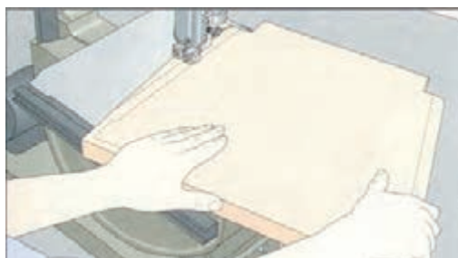
بریدن کفی توسط دستگاه اره نواری
