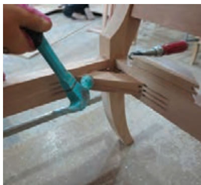
شکل ۵۸- جا زدن نبشی‌های گوشه
