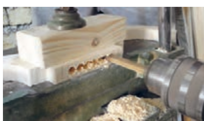
شکل ۸۸- عملیات کم کنی با دستگاه سه کاره
