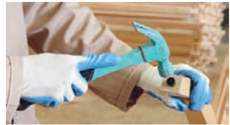
شکل ۱۱۳- نصب پایه پلاستیکی کف پایه با چکش فلزی
