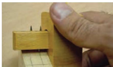
شکل ۱۹- اندازه‌گذاری و خط‌کشی اتصال فاق و زبانه دو رو فارسی
