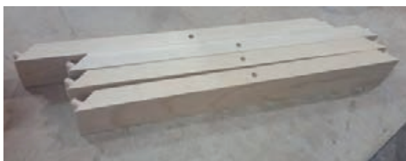
شکل ۶۲- قطعات آماده برای مونتاژ میز عسلی
