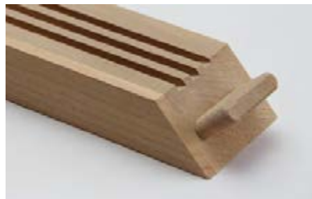
شکل ۹- اتصال زبانه زاویه دار
