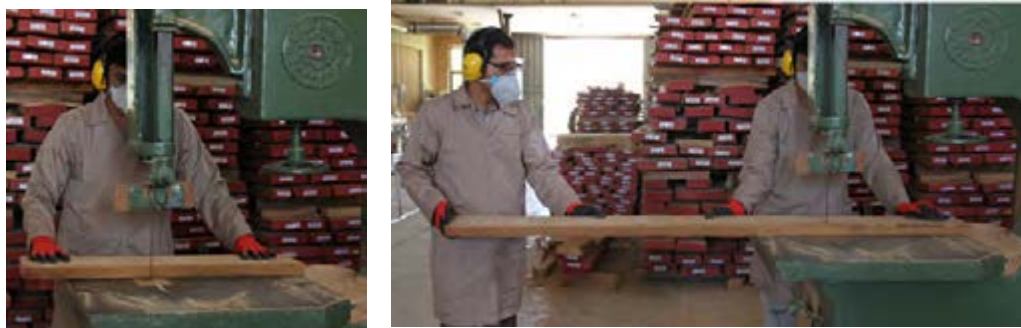
شکل ۶۹- برش عرضی قطعات بزرگ با استفاده از فرد کمکی و برش عرضی قطعات کوچک
