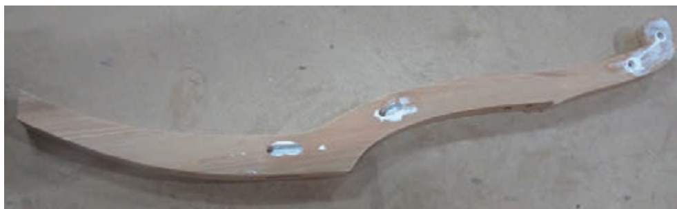
شکل ۴۶- روش چسب زدن اتصال دوبل پایه‌های عقب
