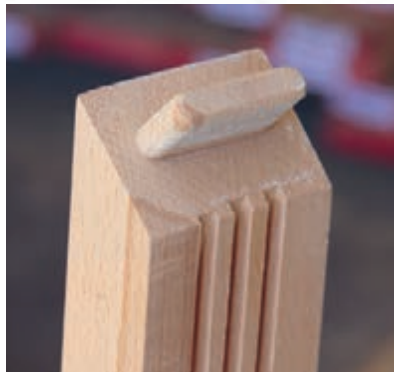
شکل ۵۹- اتصال کام تحت زاویه ۴۵ درجه
