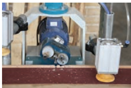
شکل ۳۸- ایجاد اتصال با دستگاه دوبل زن نیمه‌اتوماتیک
