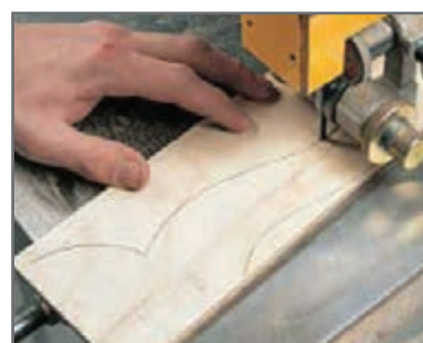
شکل ۳۵- برشکاری و پرداخت پایه جلو مبل یک نفره
