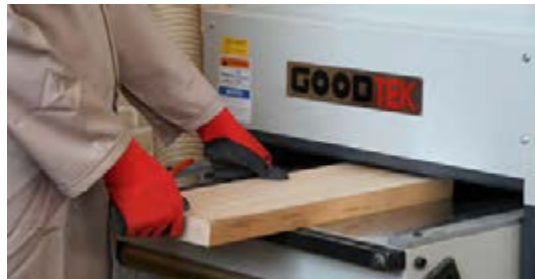
شکل ۷۱- یک ضخامت کردن چوب با دستگاه گندگی (ضخامت گیر)
