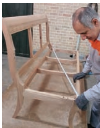
شکل ۵۷- کنترل دوئیدگی (گونیا)ی کردن کار) با متر
