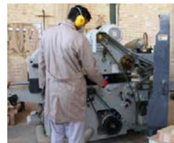
شکل ۷۲- یک ضخامت کردن چوب با دستگاه گندگی (ضخامت گیر) و تمیز کردن دستگاه به وسیله فشار باد
