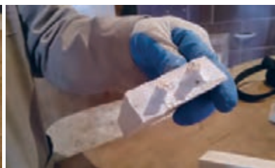
شکل ۳۶- چسب زدن سطح قیدها و جا زدن میخ چوبی در محل اتصال
