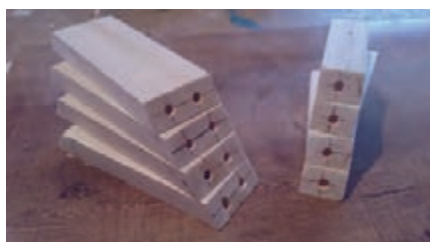
شکل ۳۳- سوراخ کردن قیدها تحت زاویه
