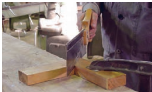
شکل ۲۱- چگونگی اره‌کشی درز بین اتصال
