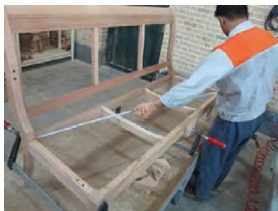
شکل ۵۷- کنترل دوئیدگی (گونیا)ی کردن کار) با متر
