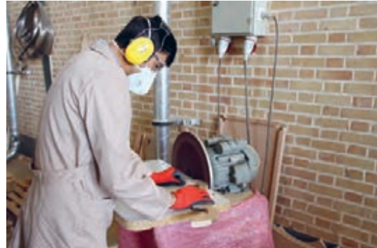
شکل ۸۶- عمل پرداخت قسمت خارجی تاج با سنباده دیسکی
