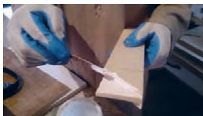
شکل ۲۳- چسب زدن اتصالات قاب
