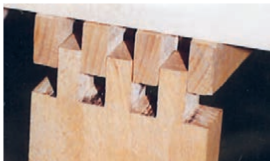
شکل ۱۲- اتصال انگشتی با تعداد زبانه فرد
