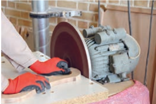
شکل ۸۶- عمل پرداخت قسمت خارجی تاج با سنباده دیسکی
