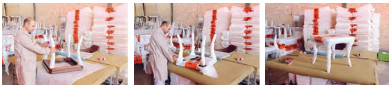
شکل ۷۶- مراحل مختلف بسته بندی و آماده کردن محصول به منظور ارسال به مشتری
