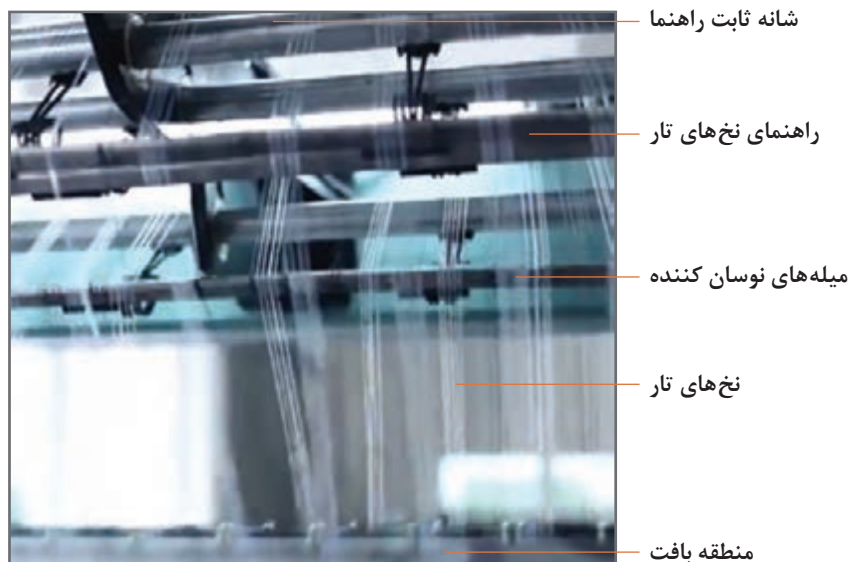
مسیر ۲۸- حرکت نخ از شانه ثابت راهنما تا منطقه بافت
