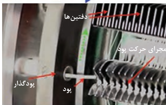
شکل ۳۴- بخش پودگذاری موازي ماشین بافندگی چند فازي ایرجت
