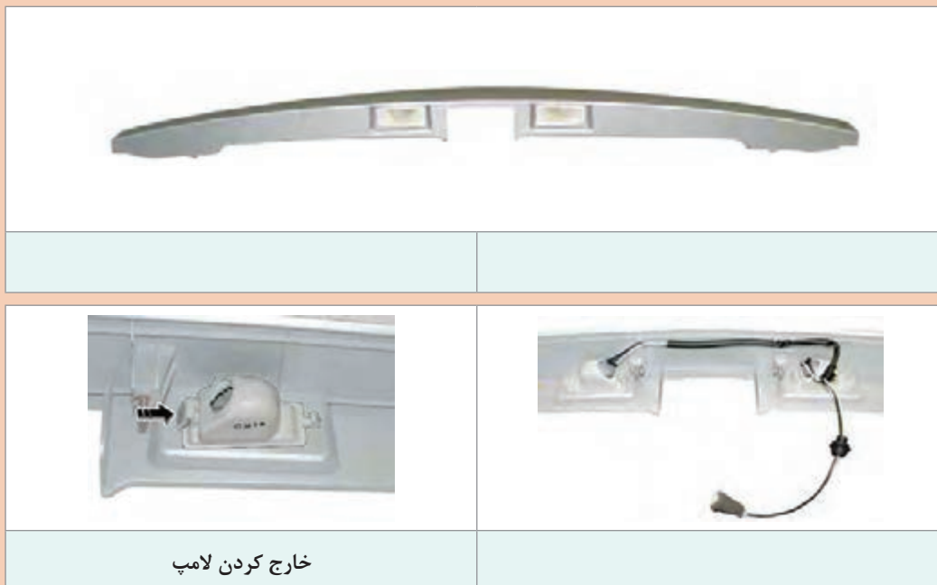
شکل ۳۵- روش باز کردن و بستن چراغ پلاک
