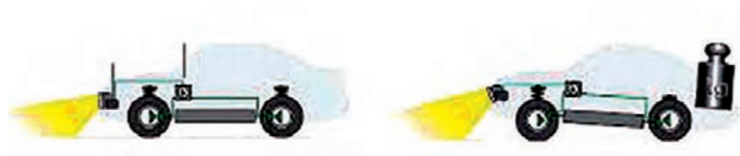
شکل ۹- دلیل نیاز به سیستم تنظیم ارتفاع چراغ
