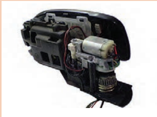
شکل ۱۵- دو نمونه از موتور مخصوص آیینه تاشونده الکتریکی
