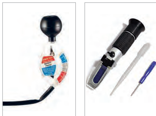
هیدرومتر، اندازه گیری جرم حجمی الکترولیت رفلکتومتر، اندازه گیری جرم حجمی الکترولیت
