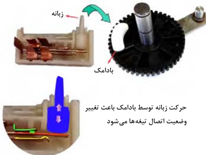
شکل ۸- کلید پارک از نوع پلاتین و بادامک
