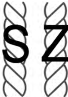
شکل ۲۳- جهت تاب در نخ‌های ماهیگیری و انواع طناب‌ها.
