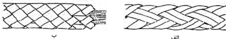
شکل ۲۵- ساختار نخ های بافته شده. الف) گیس باف ب) لوله ای با مغزه
