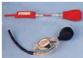
شکل ۷-۳- دو نوع هیدرومتر یا چگالی سنج
