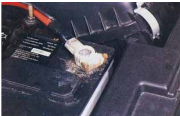
شکل ۶-۲- سولفاته شدن قطب باتری
