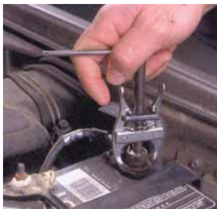
شکل ۱۲-۱۰- مورد استفاده‌ی آچار بست باتری
