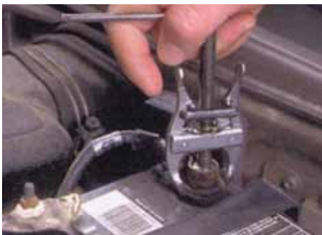
شکل ۹-۵- جدا کردن بست قطب منفی
