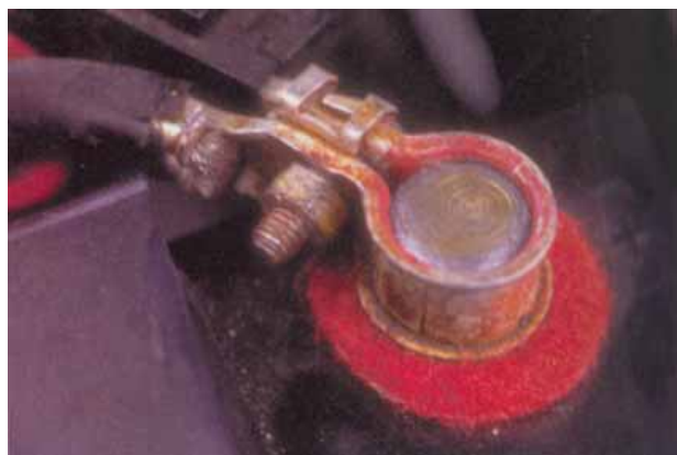
شکل ۶-۲۵- گریس زدن بست قطب‌ها
