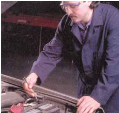
شکل ۸-۵- شل کردن قطب منفی باتری
