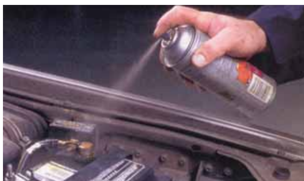
شکل ۶-۲۴- پاشیدن محلول ضدخوردگی روی بست
