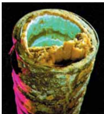
شکل ۳-۸- لایه‌ی آهکی ایجاد شده درون لوله
