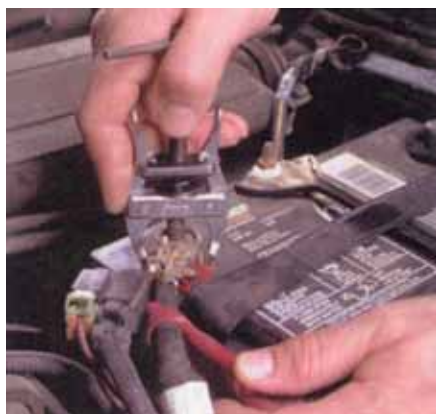
شکل ۵-۱۱- جدا کردن بست قطب مثبت
