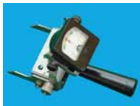
ولت متر دو شاخه ای جهت تست باتری
