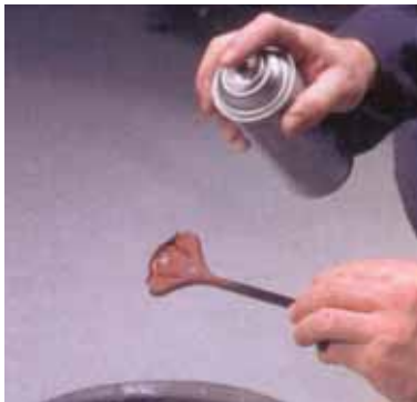
شکل ۲۱-۶ اسپری ضد خوردگی روی بست نگهدارنده ی باتری
