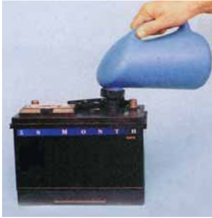
شکل ۷-۴- افزودن آب مقطر به باتری
