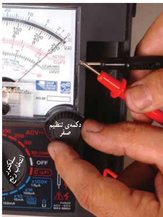
شکل ۳۹-۱- تنظیم صفر در اهم‌متر
