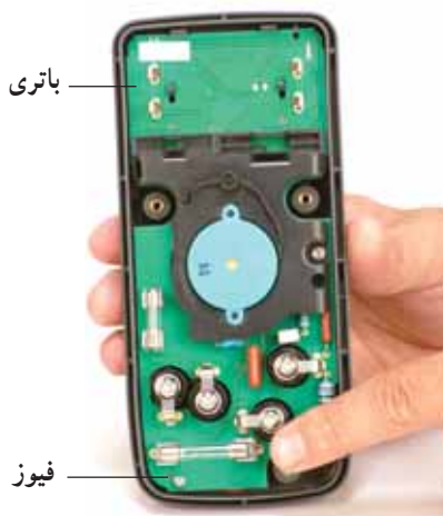
شکل ۱-۵۱- فیوزها و باتری مولتی‌متر دیجیتالی
