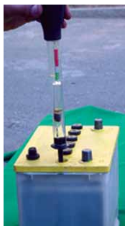
شکل ۵-۱۸- غلظت الکترولیت در باتری کاملاً شارژ شده
