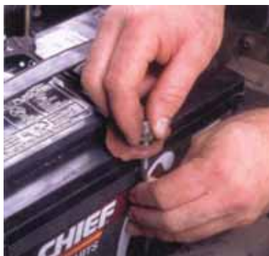
شکل ۲۲-۶ بستن باتری روی خودرو
