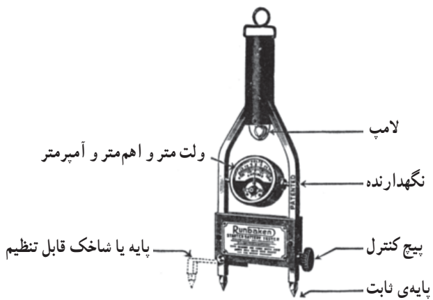
شکل ۲۷-۵- یک نوع تستر باتری
