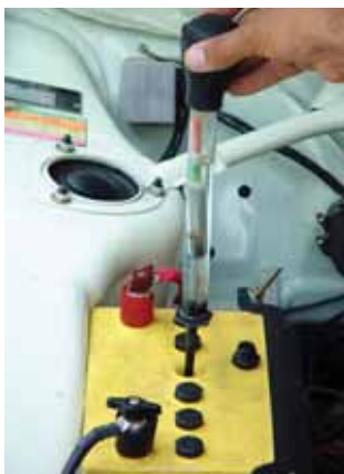
شکل ۵-۱۷- اندازه‌گیری غلظت الکترولیت
