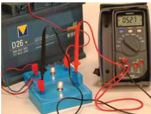
شکل ۱-۴۷- اندازه‌گیری ولتاژ با مولتی متر
