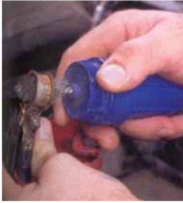
شکل ۱۹-۶ پاک کردن بست های باتری با برس سیمی
