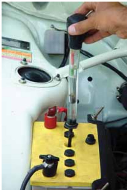
شکل ۷-۵- اندازه‌گیری غلظت الکترولیت
