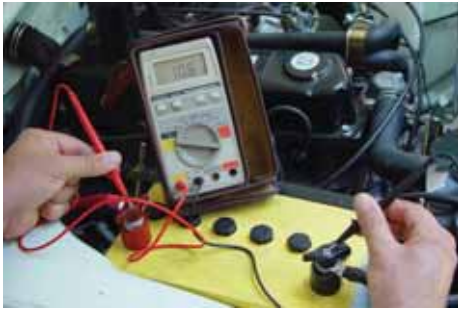
شکل ۳-۵- اندازه‌گیری ولتاژ تحت بار باتری
