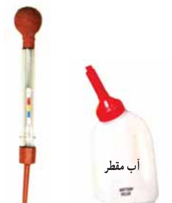
شکل ۱۴-۲- هیدرومتر (اسیدسنج) و ظرف محتوی آب مقطر
