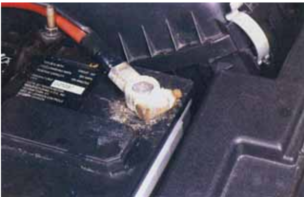
شکل ۶-۹ – سولفات شده شدن قطب باتری
