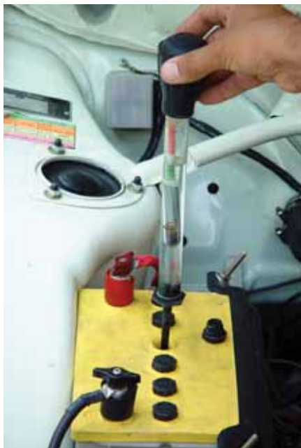
شکل ۴-۶ در حالت رقیق بودن الکترولیت شناور پایین رفته و در حالت غلیظ بودن الکترولیت شناور بالاتر می‌آید.
