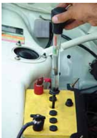
شکل ۵-۱۹- غلظت الکترولیت در باتری دشارژ شده
