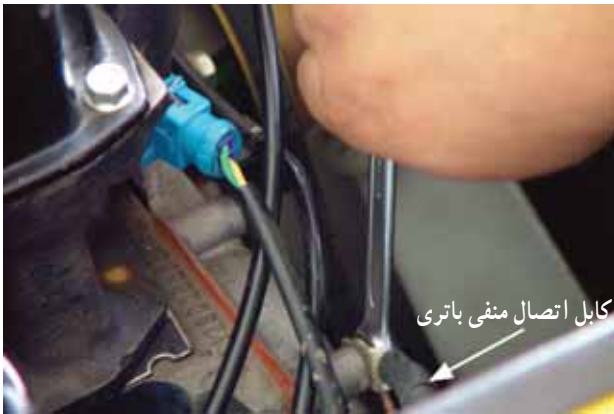
شکل ۱-۲ بستن اتصال منفی به سینی جلو
