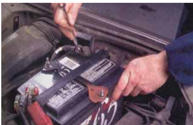
شکل ۶-۲۳- اتصال کابل‌های مثبت و منفی باتری
