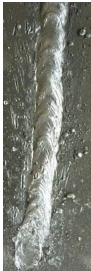
شکل ۵-۱۰ پاشش ذرات مذاب بر روی کار
