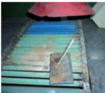
شکل ۴-۸، الکتروود چسبیده به قطعه کار
