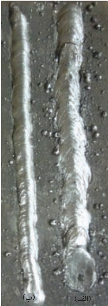
الف) خط جوش با آمپر بالاتر ب) خط جوش با آمپر پایین تر شکل ۹-۵
