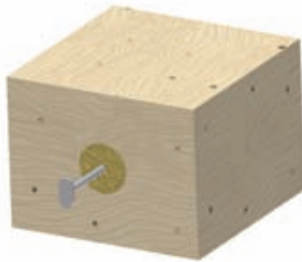
شکل ۶-۱۴- ایجاد مجرای خروج گاز با مفتول
