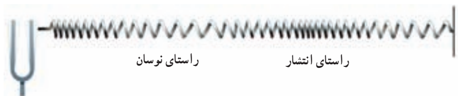
شکل ۱۰-۴- انتشار موج طولی در فنر
