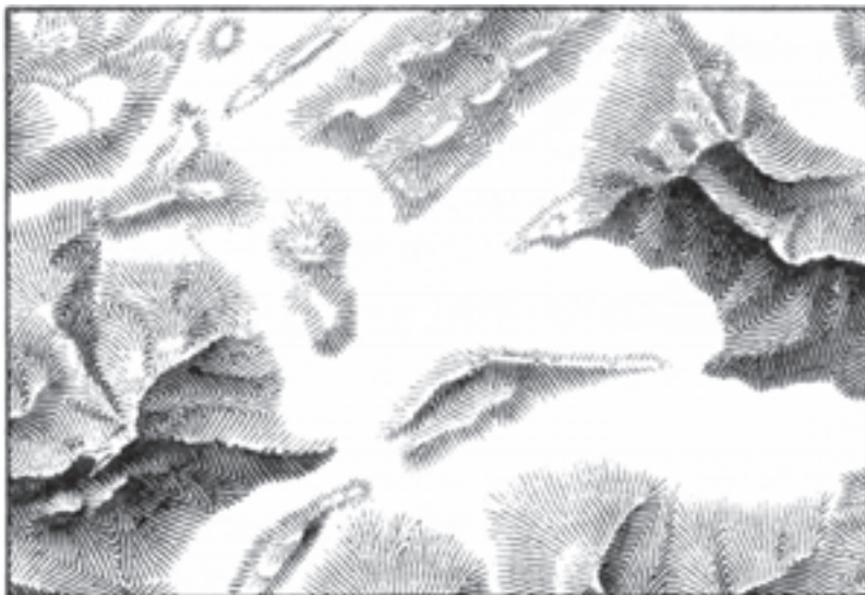
شکل ۱۲— نورپردازی و استفاده از هاشور برای نمایش دادن ارتفاعات در نقشه
