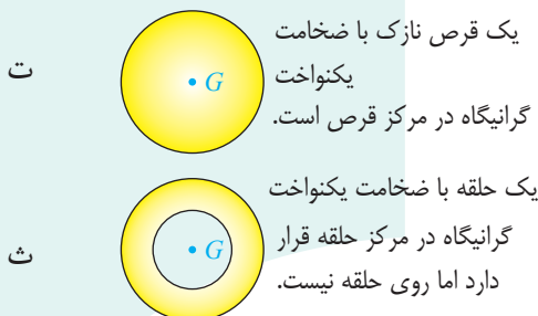
شکل ۱۴-۴ گرانیگاه چند جسم با شکل منظم که ماده ی تشکیل دهنده ی آن ها به طور یکنواخت توزیع شده است.
