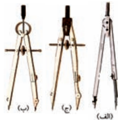
شکل ۱-۸ (الف) پرگار بازویی، (ب) پرگار فنری، (ج) پرگار پیچی
