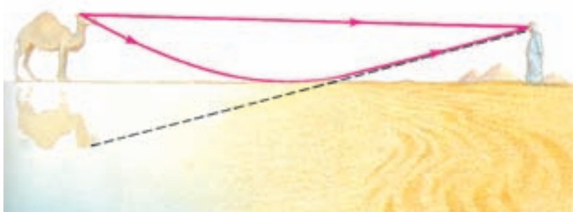
شکل ۵-۱۳- سراب و علت به وجود آمدن آن
