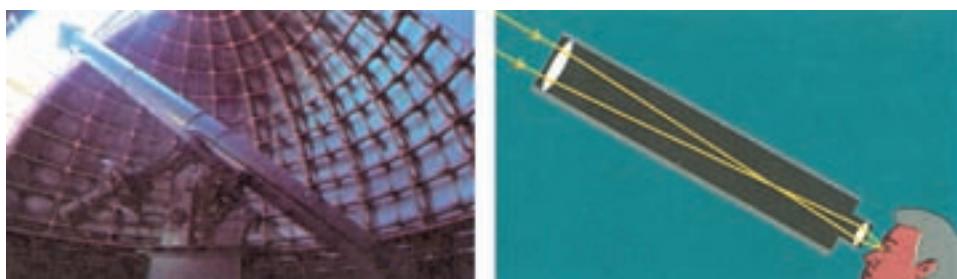
شکل ۵-۴۷- طرز تشکیل تصویر در دوربین نجومی
