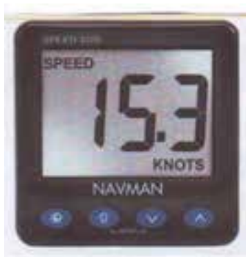
شکل ۲-۳ - سرعت سنج کشتی نیز فقط سرعت کشتی در واحد زمان را که یک کمیت اسکالر است نشان می‌دهد
