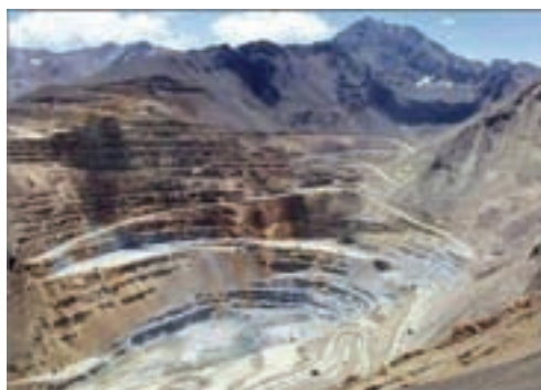
شکل ۱-۱ استخراج معدن به روش پلکانی روباز
