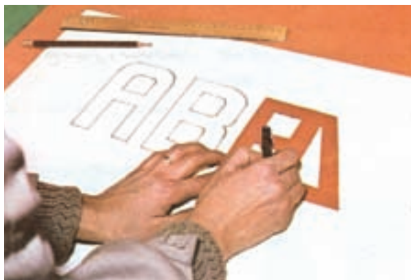
شکل ۳-۱۱ - استفاده از شابلون (قالب)
