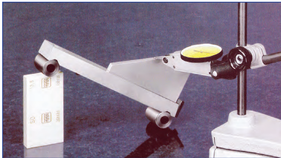
شکل ۱۶-۷. اندازه‌گیری زاویه به کمک خطکش سینوسی
