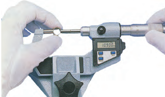
شکل ۳۱-۵ اندازه‌گیری به وسیله میکرومتر دیجیتالی
