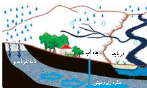
شکل ۴۴-۱- چگونگی شکل‌گیری سفره‌های آب زیرزمینی
