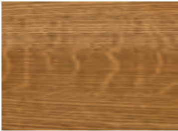
شکل ۲۴-۲- طول پره چوبی (پره مگس) در پهنای برش شعاعی در چوب بلوط
