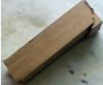
شکل ۱۰-۶، تغییر شکل دائمی ایجاد شده در چوب راش پس از آزمایش فشار موازی الیاف
