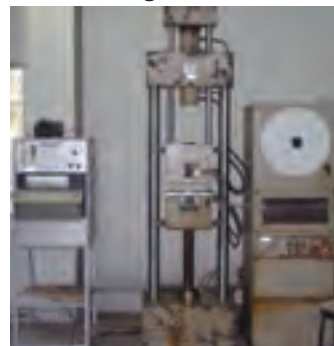
شکل ۱۵-۶- دستگاه کشش و فشار با سیستم مکانیکی (انواع قدیمی‌تر) را نشان می‌دهد. ترسیم گراف و تنظیم دستگاه به وسیله ادوات مکانیکی و بدون استفاده از کامپیوتر است.
