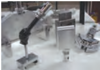
شکل ۱۲-۶- تعدادی از گیره‌های مورد استفاده برای آزمایش چوب و چند سازه‌های چوبی
