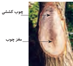
شکل ۴۱-۱- انشعاب شاخه از تنه در پهن برگان و ایجاد چوب کششی در قسمت بالا
