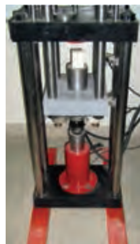
شکل ۱۴-۶- دستگاه کشش و فشار هیدرولیکی، ظرفیت این دستگاه حدود ۱۵ تن بوده و حرکت آن به وسیله جک هیدرولیک ایجاد می‌شود بخش فوقانی جک هیدرولیک که با فلش نشان داده شده است نیرو سنج می‌باشد.
