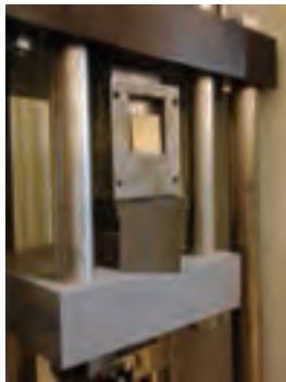
شکل ۱-۲ (پ)، نمونه در حال انجام آزمایش برش موازی الیاف
