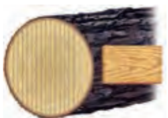
شکل ۱۳-۱ - برش مماسی از تبدیل گرده بینه
