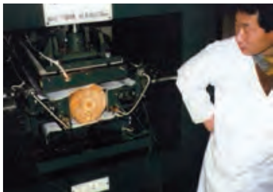
شکل ۲-۵ و ۳-۵ نشان دهنده پرس چوب طبیعی (ماسیو) برای کاهش حجم و افزایش جرم مخصوص در آزمایشگاه
