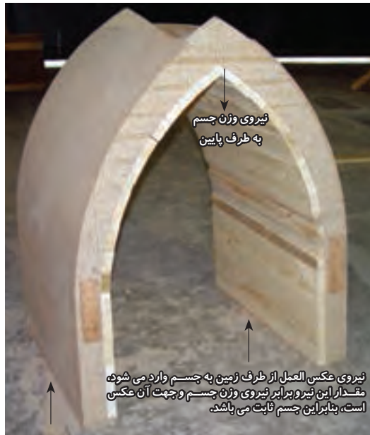
شکل ۱-۶ (الف) نیرویی برابر وزن این مدل از طرف زمین به آن وارد می‌شود. بنابراین جسم ساکن می‌باشد.
