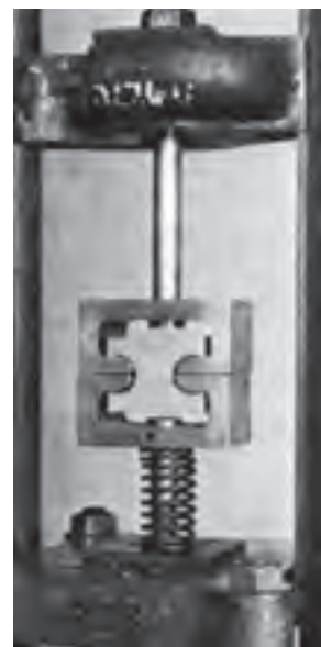
شکل ۳-۸ ب) نمونه آزمایش کشش عمود بر الیاف در حال آزمایش
