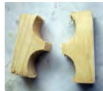
شکل ۳-۸ ج) نمونه آزمایش کشش عمود بر الیاف پس از شکسته شدن.
