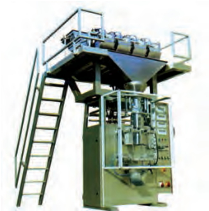
شکل ۲-۸ - ماشین بسته‌بندی برنج، چای، خشکبار، چیپس، تافی، آبنبات، بیسکویت و غیره
