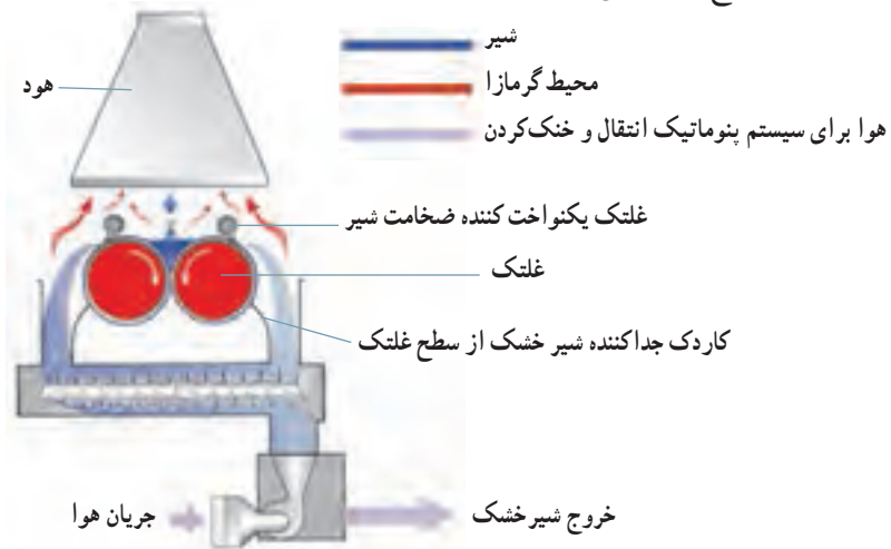
شکل ۱۳-۳- اصول کار در خشک‌کن غلتکی با تغذیه ریزشی
