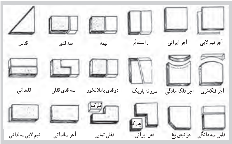
۱۳-۶- اجزای آجر و انواع تراش‌های روی آن
