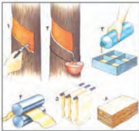
شکل ۱۴-۱- نحوه‌ی تهیه لاستیک طبیعی
