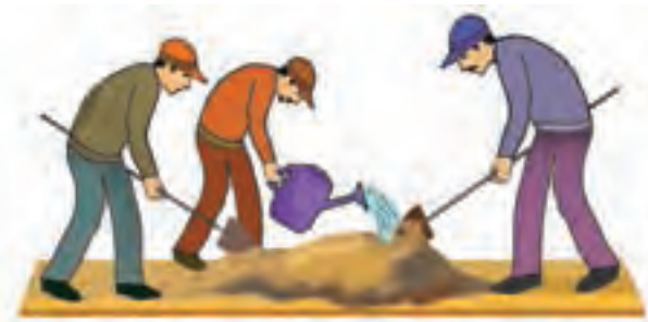
شکل ۳-۷- سرن‌کردن ماسه و مخلوط کردن ملات
