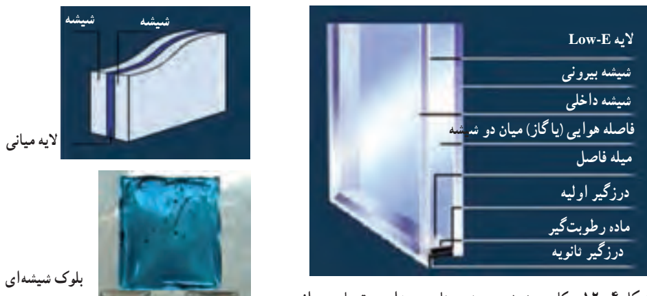
شکل ۴-۱۲- کاربرد شیشه در پنجره‌های دو جداره و تصاویری از شیشه جام لایه‌دار و بلوک شیشه‌ای
