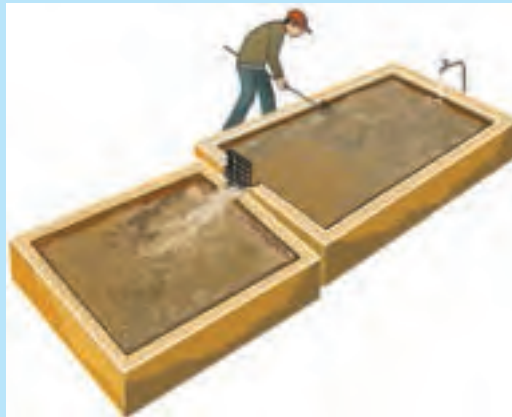
تهیه‌ی آهک شکفته به روش تر (دوغابی)
