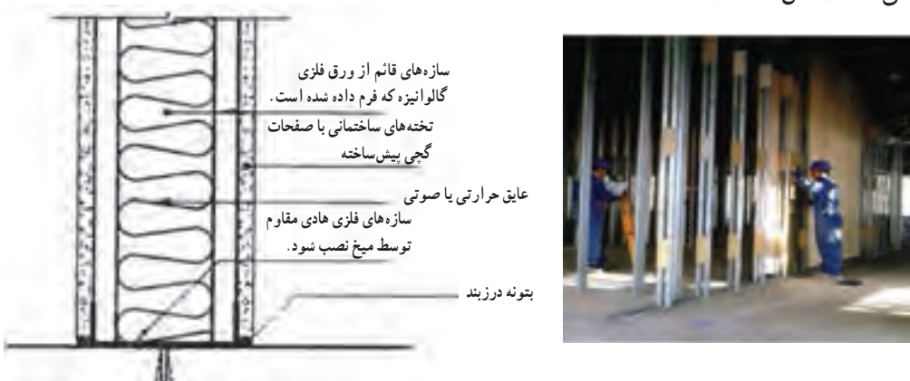
شکل ۴-۱۵- جزئیات دیوار مرکب با پوشش صفحات گچی و نحوه ی اجرای آن
