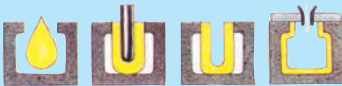
تکه‌ی شیشه داغ سمبده‌ی شکل دهنده خروج سمبه دمیدن هوا
