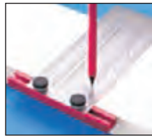
شکل ۱-۳۴ قرقره‌های متصل کننده‌ی خط کش به میز
