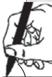
شکل ۳-۱۳ زاویه ی قلم کمتر از ۸۰ درجه نباشد.
