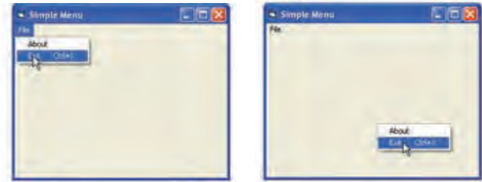
شکل ۲-۱۲. هنگامی که از متد PopUpMenu استفاده می‌کنید، فقط گزینه‌های منو ظاهر خواهند شد.
