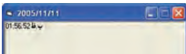
شکل ۳-۶- تنظیم مشخصه MaxButton با مقدار False دکمه به حداکثرسانی را غیرفعال می‌کند.
