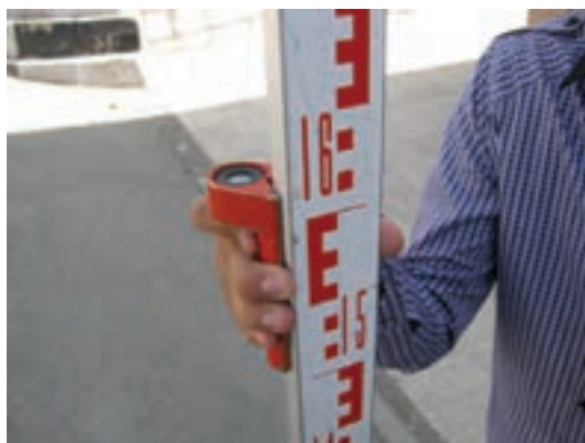
شکل ۱۱ - ۱۰. نگه داشتن صحیح میر یا شاخص
