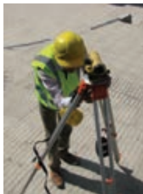
شکل ۱۱ - ۹. تراز کردن دوربین ترازباب
