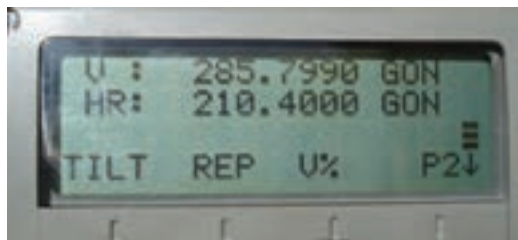
▲ شکل ۲-۱- صفحه نمایش زاویه افقی و قائم
