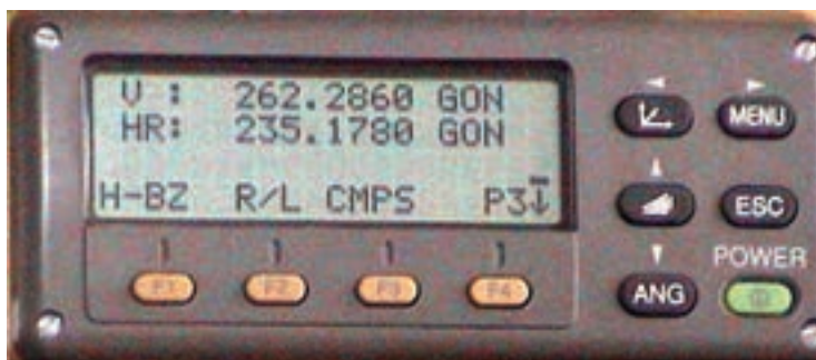
▲ شکل ۶-۷- صفحه سوم منوی زاویه در توتال استیشن تاپکن سری GTS-۲۲۰
