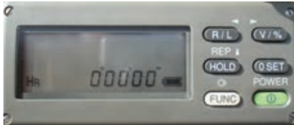
▲ شکل ۲-۵- نمایش زاویه افقی
