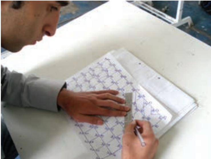
▲ شکل ۱-۹- ترسیم منحنی‌های میزان بر روی کاغذ
