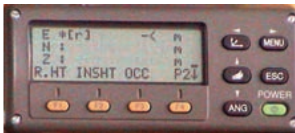
▲ شکل ۶-۱۱- صفحه دوم منوی نمایش مختصات در توتال استیشن تاپکن سری GTS-۲۲۰
