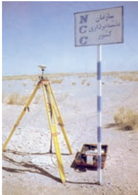
شکل ۱۱-۷- یک نقطه‌ی ترازیبی به نام AQAR1086 در منطقه‌ی امام‌زاده هاشم را نشان می‌دهد که دستگاه GPS روی آن مستقر شده است.
