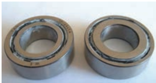
شکل ۱-۴- نمونه‌ای از اثرات مرکب‌های مخصوص نوشتن روی سطح آهنی بلبرینگ
