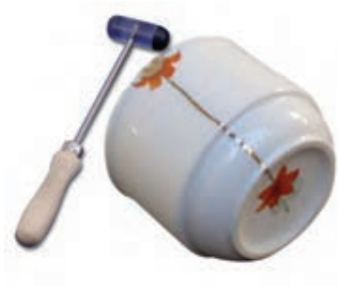
شکل ۴-۲- یکی از روش‌های ساده برای کنترل ترک‌خوردگی در ظروف چینی (استفاده از چکش لاستیکی مخصوص)
