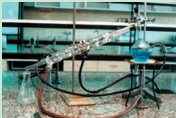
شکل ۱-۸- دستگاه معمولی تقطیر ساده
