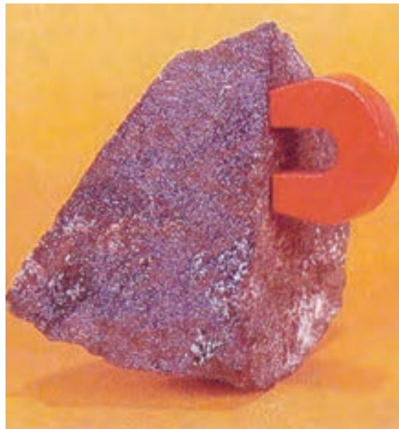
شکل ۵-۷ کاتالیزگر آمونیاک متشکل از کانی حاوی آهن‌اکسید
