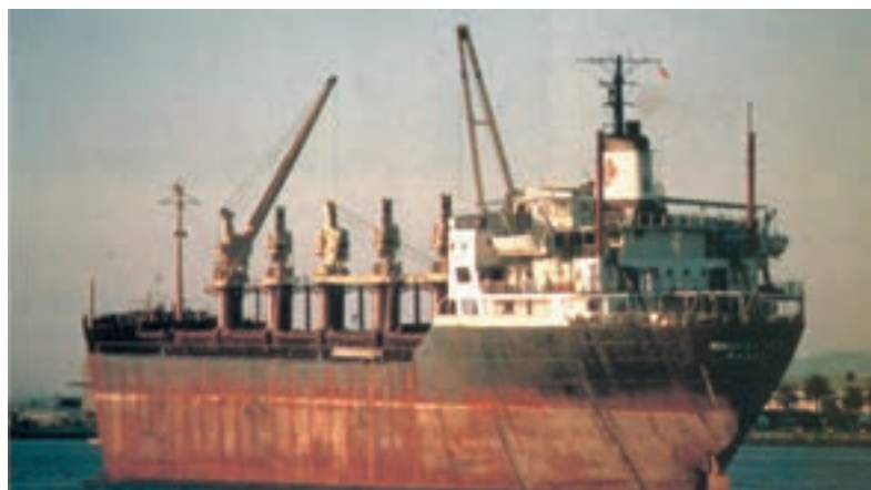
زنگ زدگی در یک کشتی
