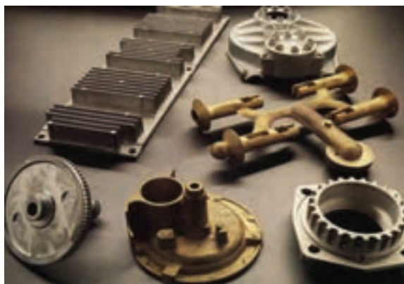
شکل ۳-۷- قطعات ریخته گری تحت فشار روی
