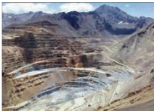
شکل ۱-۱ استخراج معدن به روش پلکانی روباز
