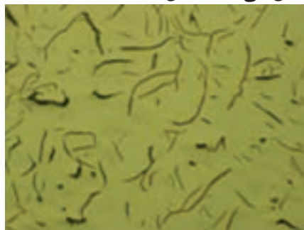
شکل ۳-۴- هرچه لایه‌های گرافیت بیشتر و ضخیم‌تر باشند، استحکام چدن کاهش می‌یابد. استحکام چدن (ب) از (الف) کمتر است.
