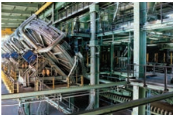
شکل ۵-۲- دیسکهای گندله سازی وظیفه تولید گندله خام (Pellet Green) و یا شکل دهی کروی گندله را به عهده دارند. تعداد ۸ عدد دیسک در دو ردیف چهارتایی هر یک به قطر ۷/۵ متر در شرکت فولاد مبارکه وجود دارد.
